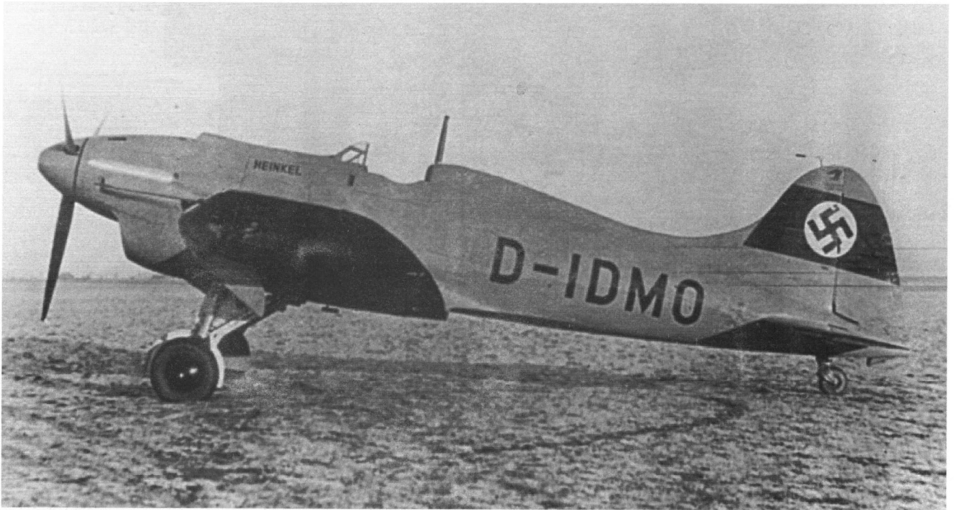
Die für 3 MG 17 (7,92 mm) ausgelegte He 112 V3 D-IDMO. Das Flugzeug war im März 1937 als für "Sonderraum Künzel" (Raketenantriebsversuche) geliefert gemeldet.
