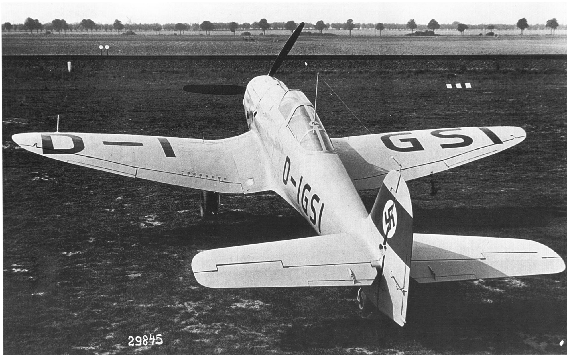
He 112 V9 D-IGSI. Es ist zu erkennen, daß die Kanzel im Gegensatz zur späteren B-Serie im Windabflußbereich eine Längs- und Querverstrebung aufweist.
