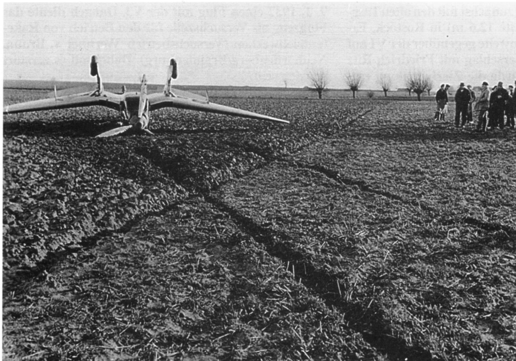
Notlandung der He 112 V2 durch Friedrich Ritz Anfang Februar 1936 wegen falscher Tankschaltung (Einbaufehler). Man sieht genau, daß der weiche Acker ein glattes Ausrollen verhinderte - die Maschine überschlug sich.
