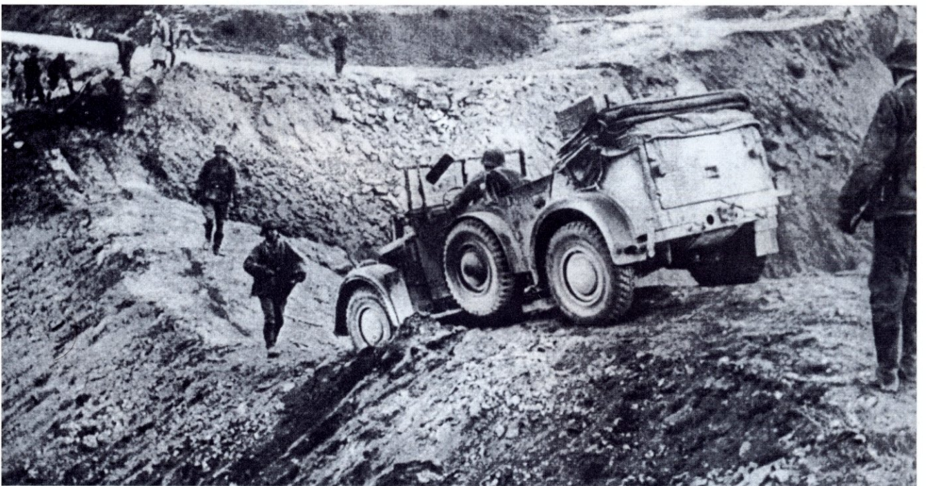
Die einzige Möglichkeit, den deutschen Vormarsch in Griechenland zu stoppen, sahen die Engländer in der Sprengung wichtiger Straßen. Das Bild zeigt, wie vorteilhaft die seitlichen Stützräder im schweren Gelände sein konnten.
