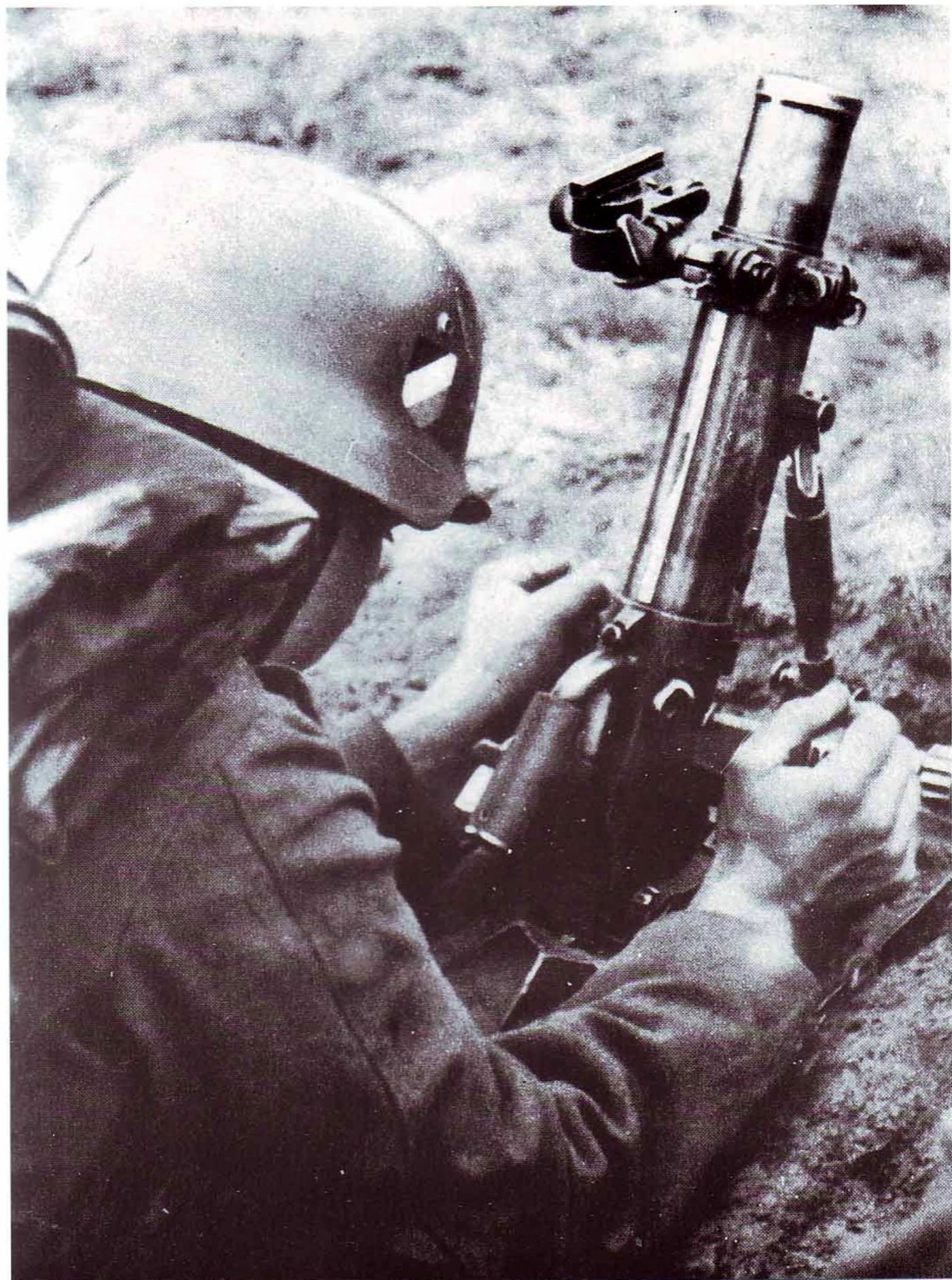
Ein leichter Granatwerfer 36 in Feuerstellung. Der Schütze 1 nimmt, nachdem der Werfer grob eingefluchtet wurde, mittels Seitenrichttrieb die Feinrichtung nach der Seite und mit Hilfe des Gradbogens und des Höhenrichttriebes die Erhöhung vor.
