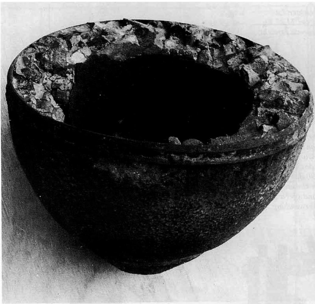
Aufgesprengter Kopf einer 21-cm Wurfgranate 5021 (Splitterbeton). Gut zu erkennen ist die Struktur der mit Splintern durchsetzten Betonfüllung. Gewicht 85 Kg. Schußweite 6500 m.
