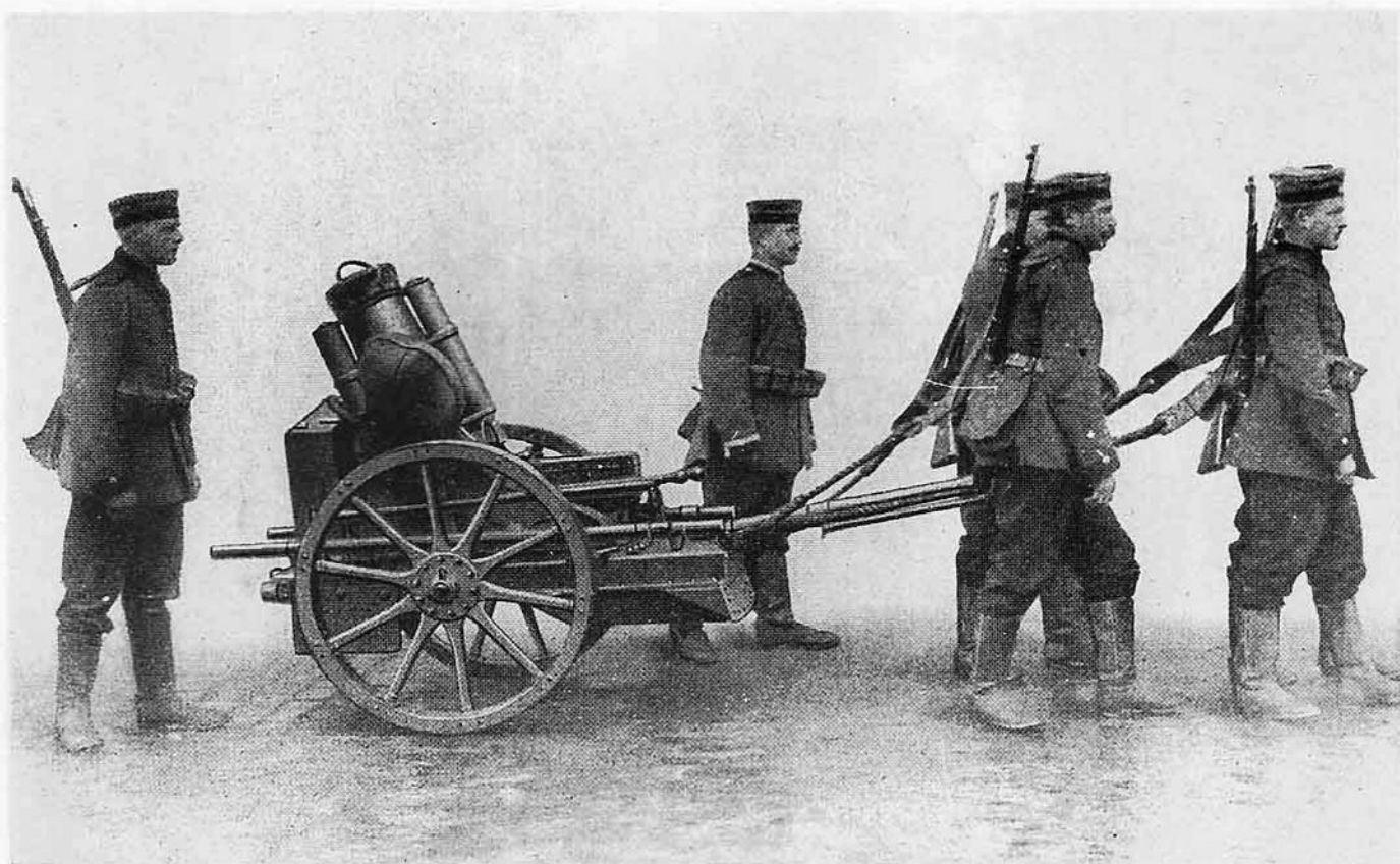
Der mittlere Minenwerfer auf einachsigen Transportkarren im Mannschaftszug. In Fahrtstellung und mit Zubehör mußten von der Bedienung immerhin 635 Kg fortbewegt werden.
