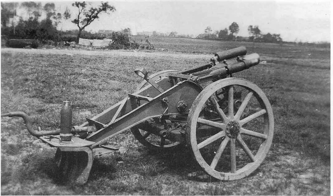
Der leichte Minenwerfer in Flachbahnlafette (leichter Minenwerfer n. A.) in Fahrstellung mit durchgesteckter Protzöse. Auf dem Sporn steht eine leichte Wurfmine, deren Kaliber bei 75,85 mm lag. Aufnahme aus den 20er Jahren.
