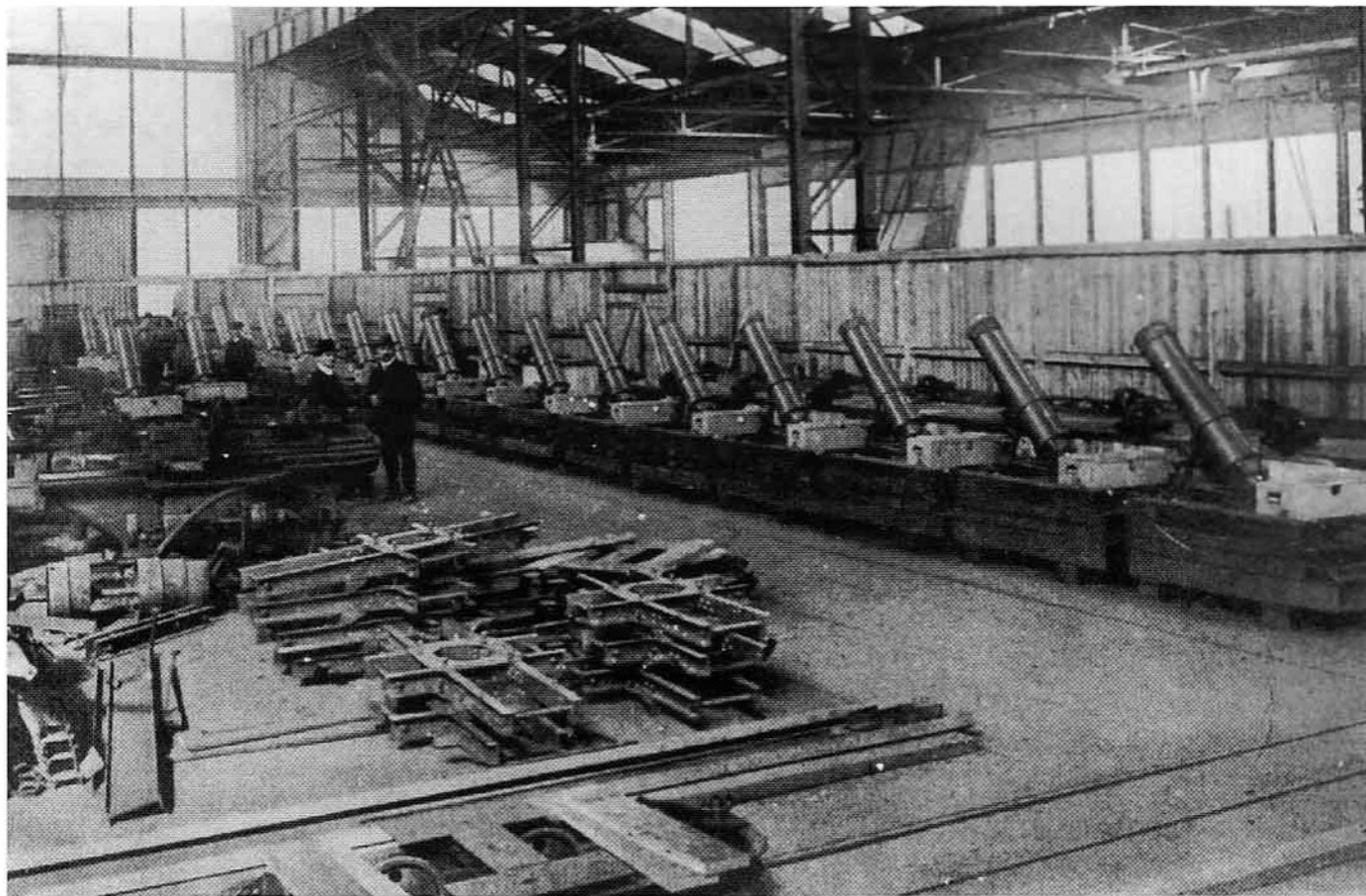
Der schwere Minenwerfer "Iko" ist in den Zawadzki-Werken nach Plänen des Ingenieurkomitees hergestellt worden. Werfer dieser Bauart waren schneller und billiger herzustellen und sollten die gezogenen Minenwerfer ergänzen. Ähnlich war das Modell "Albrecht". Geschößgewicht 100 Kg, Schußweite bis 1000 m.
