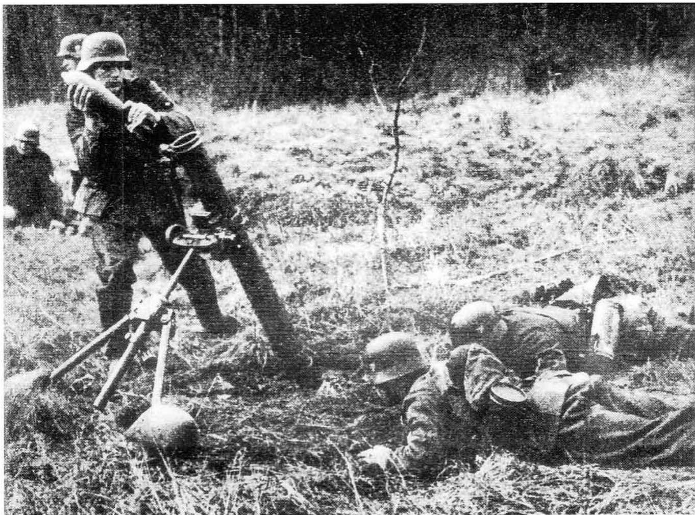
Nebelwerfer 35 in Feuerstellung. 7,38 Kg schwere Wurfgranaten konnten mit einer Vnull von 193 m/s bis auf 3025 m verschossen werden.
