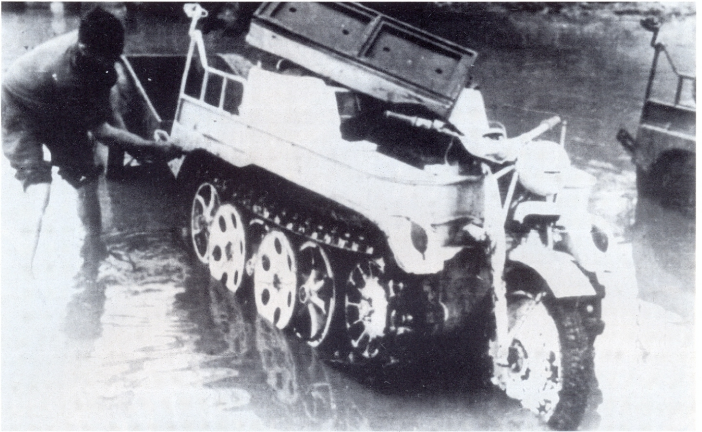
Grundreinigung der Kettenkräder in einem seichten Wasserloch. Offensichtlich soll der weiße Wintertarnanstrich am vorderen Kettenkrad entfernt werden. In Ermangelung ausreichender Tarnfarbe wurden die Fahrzeuge oftmals mit Kalk angestrichen, der sich später leicht abwaschen ließ.
