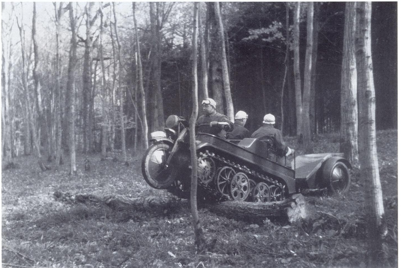
Rechts und unten: Eindrucksvolle Demonstrationen der Steigfähigkeit des Kettenkrades auf dem Versuchsgelände der NSU Werke in Neckarsulm. Kettenkräder dieser Baureihe wurden bereits auf allen Kriegsschauplätzen eingesetzt.
