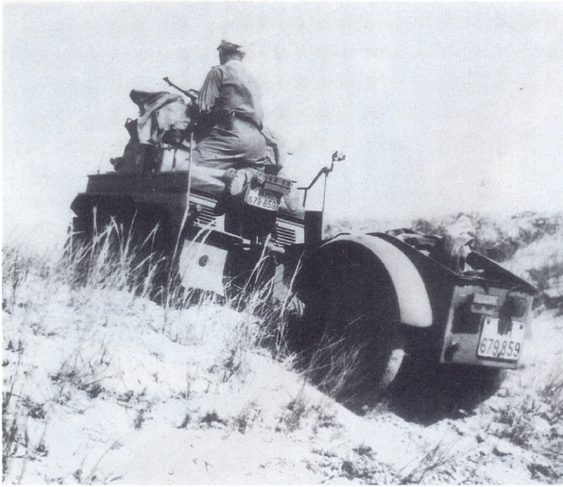
Oben links: Kettenrad mit Standardanhänger im Wüstengebiet Nordafrikas (1942). Gut zu erkennen die beiden Gewehrhalterungen am hinteren Teil des Kettenkrades.
