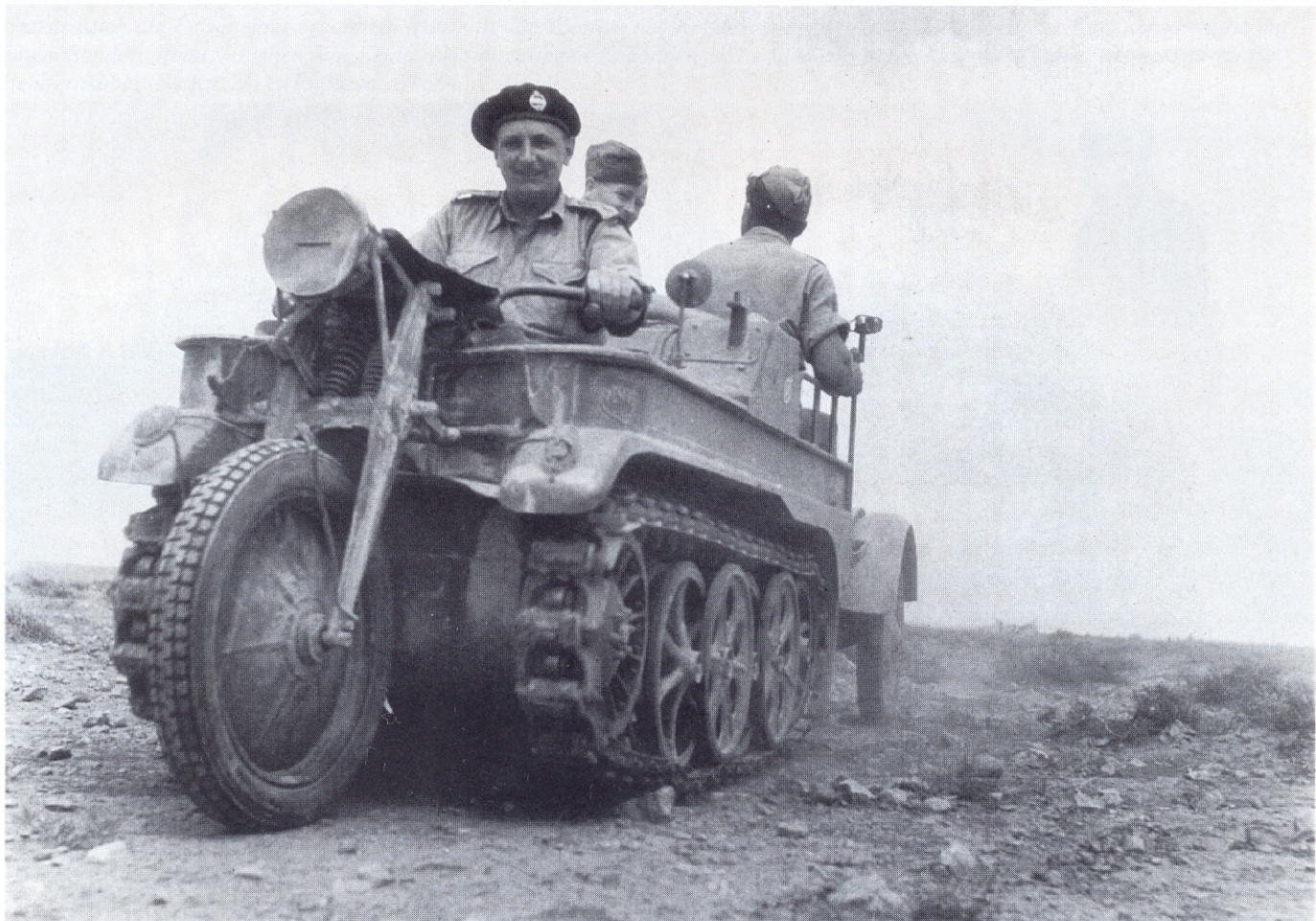
Auf dem nordafrikanischen Kriegsschauplatz führten die NSU Werke in Zusammenarbeit mit der Wehrmacht zahlreiche Truppenversuche mit dem Kettenkrad durch. Im Bild die Überprüfung der Gleisketten durch den Technischen Inspektor Esslinger, der auf diesen Versuchsfahrten von Ofw. Rex begleitet wurde. Beide waren Angehörige des Instandsetzungs-Regiments 548.
