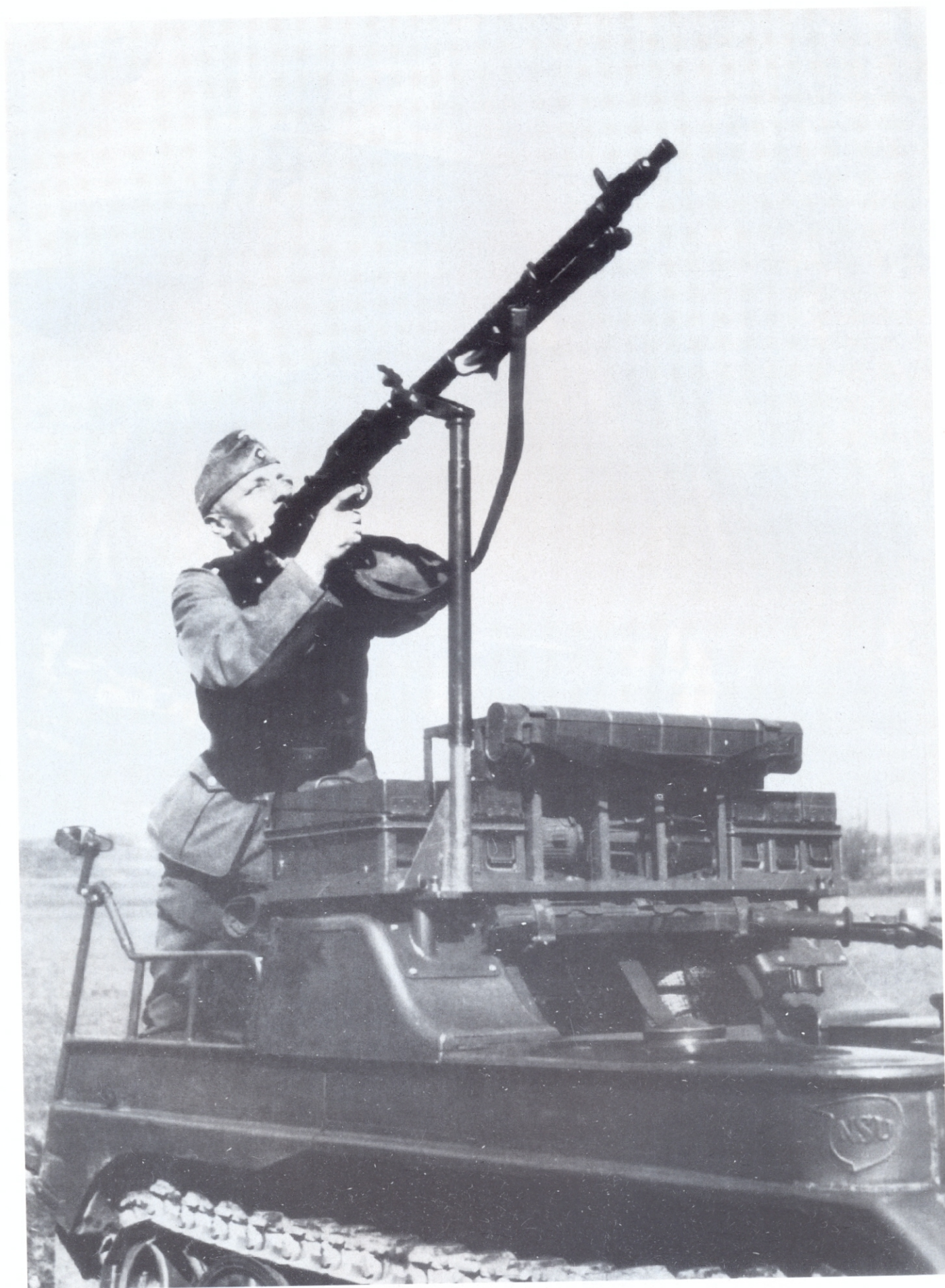
Eine weitere Variante der Fliegerabwehr vom Kettenrad. Gut zu erkennen sind die MG-Kästen und MG-Trommeln sowie der Behälter für das Ersatzrohr. Derartige Versuchsmodelle kamen jedoch größtenteils über den Truppenversuch nicht hinaus.
