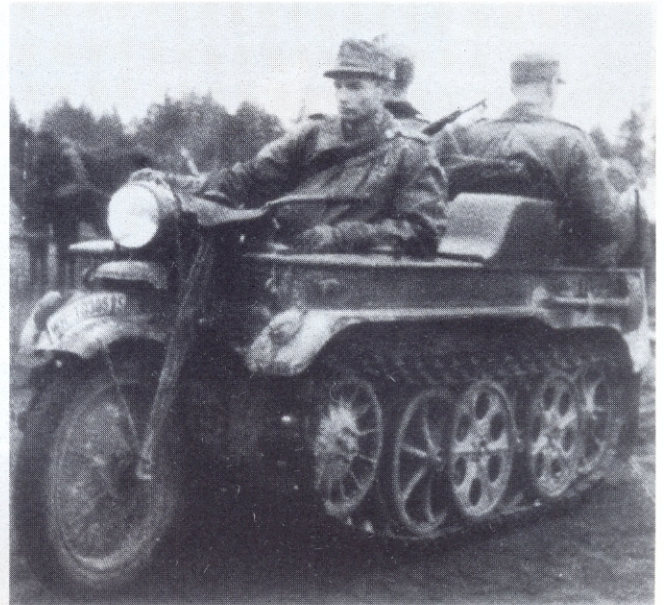
Die "Standardbesatzung" des Kettenrades - drei Soldaten - einer unbekannten Einheit. Beachte die fehlende Scheinwerferabdeckung, obenliegende Abschlepphaken sowie die zusätzlich hinten links angebrachte Schaufel.
