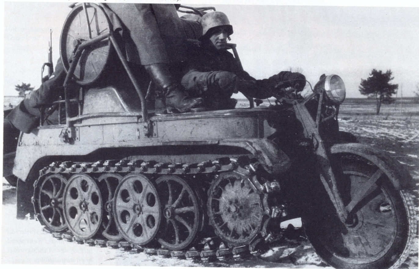
Unten: Auch die Fernmelder erkannten frühzeitig die Vorzüge des Kettenrades für ihre Tätigkeit. Dieses Kettenrad wurde mit einem Sonderaufbau versehen, um Feldfernkabel verlegen zu können und erhielt die Bezeichnung: "Kleines Kettenkraftrad für Feldfernkabel (Sd Kfz 2/1). (Rußland, Okt./Nov. 1941).
