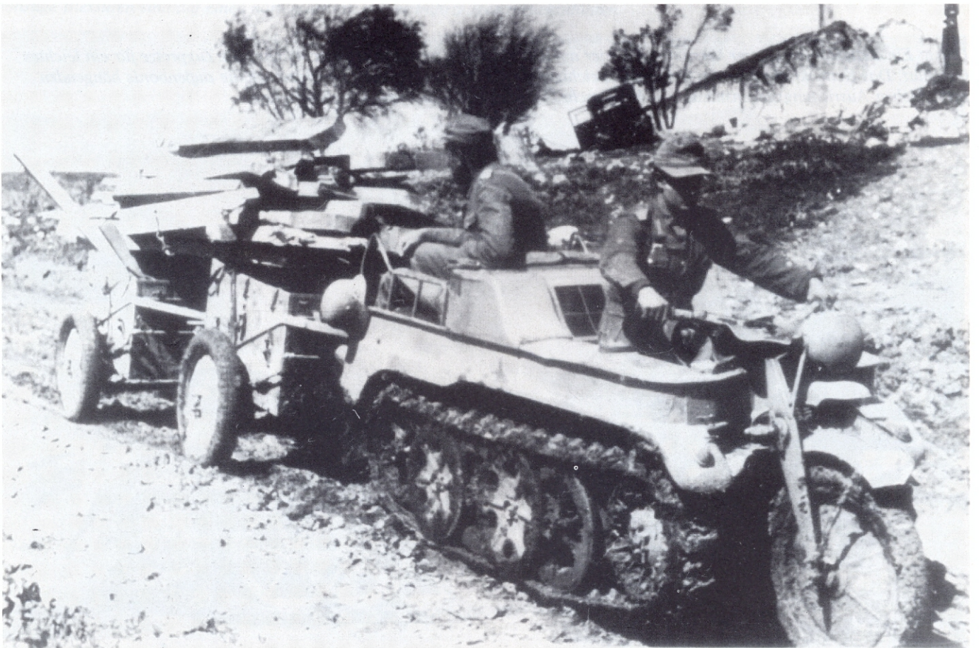
Auch diese Aufnahme verdeutlicht den vielfältigen Einsatz des Kettenkrades im unwegsamen Gelände. Zwei einachsige Anhänger dienen als Transportmittel für Bau- und Brennholz. Beachte die enorme Verschmutzung der Ketten und Räder.
