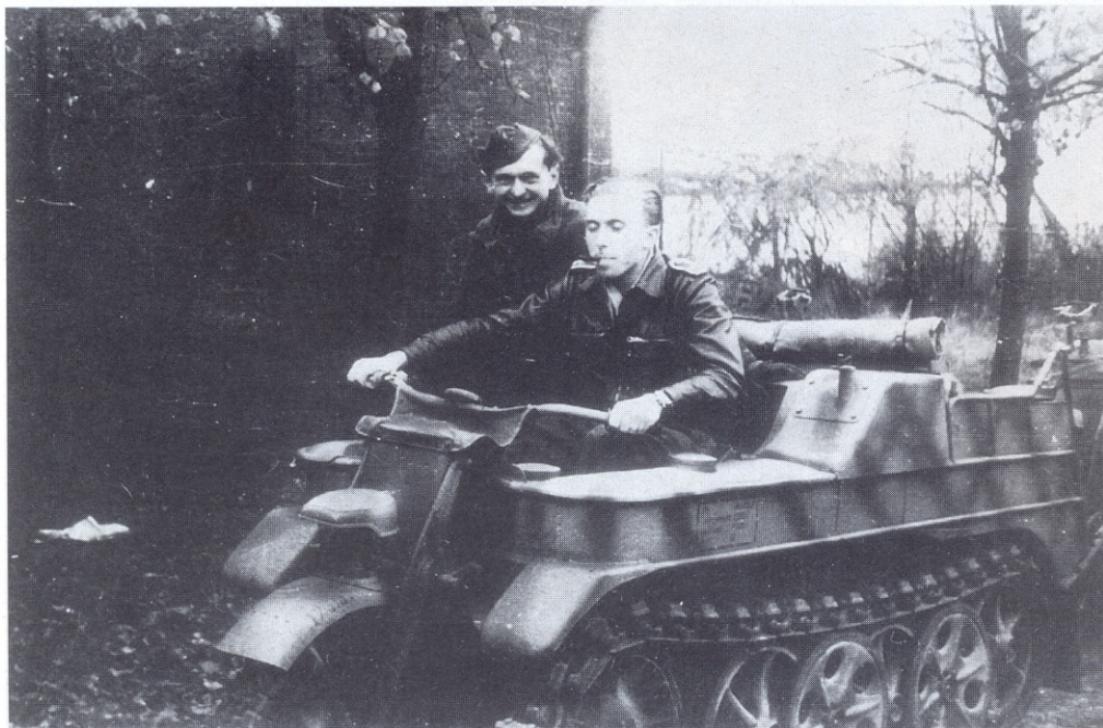
Links: Dieses mit einer Fleckentarnung versehene Kettenrad in verhältnismäßig gutem Zustand, verfügt weder über einen Scheinwerfer, über eine Halterung für das vordere Nummernschild, über einen Rückspiegel noch über Seitenleuchten. Gegen Kriegsende wurden die verzichtbaren Teile eingespart.
