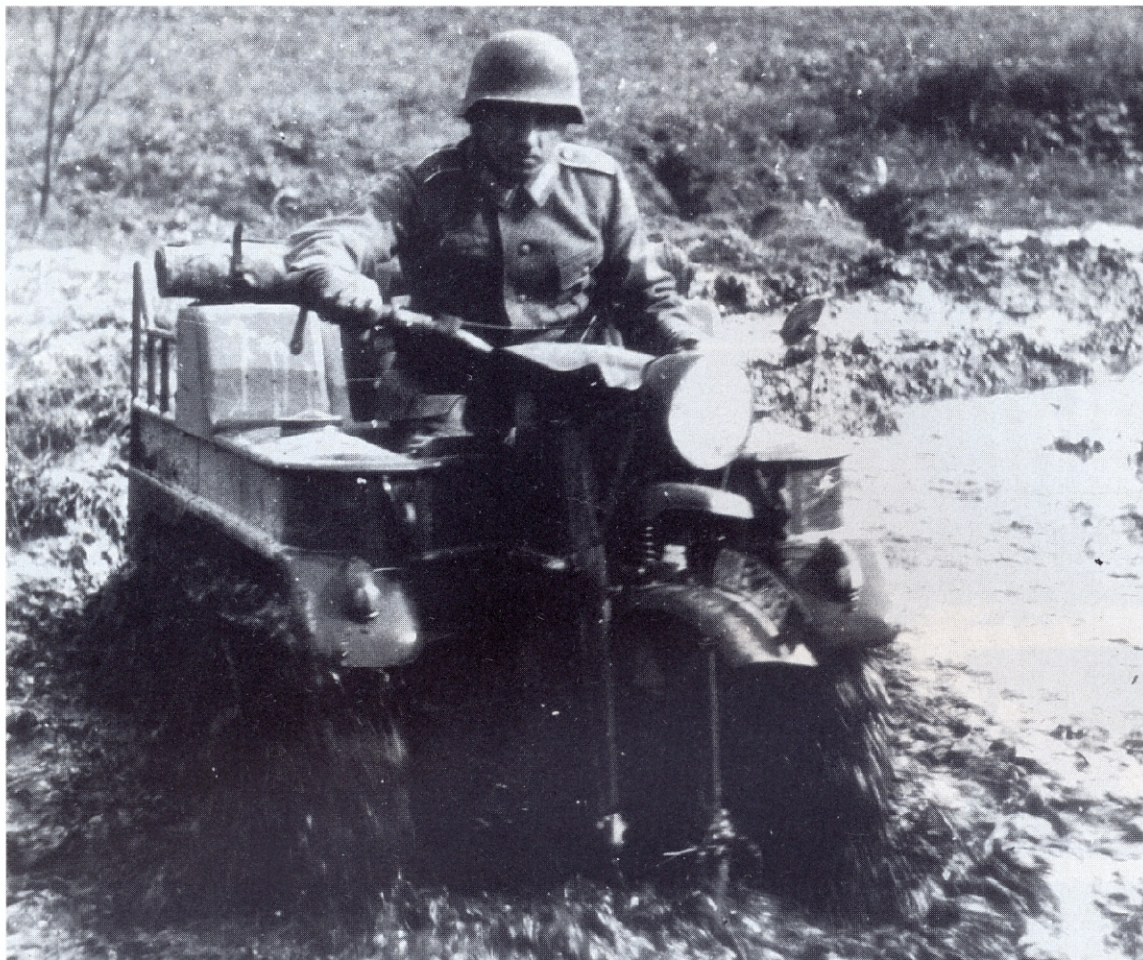
Links: Hier wird anläß- lich eines Trup- penversuchs ein- drucksvoll demon- striert, daß das Kettenrad auch in der Lage war, bei fehlendem Vor- derrad ein unweg- sames Gelände zu durchqueren.....
