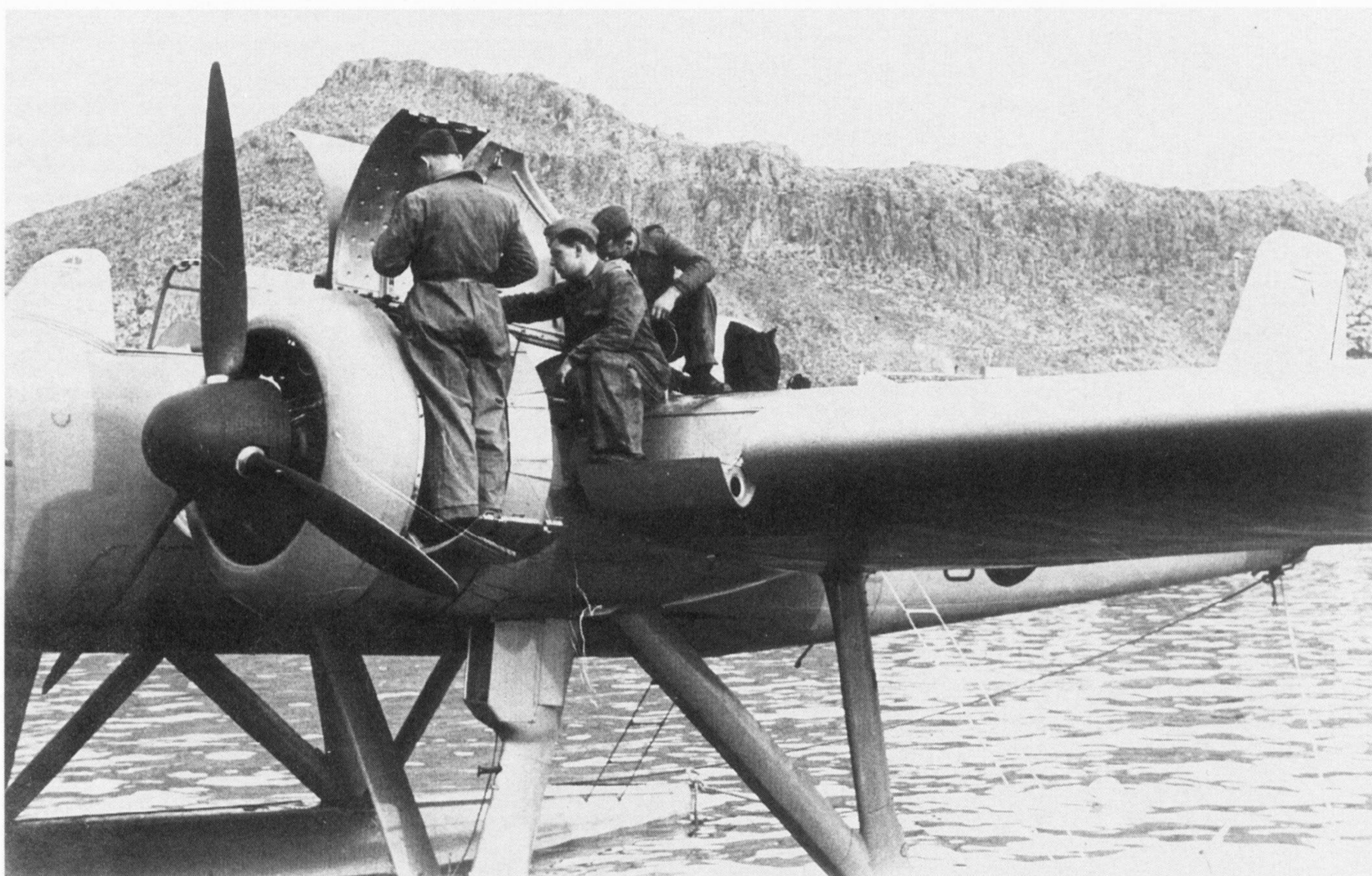
Unten: Motorenwartung nach Ankunft der "spanischen" He 115 A.
