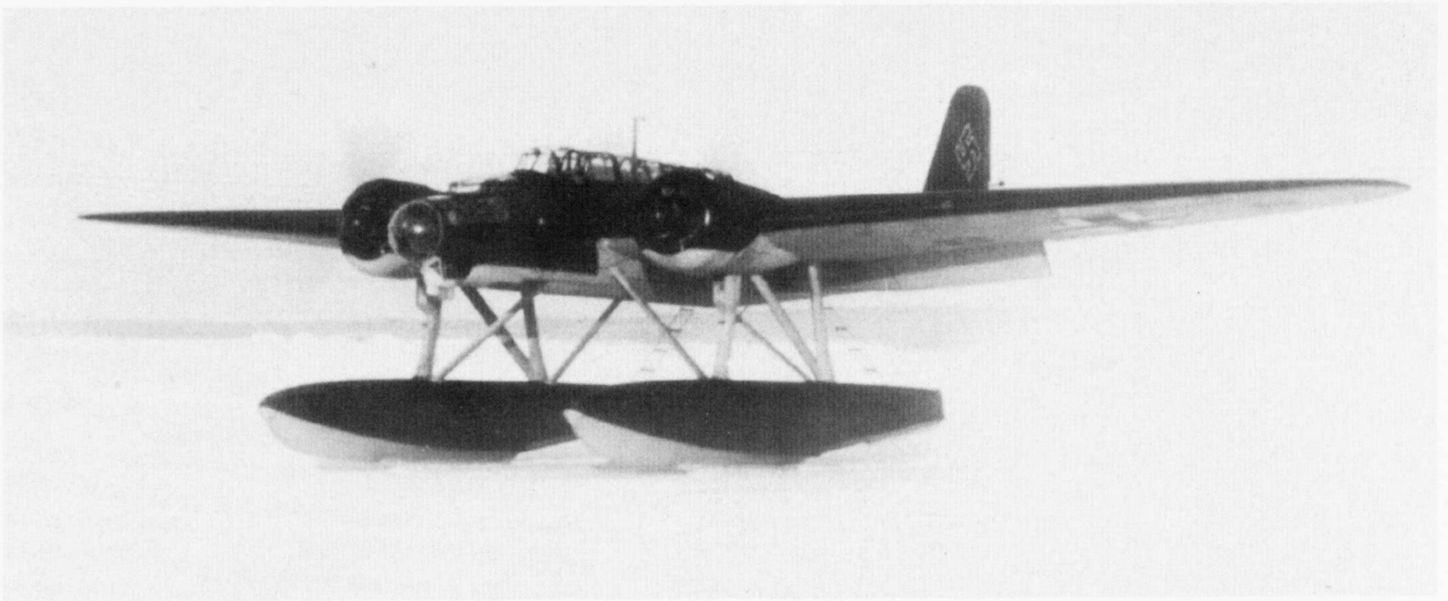
He 115 B-2 CA + BR startet mit Hilfe von Eiskufen unter den Schwimmern von einem zugefrorenen See aus.
