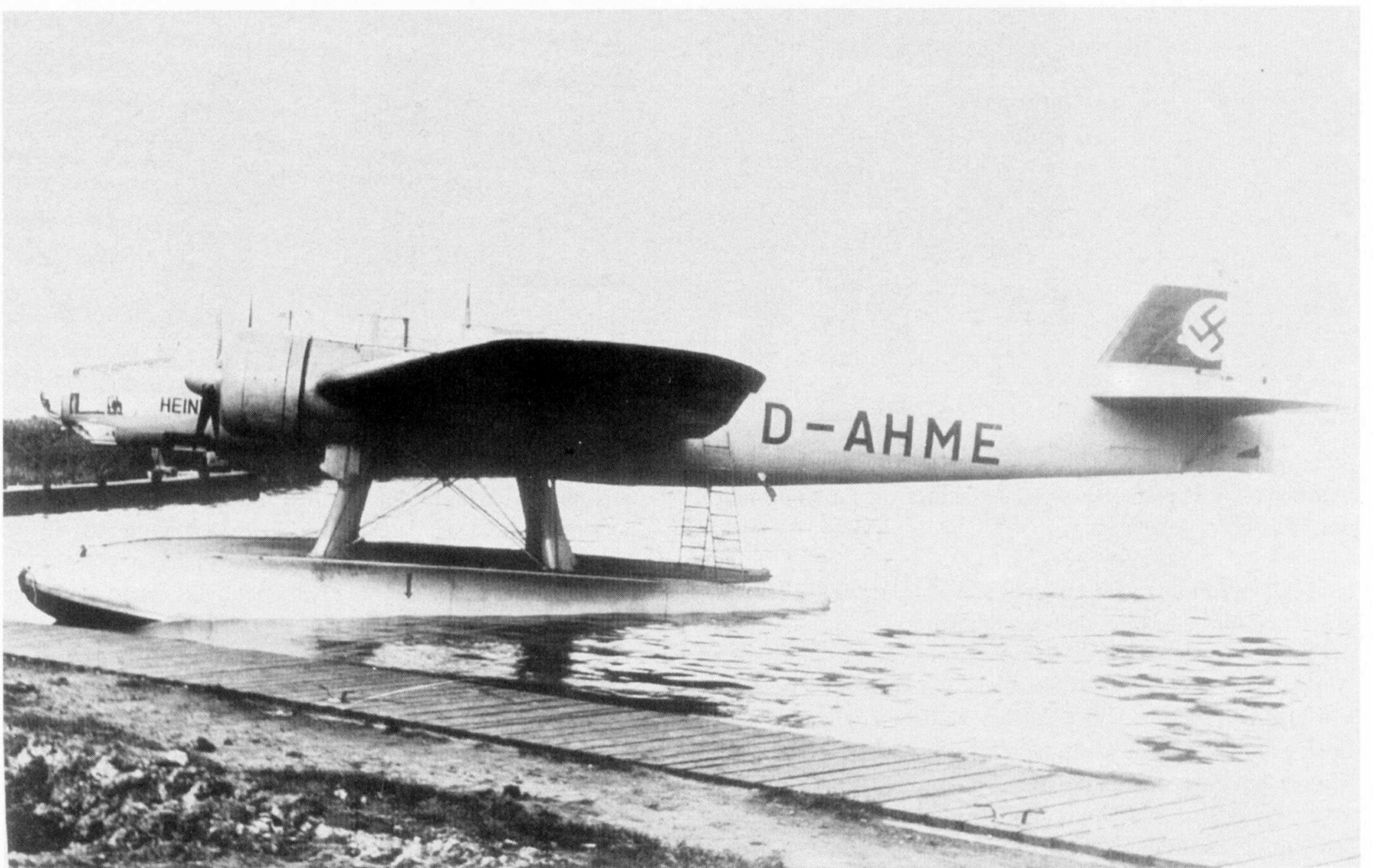
Unten: He 115 V4 D-AHME mit vergrößertem Seitenruder. Es war das letzte Muster mit drahtverspannten Schwimmern.
