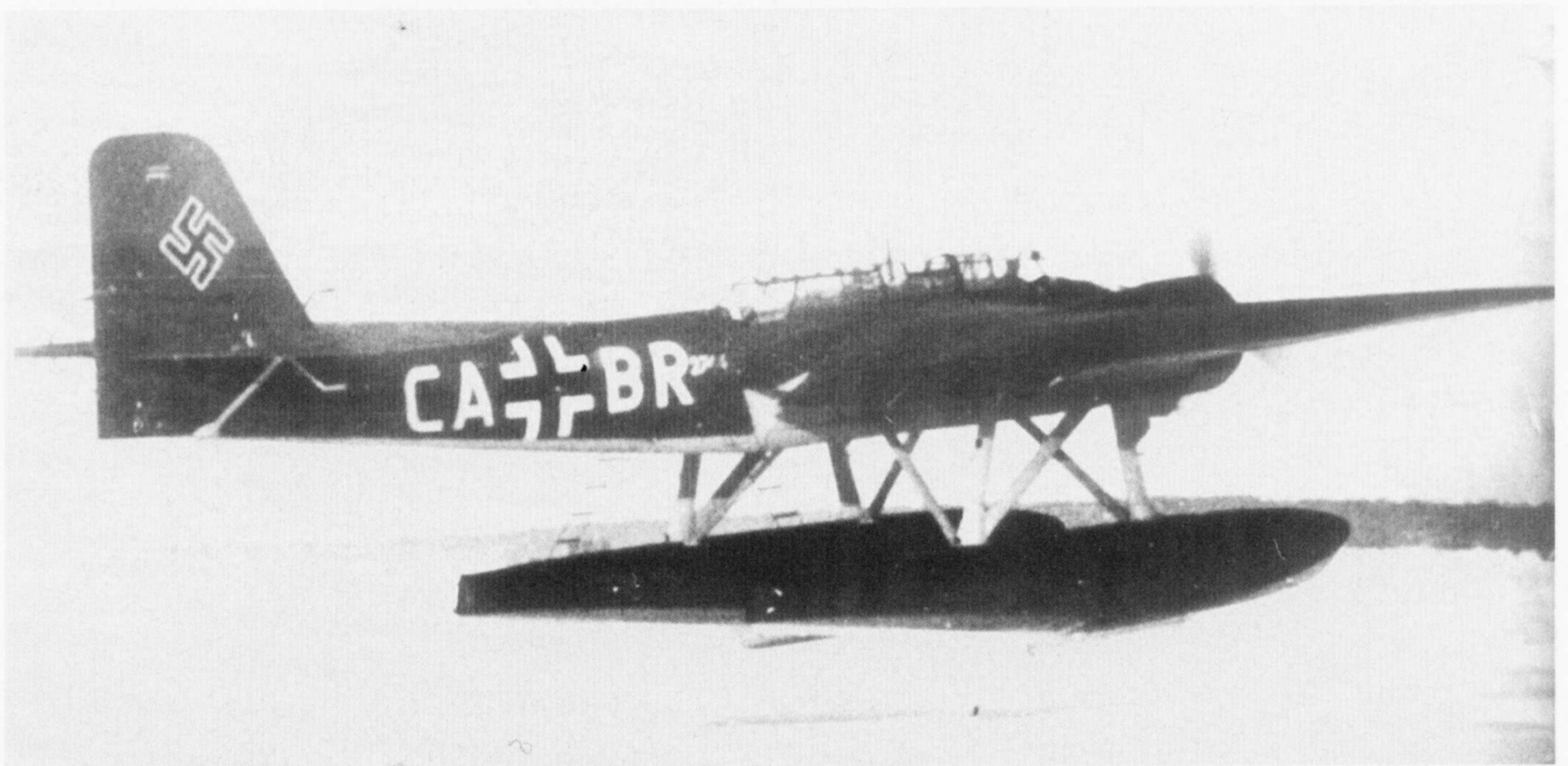
He 115 B-2 CA + BR startet mit Hilfe von Eiskufen unter den Schwimmern von einem zugefrorenen See aus.
