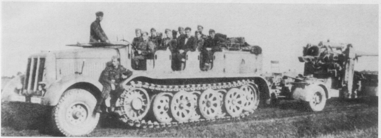
Unten: 12-Tonner Typ DB 10 mit 8,8 cm Flak 36 (bzw. 37) auf Sd. Ah. 202. Auf den 3 breiten Sitzbänken hatten jeweils 4 Soldaten Platz.
