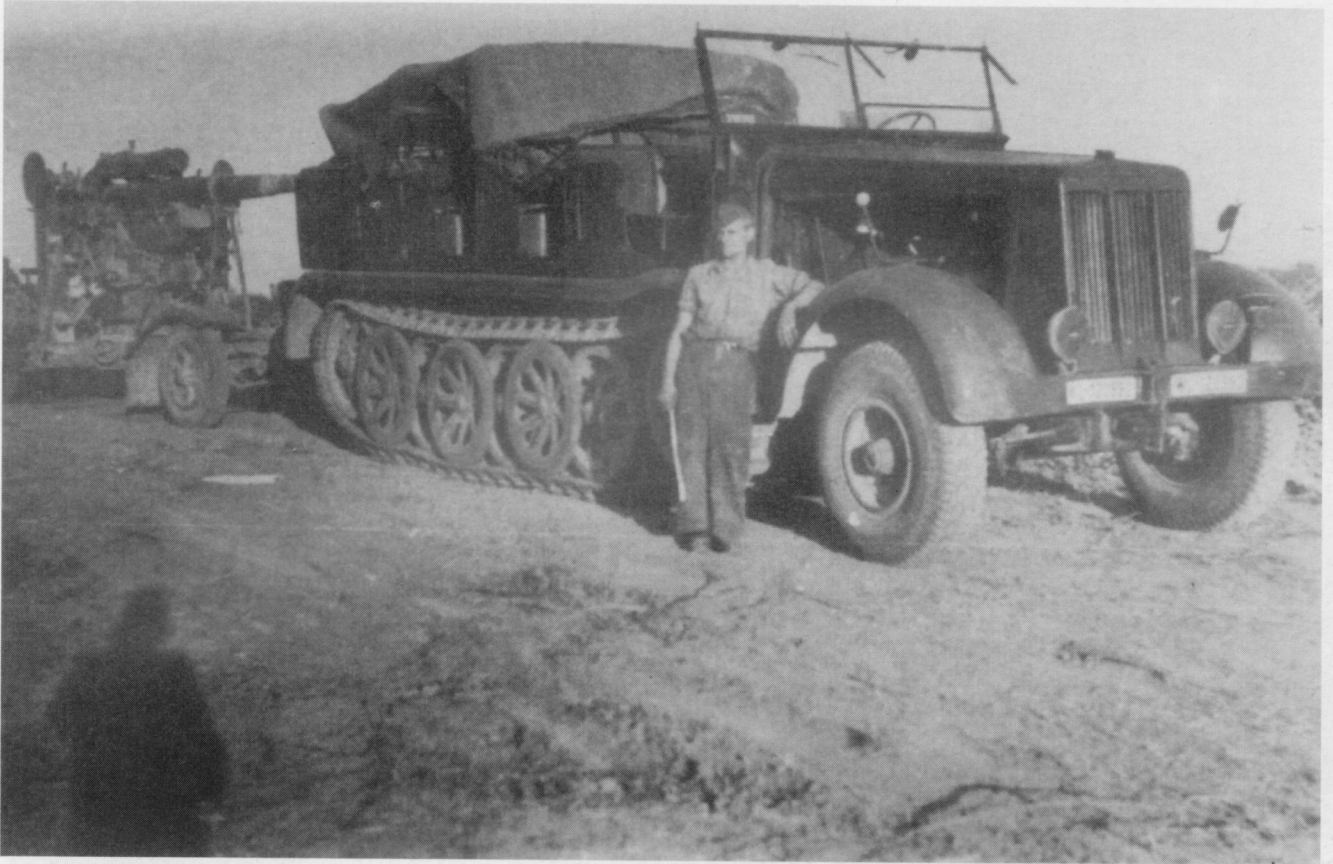
Schwerer Zugkraftwagen 12 t (Sd. Kfz. 8) Typ DB 10 mit 8,8 cm Flak 18 auf Sonderanhänger 201. Bei dieser Aufnahme kann man gut die neue Vorderachskonstruktion erkennen.
