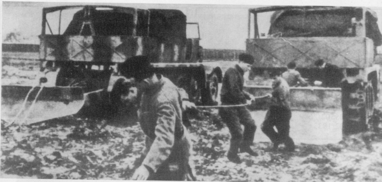
Die Seilwinde des 18-Tonners hatte eine Zugkraft von 7,0 t. Zur Schaffung eines entsprechenden Widerlagers waren verschiedene Erdsperre in Erprobung.
