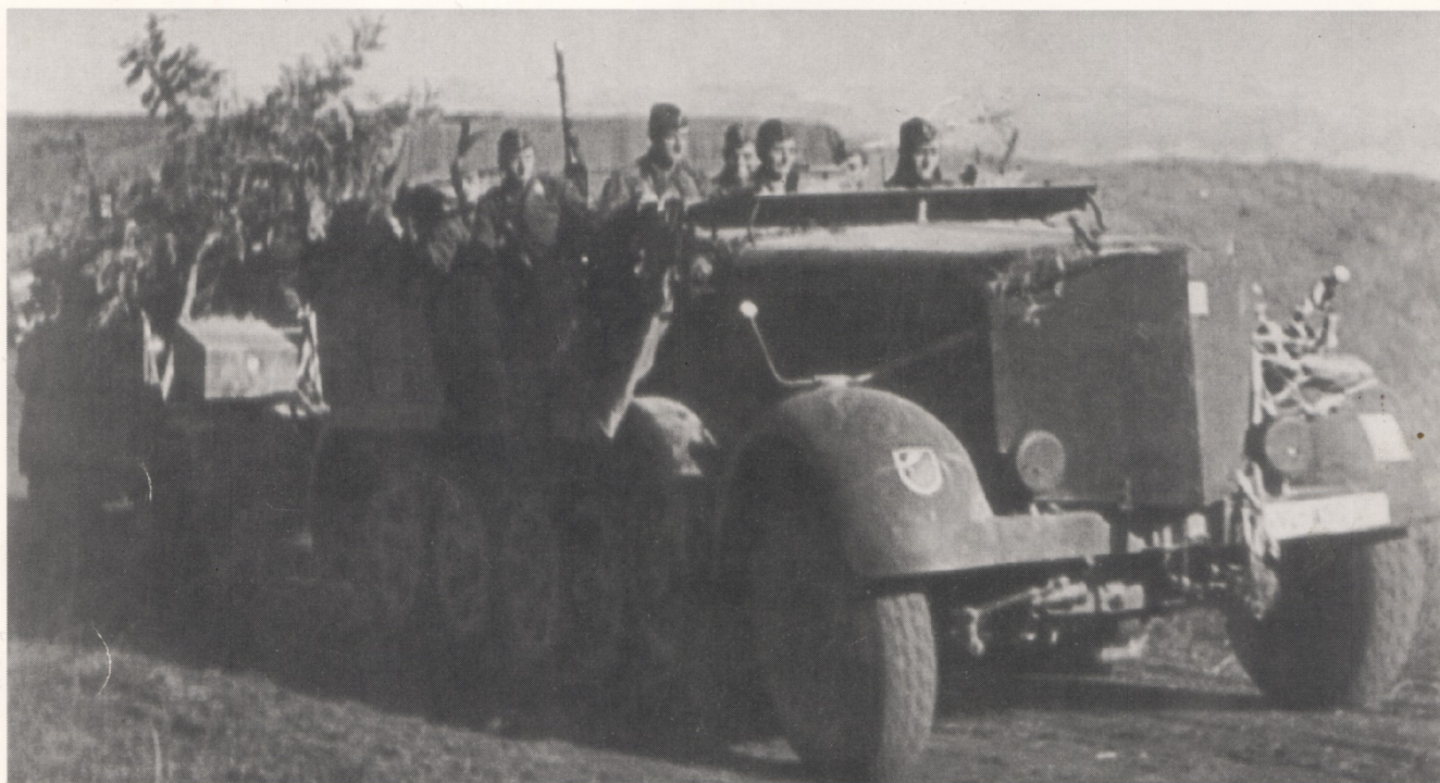
Schwerer Zugkraftwagen 12 t (Sd. Kfz. 8) mit einer zusätzlichen Kühlerpanzerung als Zugmittel für eine schwer definierbare Anhängelast. Das Truppenkennzeichen ähnelt sowohl Flakkorps I als auch einem "Hermann Göring"-Verband. Beachte MG auf Fliegerdrehstütze.
