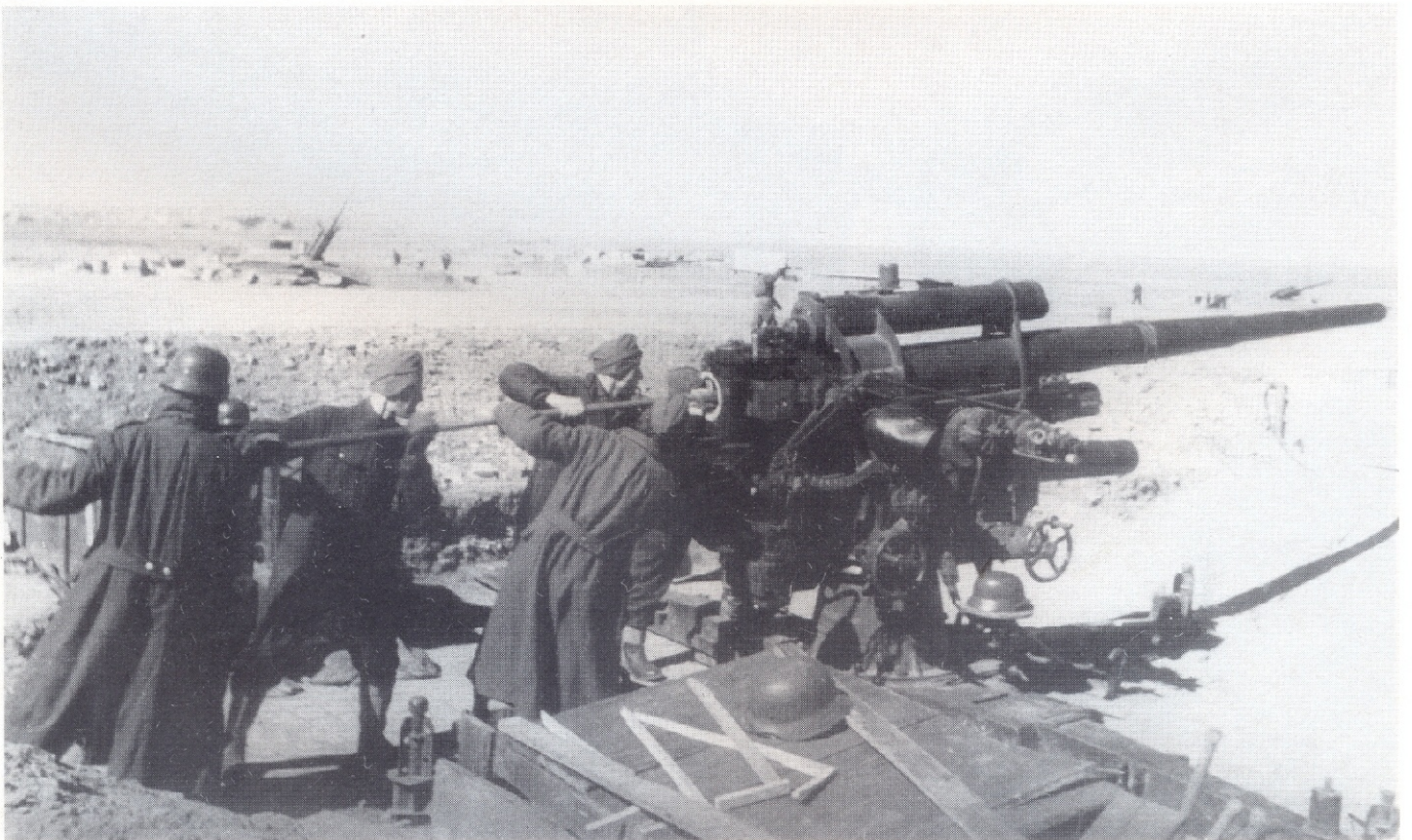
Unten: Nach jeder Gefechtstätigkeit galt es, das Rohr sofort von Pulverrückständen mit Hilfe des Rohrwischers zu reinigen. Diese Arbeit wird hier von der Geschützbedienung in einer 8,8cm Batterie gerade ausgeführt.
