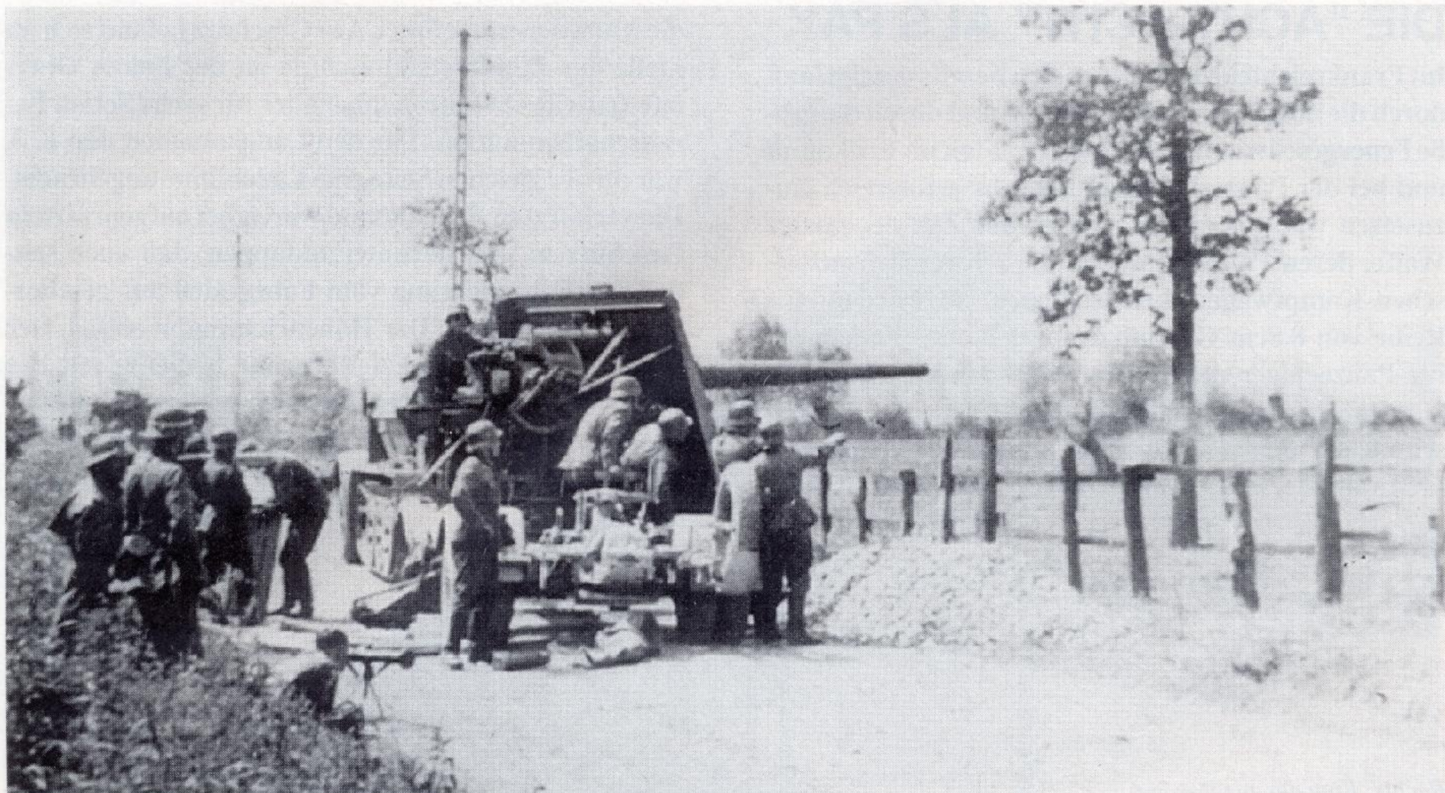
Oben: Eine zur Pak umgerüstete 8,8cm Flak eingesetzt beim I.R.51 im Bereich der 18.I.D. im Mai 1940 in der Nähe von Dünkirchen bei Bernes. Vorn am Straßenrand hat der E-Meßmann sein Gerät auf einem Dreibein aufgestellt. Anscheinend ist das Geschütz noch an der gepanzerten Zugmaschine angekoppelt. Zu einem schnellen Feuerüberfall vom Sonderanhänger aus wurden nur die Seitenholme abgeklappt.
