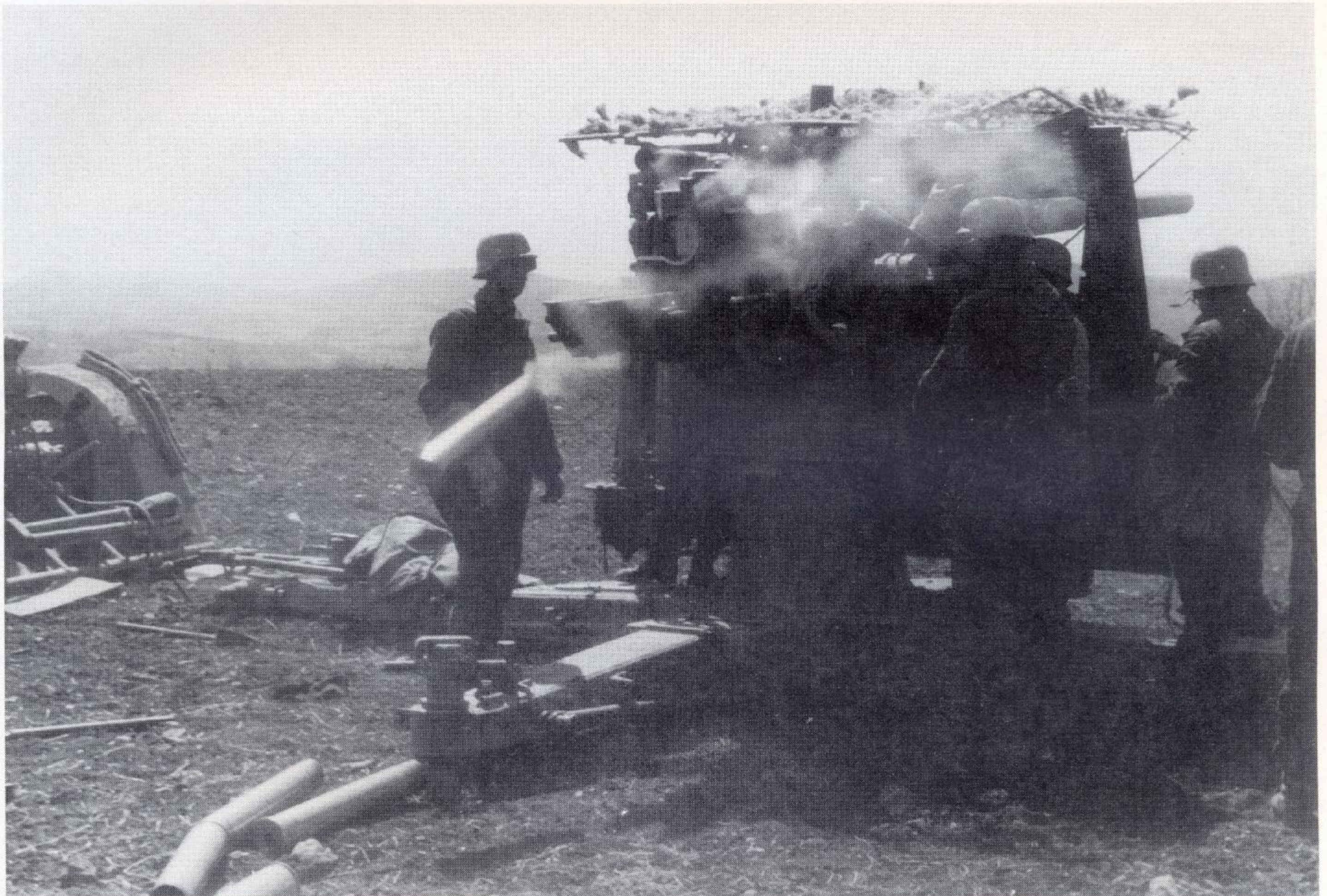
Unten: Die noch rauchende leere Patronenhülse wird nach dem Abfeuern gerade ausgeworfen. Die Bedienung hat das Geschütz zu einem raschen Einsatz auf freiem Feld abgesenkt. Einsatzort war für diese „Acht-Acht“ 1941 der Balkan.
