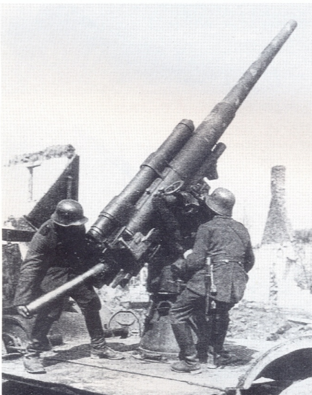
Unten: Diese 8,8cm K.-Zugflak L/45 von Rheinmetall steht hier an der Westfront im Einsatz. Der Seitenrichtkanonier sitzt an der rechten Seite auf seinem höhenverstellbaren Sitz und visiert durch das Zielfernrohr blickend das Ziel an. Die Höhenrichtmaschine wurde mit einem Handrad von der linken Geschützseite aus bedient.
