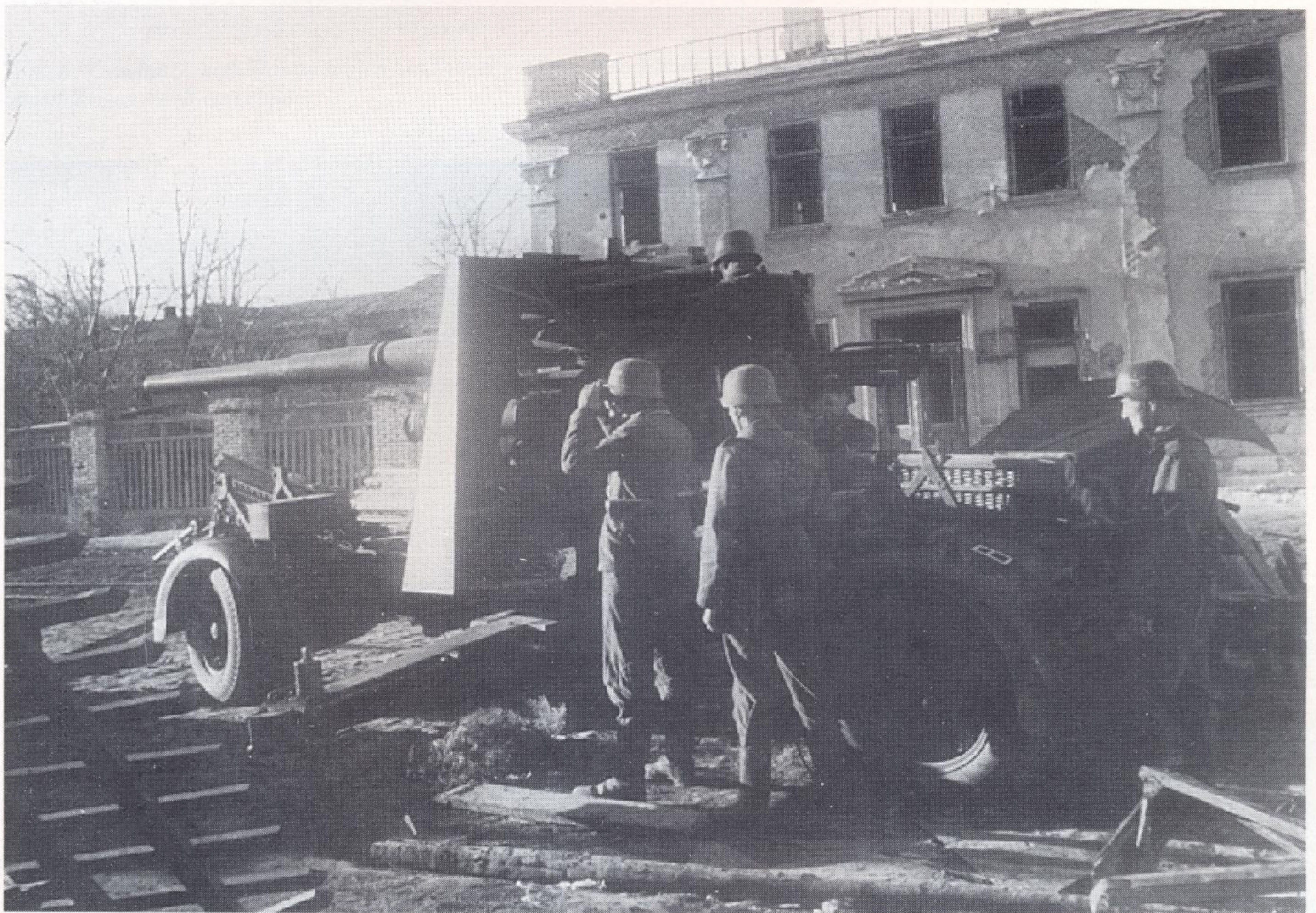
Unten: Hier soll vom Fahrgestell aus geschossen werden. Die Seitenholme sind abgeklappt, das Geschütz aber nicht abgesenkt, es steht hier im Straßenkampf 1942 auf der Halbinsel Kertsch.
