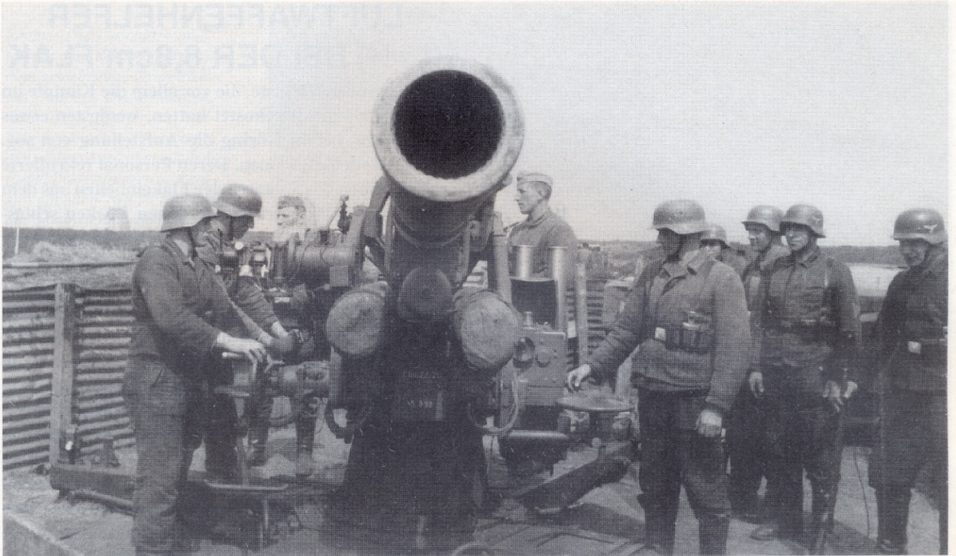
Oben: Ein Blick in die Rohrmündung der 8,8cm Flak 18 läßt die 32 Züge erkennen. Im Bild links stehen der Seiten- dahinter der Höhenrichtkanonier an ihren Plätzen. Rechts ist der K6 im Begriff, seinen Platz an der Zünderstellmaschine einzunehmen. Hinter ihm stehen Munitionskanoniere bereit.
