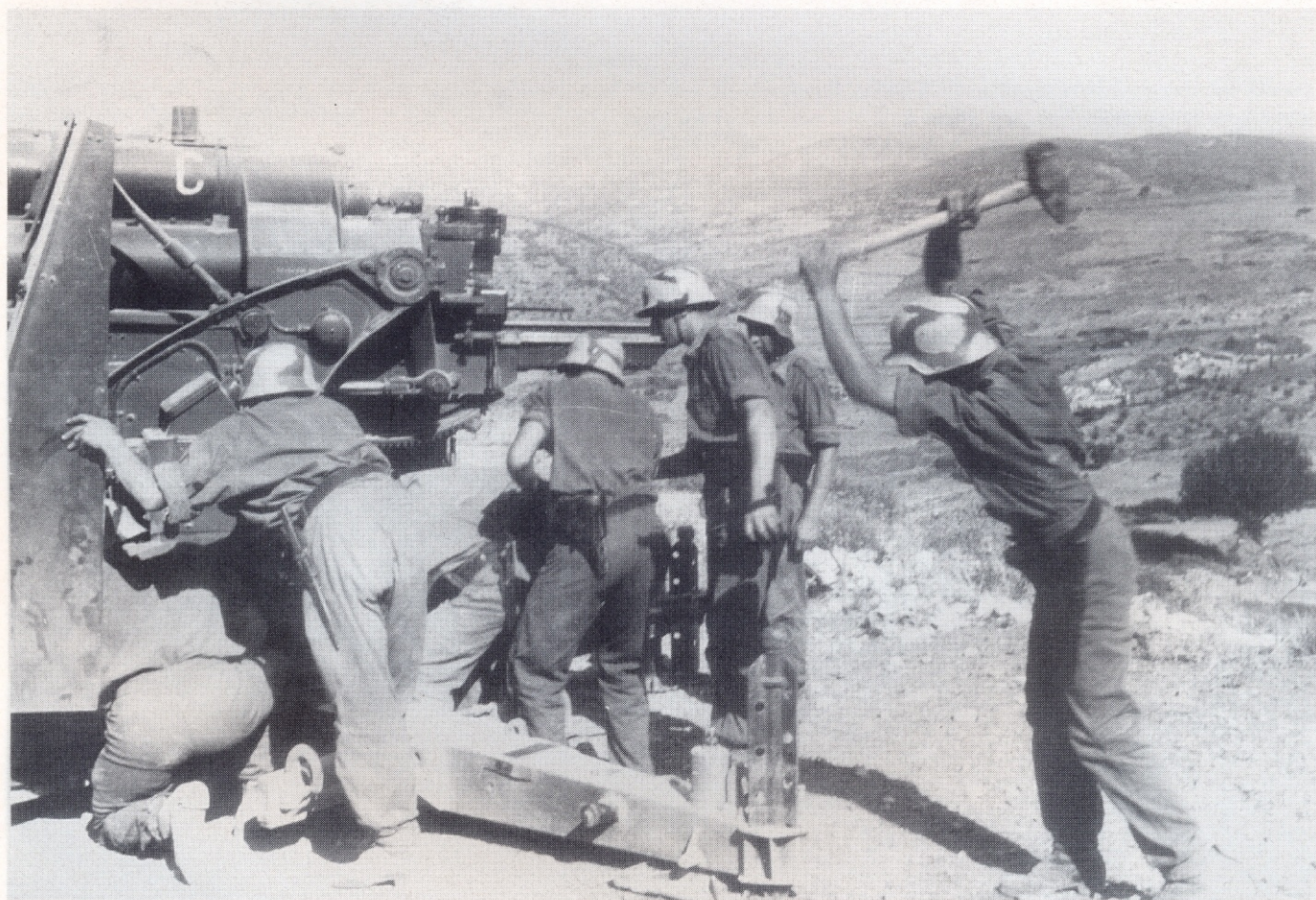
Unten: Geschütz "Cäsar" geht hier an einem Ort auf dem Balkan in Stellung. Während einige Kanoniere die Oberlafette mit Hilfe der Handräder am Lafettenkreuz und den Libellen horizontieren, schlägt einer mit einem Vorschlaghammer einen Erdpfahl am Ende des Längskolmen ein.
