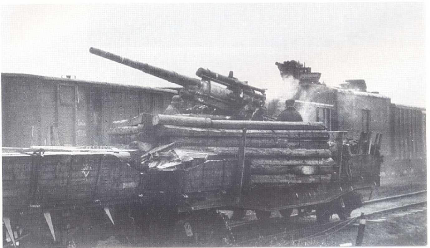
Unten: Diese 8,8cm Flak steht hier auf dem Geschützwagen eines behelfsmäßigen Panzerzuges. An Stelle einer Panzerung dienten Holzbohlen und Sandsäcke als Splitterschutz. Mit einem solchen "Behelfs-Panzer-Zug" wurden bei der 9. Flak Div. auf der Krim unter Führung von Lt. Muhr im Herbst 1943 und Frühjahr 1944 23 russische Panzer und einige Schlachtflugzeuge vernichtet.
