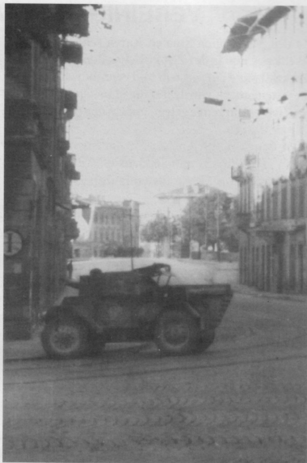
Die bei Lancia gebauten Panzerspähwagen führten die Bezeichnung "Lince" und sind auf den ersten Blick nur durch das MG vom Daimler Dingo zu unterscheiden. Hier ein Fahrzeug einer Fallschirmjägerereinheit beim Straßenkampf in einer italienischen Stadt. (BA)
