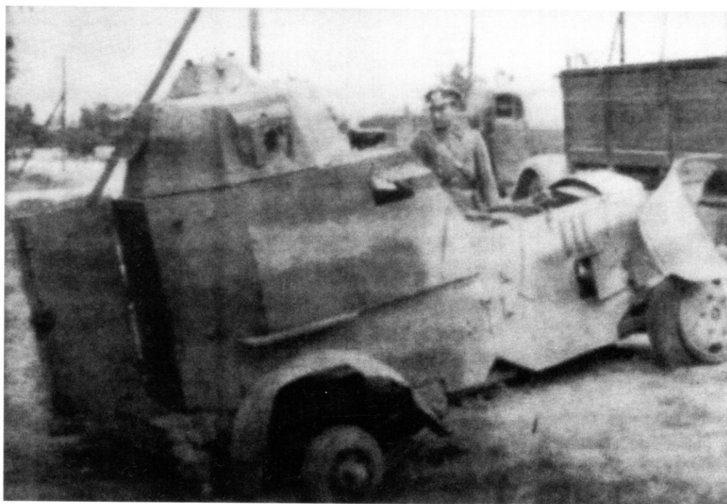
Bei diesem liegengebliebenen wz. 34 ist die Turmbewaffnung, die in einer eckigen Blende gelagert war, bereits ausgebaut. Auf diesem Foto ist sehr gut die große Hecktür zu sehen. Die Fahrzeuge besaßen eine zweite Tür an der linken Seite.
