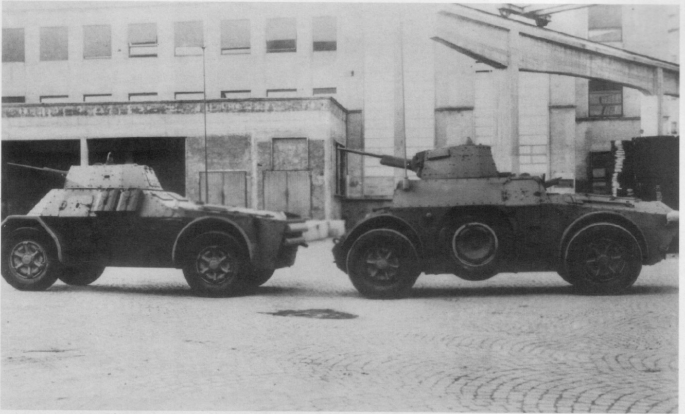
Oben und unten: Der Panzerspähwagen AB 41 (rechts) sollte 1943 durch den Typ AB 43 (links) abgelöst werden. Der Prototyp des neuen Modells hatte einen geänderten Aufbau in dem die Stützräder entfallen und die Türen nach vorne verlegt waren. Das Heck-MG entfiel und auch der Kühlergrill war abgeändert. Das Fahrzeug erhielt einen neuen flacheren aber geräumigeren Turm, in den wahlweise eine 2-cm- oder 4,7-cm-Kanone eingebaut werden konnte. (BA)
