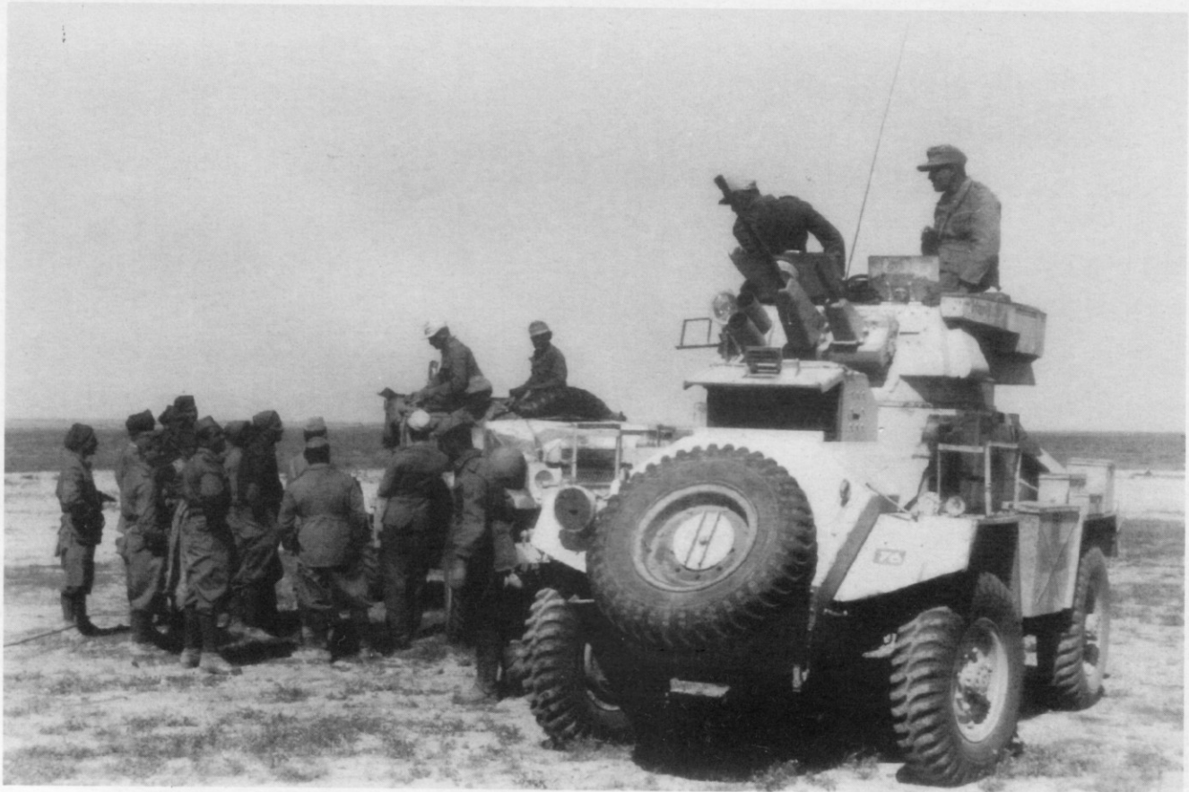
Oben: Humber Mark III "Isle of Ely" eingesetzt bei der 4. Fallschirmjäger-Division in Italien. Der Spähwagen ohne Bewaffnung ist mit Balkenkreuzen gekennzeichnet und mit Ausrüstungsgegenständen bepackt. (BA) Unten: Humber Mark I mit dem Namen "Hans" links am Turm in Afrika 1942. Bei den Humber Mark I war die Fahrerkabine noch nicht in den Aufbau integriert. Das Fahrzeug gehörte ehemals zum Panzer-Aufklärungs-Regiment (12th Lancers) der 1. brit. Panzer-Division. (BA)
