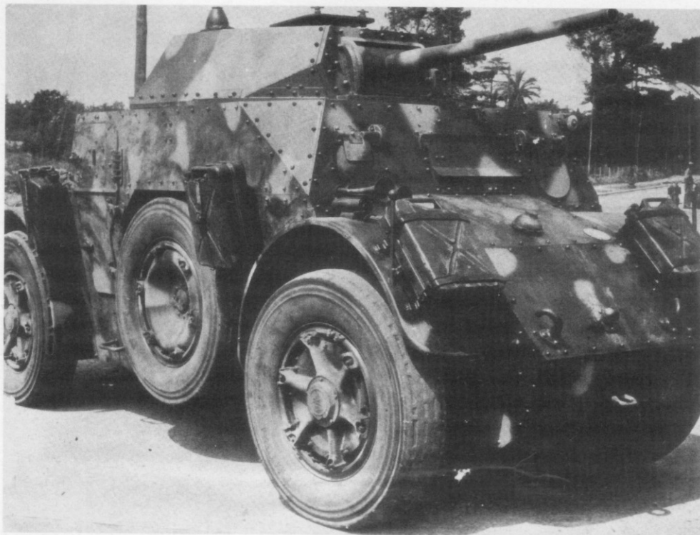
Links: Im September 1943 war ein Prototyp des AB 43 mit 4,7-cm-Kwk L/32 vorhanden. Das Fahrzeug war ein im Aufbau verbreiteter AB 41 mit dem neuen Drehturm. (WS)
