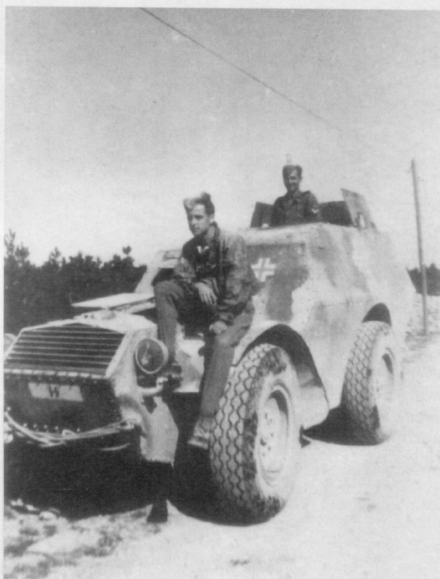
Oben und unten: Auf Basis des Radschleppers Fiat A.S. 37 ließ die italienische Armee gepanzerte Mannschaftstransportwagen bauen, die ebenfalls die Bezeichnung A.S. 37 führten. Die oben offenen Fahrzeuge hatten eine zweigeteilte Hecktür und waren mit MG bewaffnet, die hinter Steckschilde montiert werden konnten. Oben frisch erbeutete Fahrzeuge und unten im Einsatz bei der 7. SS-Gebirgs-Division. (1xBA, 2xMV)
