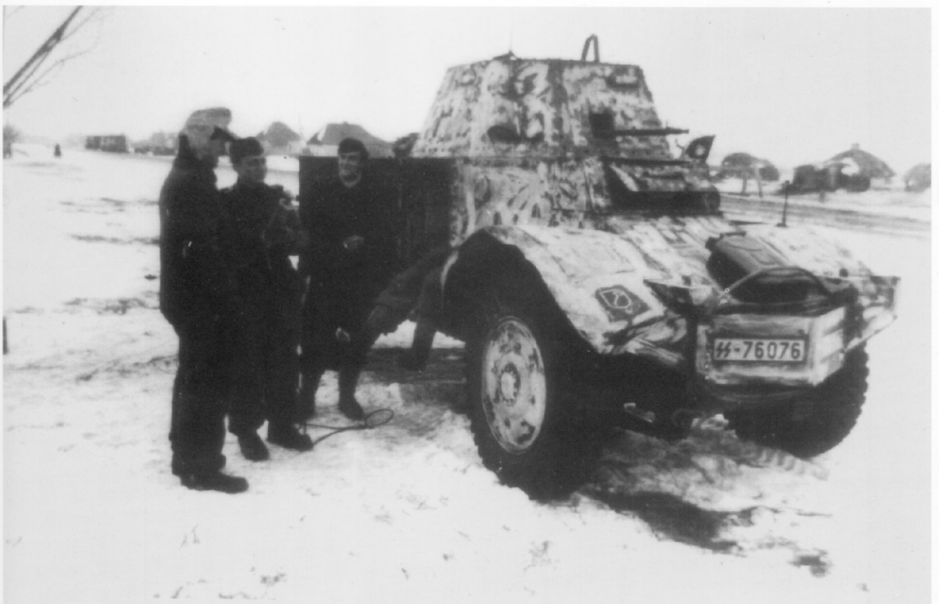
Ein Panhard-Funkwagen beim Kriegsberichterzug der 1. SS-Panzer-Division. In diese Kriegsberichter-Spähwagen war eine Tonaufnahmestation eingebaut, das zugehörige Mikrofon hält ein Soldat in der Hand. Bewaffnet ist das Fahrzeug mit einem MG-34. (BA)
