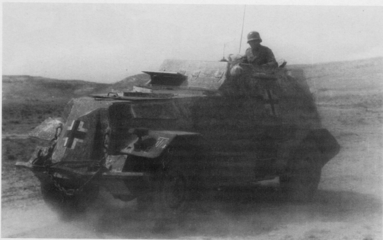
Unten: Marmon-Herrington Mark III, späte Ausführung mit durchgehender Kühlerpanzerung in Tunesien 1943. Dieses Fahrzeug, das als Vorlage für das Titelbild diente, ist als Beobachtungspanzer bei der 4. Batterie, Pz. Art. Rgt. 155 der 21. Panzer-Division eingesetzt. (BA)
