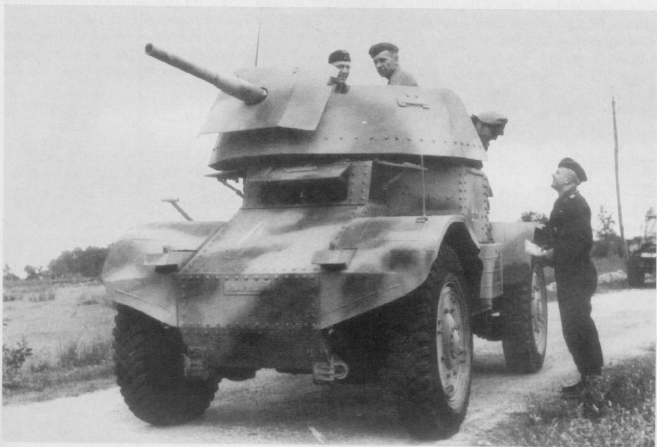
Oben und unten: Bei der Besetzung Restfrankreichs 1942 wurden einsatzbereite Panhard-Spähwagen erbeutet, bei denen jedoch die 2,5-cm-Kanone ausgebaut und durch ein zweites MG ersetzt worden war. Bei einigen dieser Fahrzeuge wurde der Turm entfernt und dafür eine 5-cm-Kwk L 42 in einem offenen Aufbau aufgesetzt. (BA)
