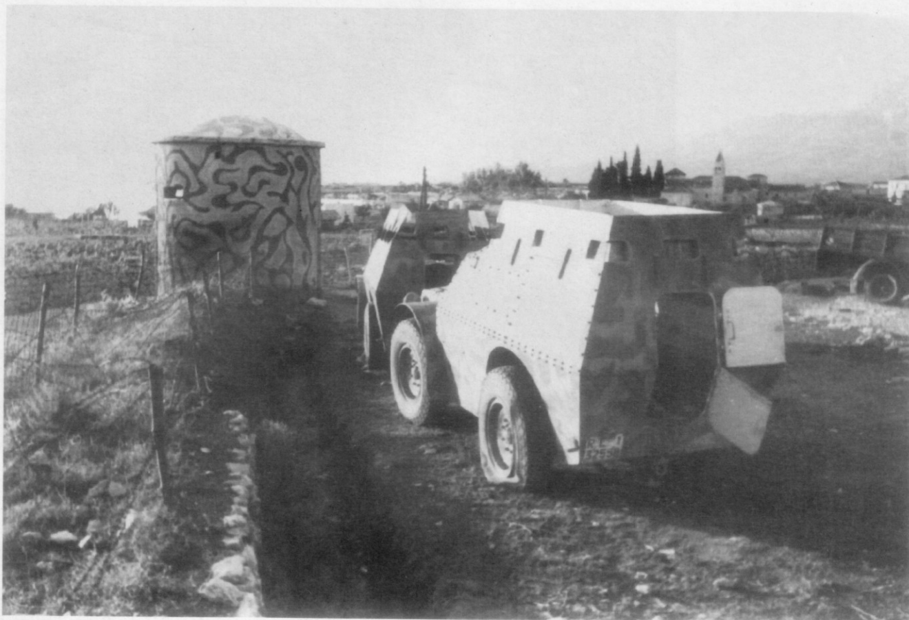
Oben und unten: Auf Basis des Radschleppers Fiat A.S. 37 ließ die italienische Armee gepanzerte Mannschaftstransportwagen bauen, die ebenfalls die Bezeichnung A.S. 37 führten. Die oben offenen Fahrzeuge hatten eine zweigeteilte Hecktür und waren mit MG bewaffnet, die hinter Steckschilde montiert werden konnten. Oben frisch erbeutete Fahrzeuge und unten im Einsatz bei der 7. SS-Gebirgs-Division. (1xBA, 2xMV)
