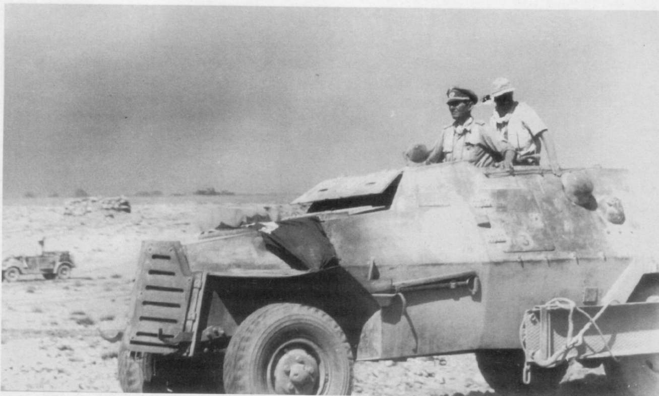
Oben: Eine frühe Ausführung des Marmon-Herrington Mark II, bei der noch hinten links unterhalb des Stahlhelms die Kugelblende für das MG im Aufbau vorhanden ist. Diese Kugelblende war meist demontiert und die Öffnung durch eine Panzerplatte verschlossen. Auch dieses nur mit einem Fliegersichttuch gekennzeichnete Fahrzeug wird ohne Turm als Kommandeurs- oder Beobachtungspanzer verwendet. (BA)
