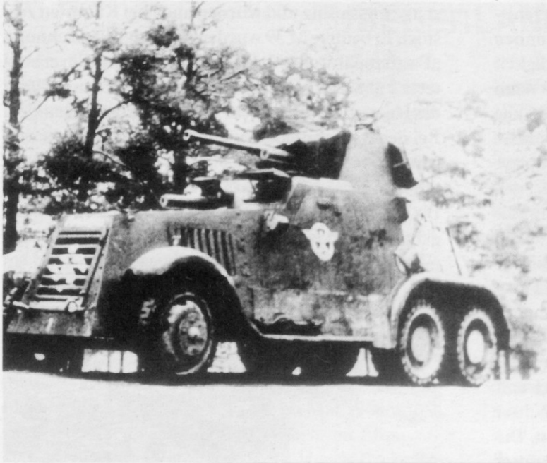
Rechts: Diese Nahaufnahme zeigt Details des Turmes und der Fahrerblende. Charakteris- tisch für die Fahrzeuge sind die dicken Ummantelungen der 7,92-mm-Lewis-MGs. Um die Geländegängigkeit der Spähwagen zu verbessern konnten Ketten auf die Räder der Hinterachsen aufgezogen werden, wie sie dieser Wagen auf den Kotflügeln mitführt.
