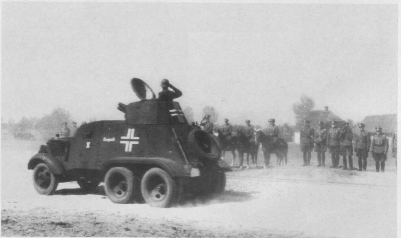
Unten: Auf den ersten Blick handelt es sich hier um einen schweren russ. Panzerspähwagen vom Typ BA-3 oder BA-6. Genauer betrachtet, handelt es sich aber um einen spanischen Nachbau des BA-6 mit der Bezeichnung "Autometralladora blindado medio Chevrolet-1937". Bei der Kanone dürfte es sich um eine frz. 3,7-cm-Kwk Puteaux handeln. Auf welchem Weg diese Fahrzeuge in den Besitz der Wehrmacht gelangten ist unbekannt. (BA)
