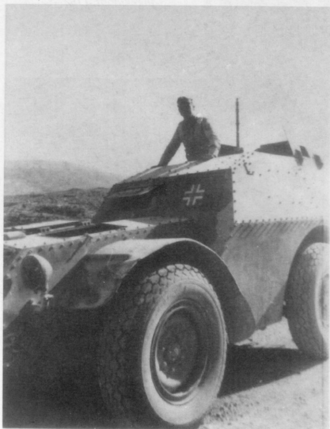
Oben und unten: Auf Basis des Radschleppers Fiat A.S. 37 ließ die italienische Armee gepanzerte Mannschaftstransportwagen bauen, die ebenfalls die Bezeichnung A.S. 37 führten. Die oben offenen Fahrzeuge hatten eine zweigeteilte Hecktür und waren mit MG bewaffnet, die hinter Steckschilde montiert werden konnten. Oben frisch erbeutete Fahrzeuge und unten im Einsatz bei der 7. SS-Gebirgs-Division. (1xBA, 2xMV)
