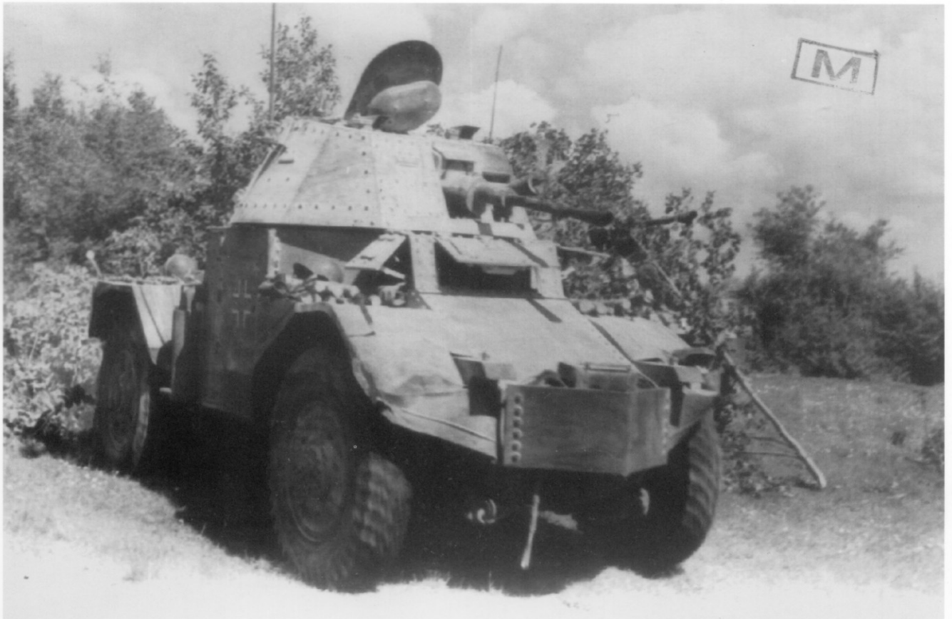
Ein Panhard Panzerspähwagen der 7. Panzer-Division bei Beginn des Rußland-Feldzuges. Das Fahrzeug ist am Bug mit einem Vorpanzer ausgerüstet, um diese senkrechte Stelle besser gegen Beschuß zu schützen. (BA)
