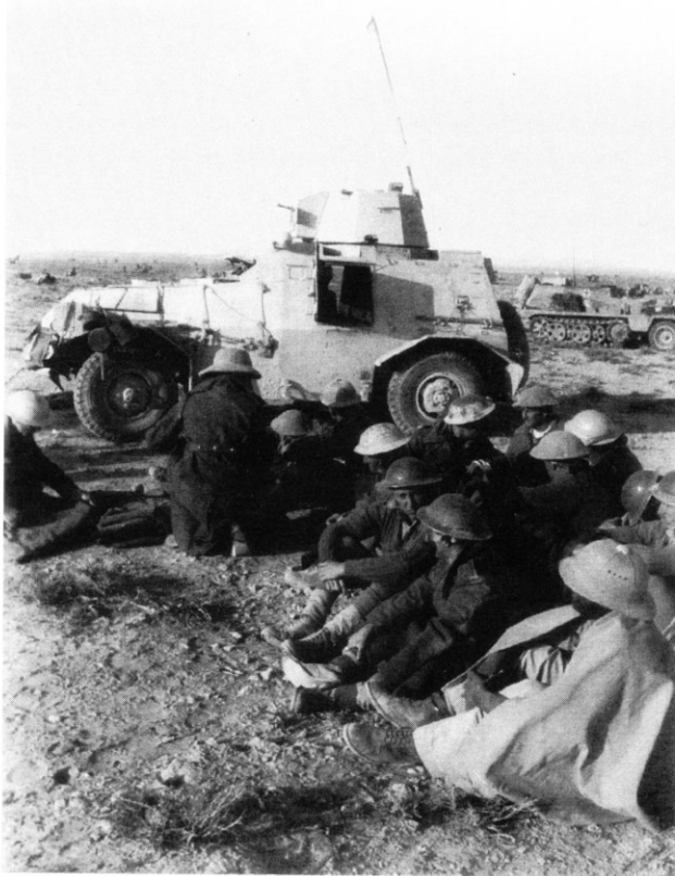
Ein frisch erbeuteter Panzerspähwagen vom Typ Marmon-Herrington Mark III. Im Turm ist als Waffe nur ein Bren-MG eingebaut, die Boys-Panzerbüchse fehlt. Die Ausführung Mark III hatte gegenüber dem Mark II einen geräumigeren Turm. (BA)
