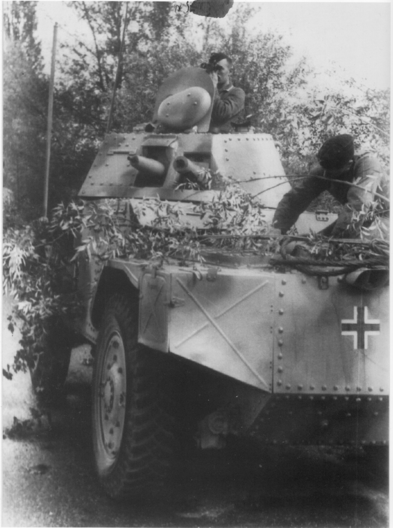
Ein Panzerspähwagen Panhard P 204 (f) in Frankreich 1943. Das Fahrzeug hat anstatt der 2,5-cm-Kanone ein zweites MG eingebaut. Solche Fahrzeuge waren den Franzosen 1940 im unbesetzten Restfrankreich belassen worden und wurden 1942 dort erbeutet. (BA)
