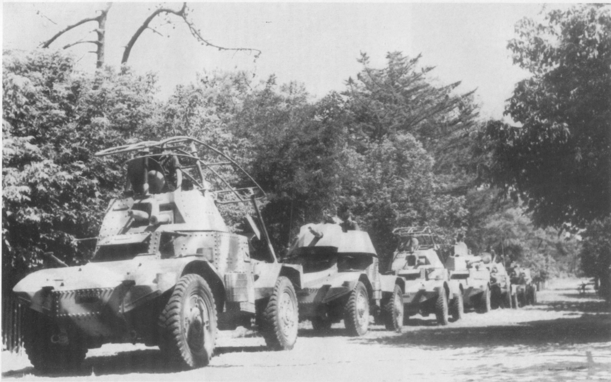
Insgesamt sieben Panhard Panzerspähwagen sind auf dieser Abbildung aus dem Jahre 1943 zu sehen. Kaum ein Fahrzeug gleicht dem anderen. Vorn ein Funkwagen mit Rahmenantenne und einem zweitem MG anstelle der Kwk, gefolgt von einem Umbau mit 5-cm-Kwk, einem Funkwagen mit Rahmenantenne ohne Kwk, einem Standardfahrzeug mit 2,5-cm-Kwk, einem Funkwagen mit Stabantenne im Originalantennenfuß vorn links, dahinter noch zwei weitere Fahrzeuge. (BA)
