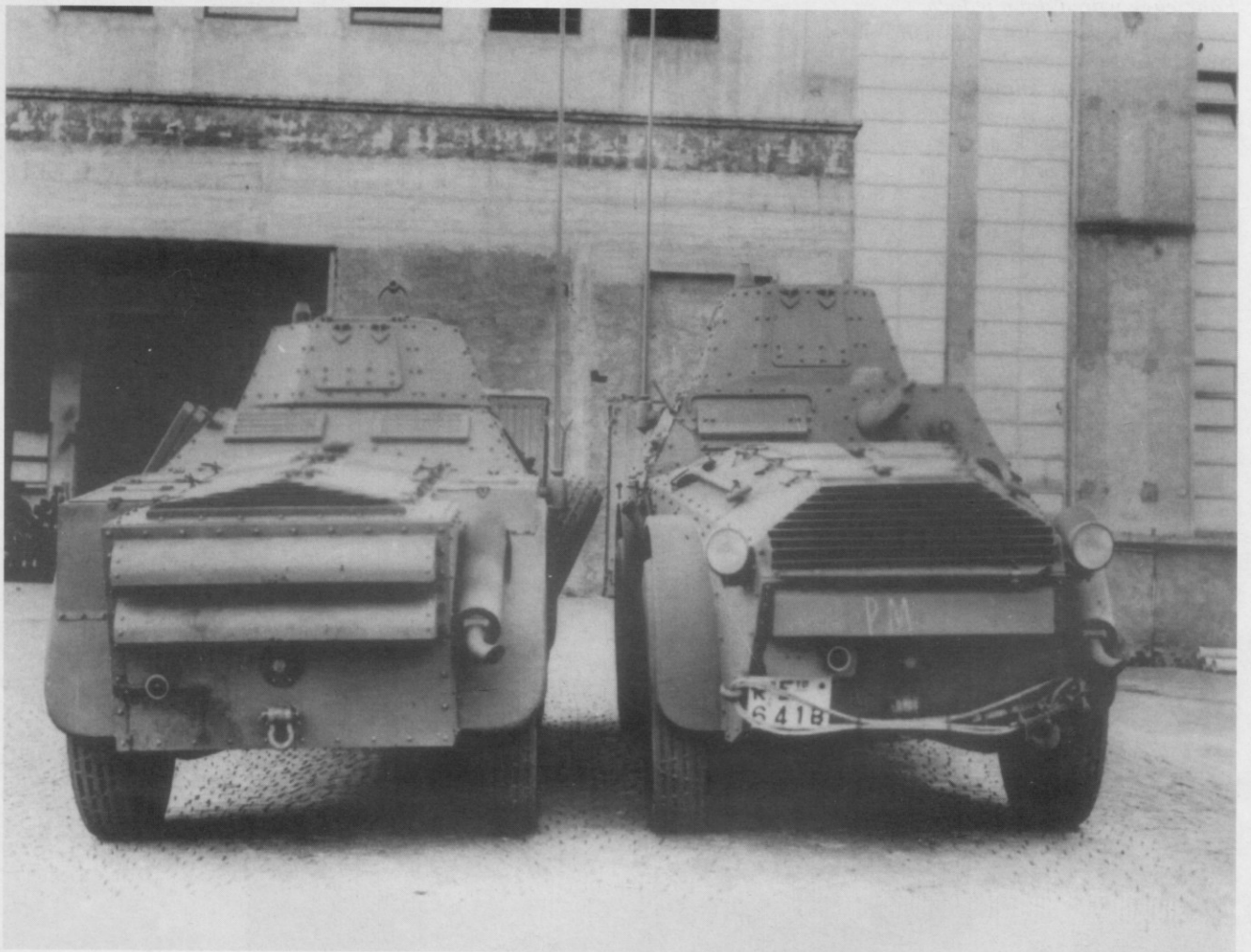
Oben und unten: Der Panzerspähwagen AB 41 (rechts) sollte 1943 durch den Typ AB 43 (links) abgelöst werden. Der Prototyp des neuen Modells hatte einen geänderten Aufbau in dem die Stützräder entfallen und die Türen nach vorne verlegt waren. Das Heck-MG entfiel und auch der Kühlergrill war abgeändert. Das Fahrzeug erhielt einen neuen flacheren aber geräumigeren Turm, in den wahlweise eine 2-cm- oder 4,7-cm-Kanone eingebaut werden konnte. (BA)
