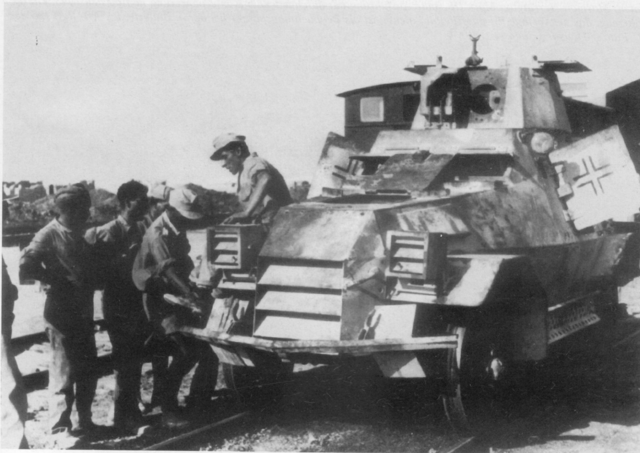
Unten: Eine besondere Ausführung des Marmon-Herrington war dieser Mark III Schienenpanzer. Dieses Fahrzeug ließ sich wahlweise für Straßen- oder Schienenfahrt umbauen, ähnlich den Panzerdraisinen Panhard. Der mit Balkenkreuzen markierte Spähwagen war auf der Küstenbahnlinie am Mittelmeer im Einsatz. (RK)
