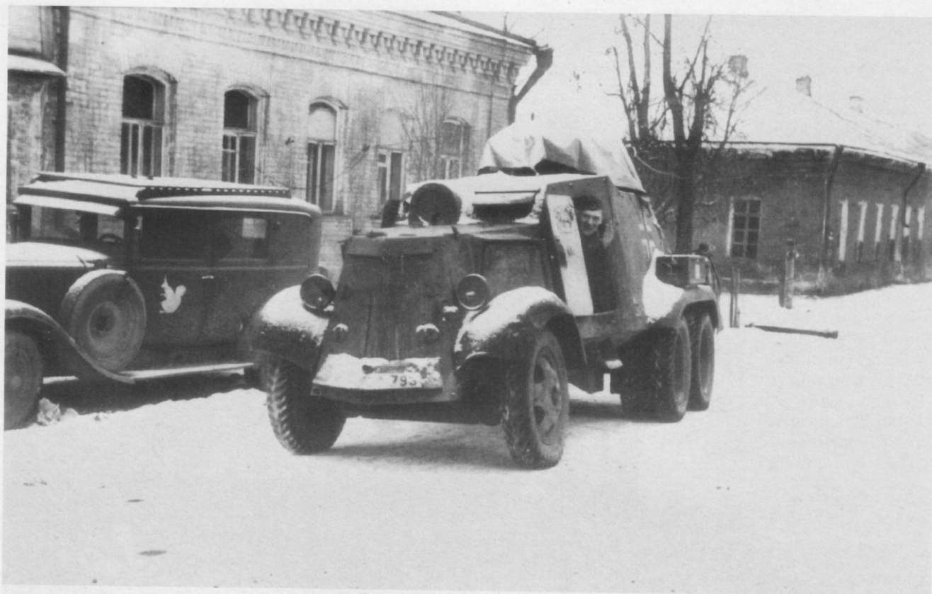
Oben und unten links: Ein weiterer spanischer Spähwagen Chevrolet-1937 eingesetzt bei der Propaganda-Kompanie 612 "Eichhörnchen". Das Fahrzeug führte die Kennung WH-690793. Diese Kriegsbericht-Spähwagen waren mit Foto- und Tonaufnahmegeräten ausgerüstet. Im Turm stand zur Eigenverteidigung ein 7,5 mm-MG Reibel zur Verfügung. Gegenüber den russischen Wagen fällt besonders die abgeänderte Motorpartie auf. (1xBA)
