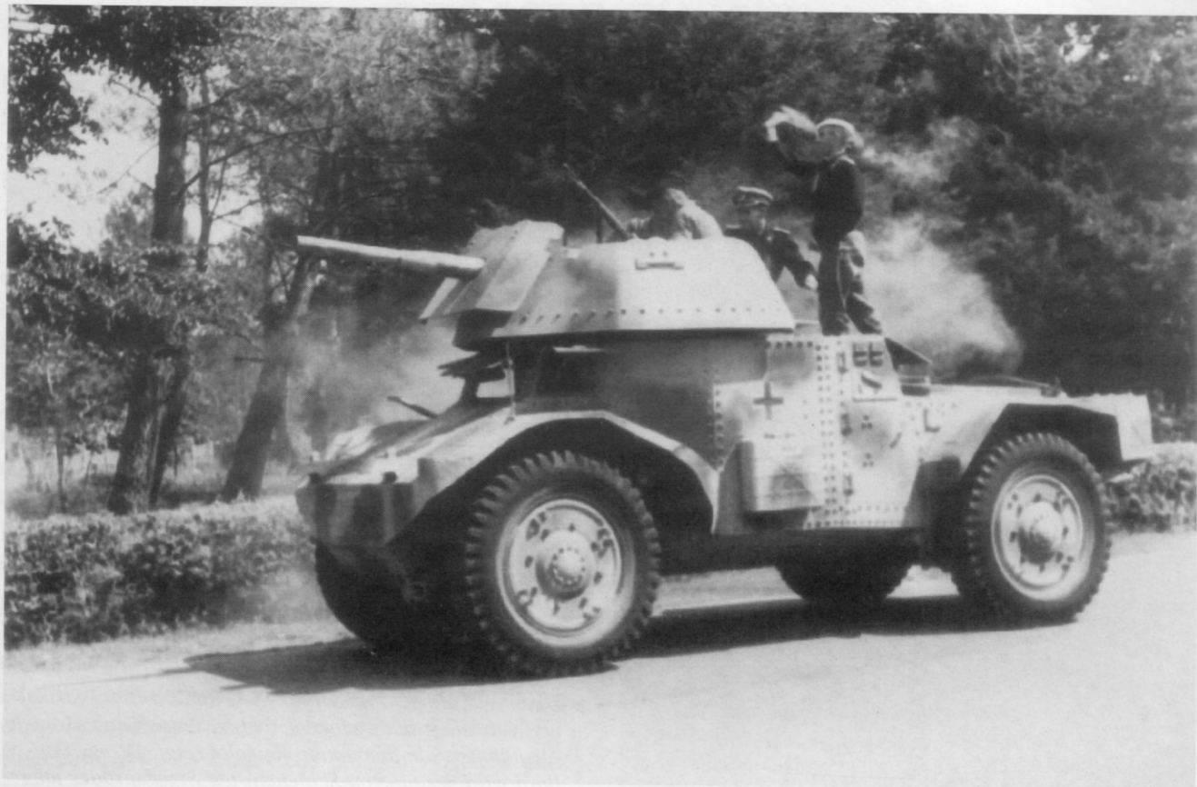
Oben und unten: Bei der Besetzung Restfrankreichs 1942 wurden einsatzbereite Panhard-Spähwagen erbeutet, bei denen jedoch die 2,5-cm-Kanone ausgebaut und durch ein zweites MG ersetzt worden war. Bei einigen dieser Fahrzeuge wurde der Turm entfernt und dafür eine 5-cm-Kwk L 42 in einem offenen Aufbau aufgesetzt. (BA)
