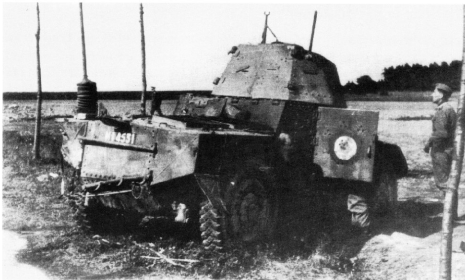
Ein erbeuteter Panhard Panzerspähwagen wird untersucht. Der Spähwagen ist mit Funk ausgerüstet, wie die Antenne links am Heck zeigt. Nicht alle französischen Panzerspähwagen waren mit Funk ausgerüstet, denn oft fehlte es noch an den Geräten. (HH)
