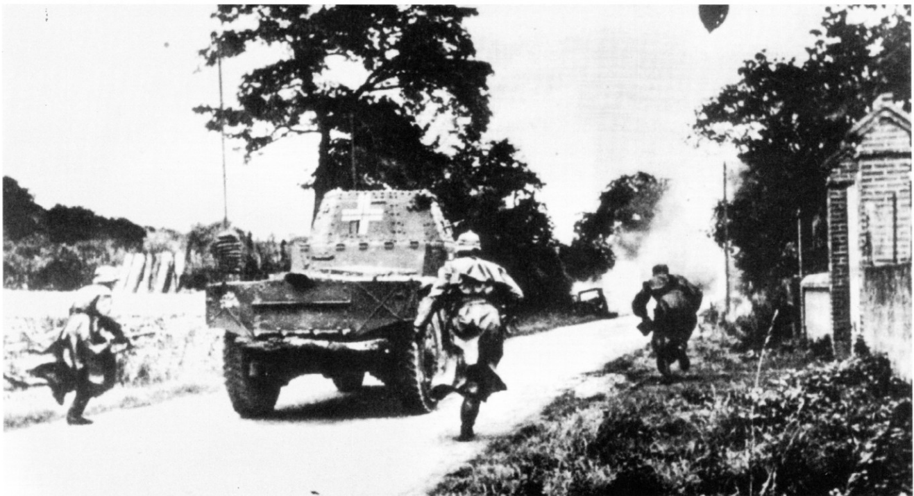
Einige Panhard Spähwagen waren anstelle des Drehturmes mit einem festen Aufbau ausgestattet und als Funkfahrzeuge ausgerüstet. Hier ist ein solches Fahrzeug mit Balkenkreuz und Divisionsabzeichen versehen, noch während des Frankreich-Feldzuges, bei der SS-Totenkopf-Division im Einsatz (MV)
