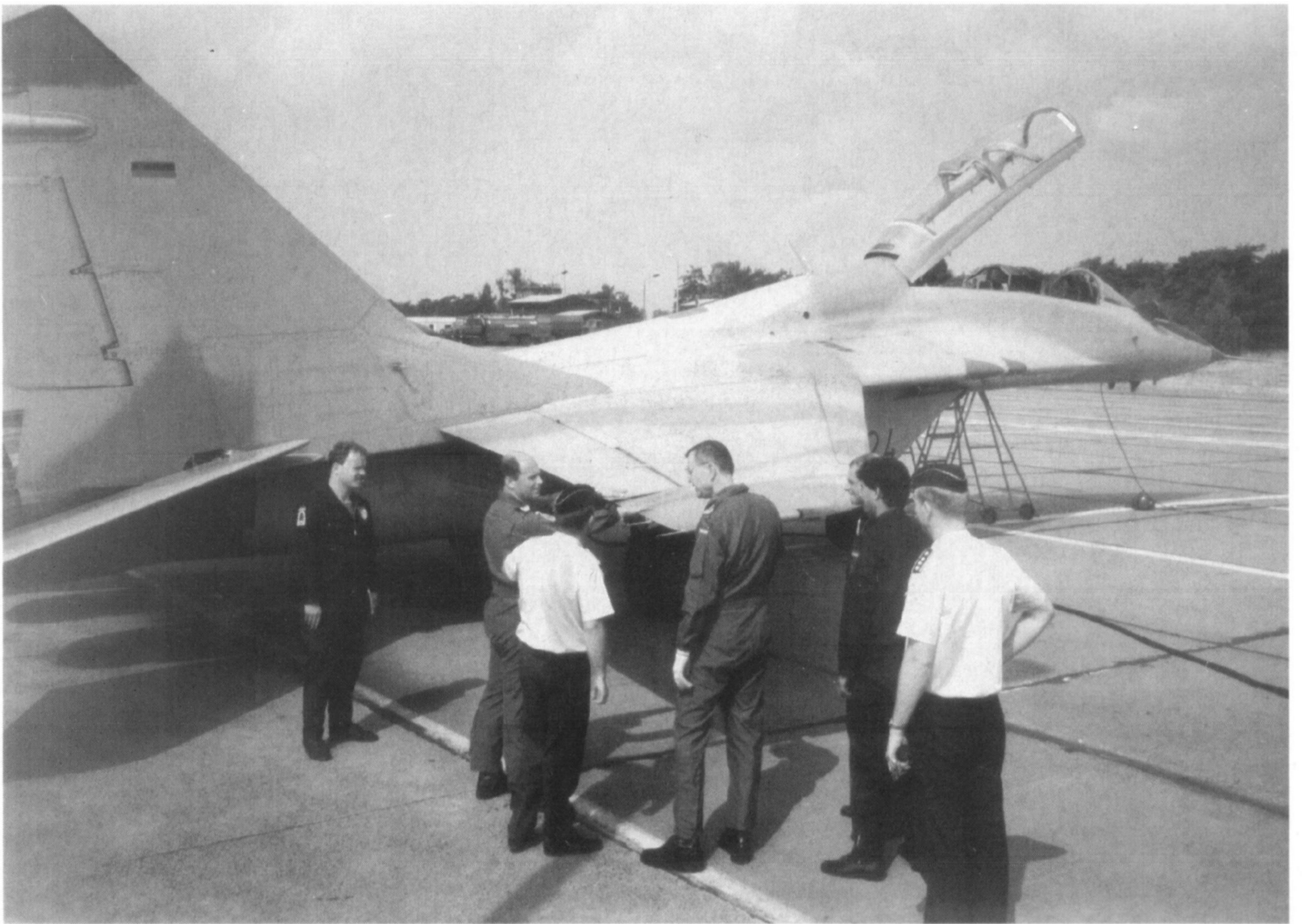
Auch hier noch der Doppelsitzer. Der Spiegel über dem Sitz des Fluglehrers klappt bei der Landung aus und verbessert seine Sicht. Gut auf dem unteren Foto zu erkennen.
