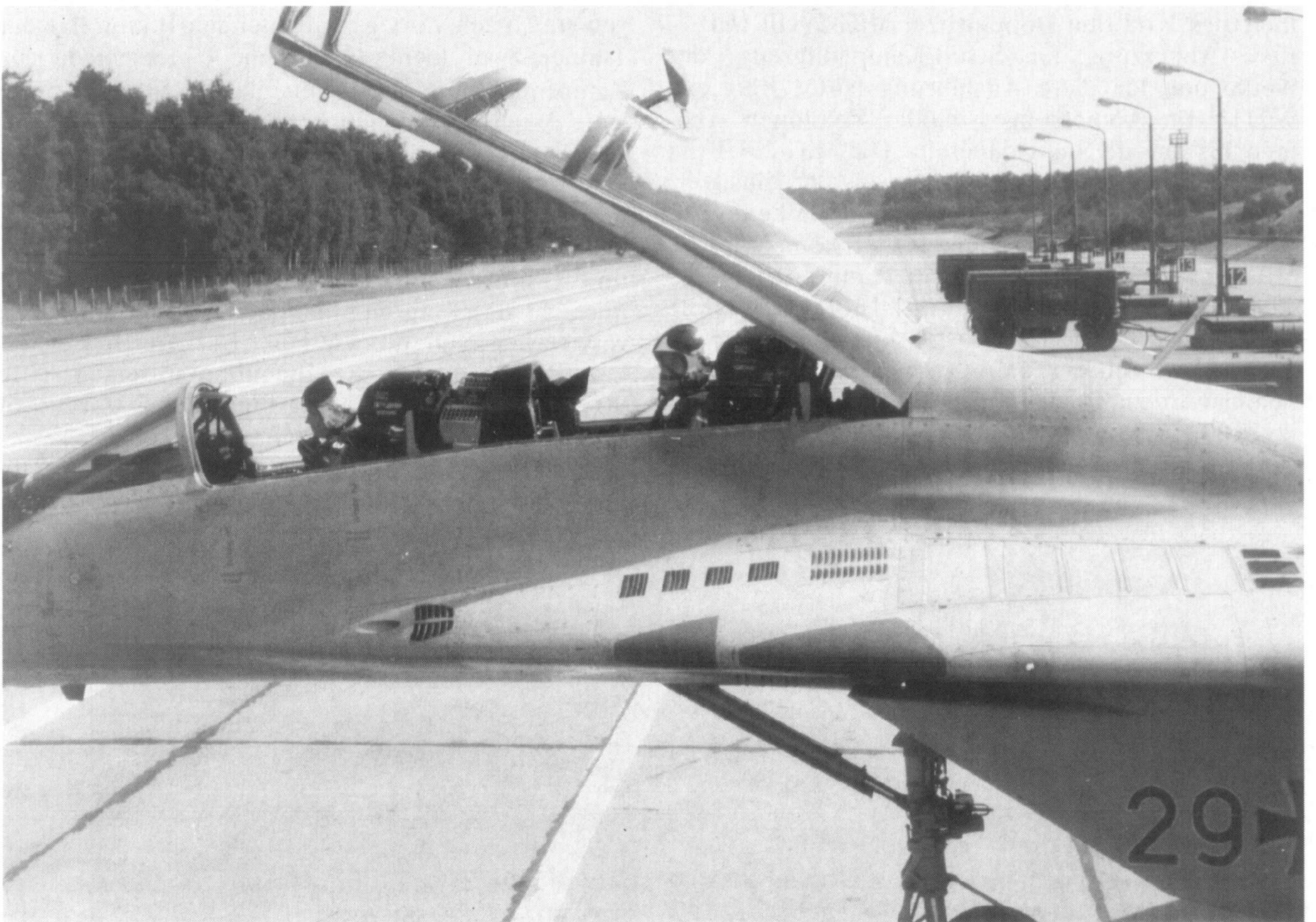
Auch hier noch der Doppelsitzer. Der Spiegel über dem Sitz des Fluglehrers klappt bei der Landung aus und verbessert seine Sicht. Gut auf dem unteren Foto zu erkennen.
