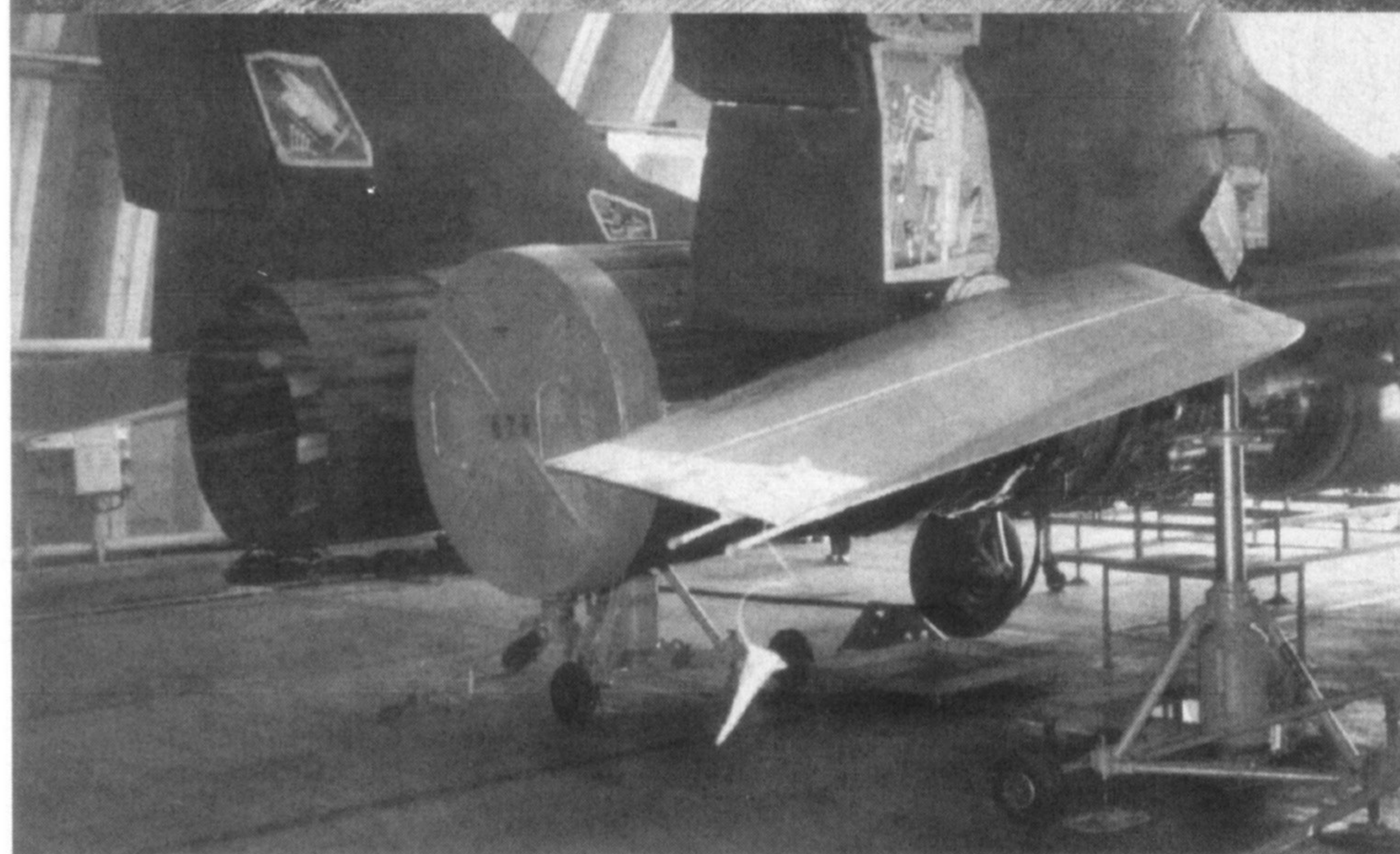
Die Triebwerksverkleidungen nach der Demontage und der Deckel, der am Boden über die Triebwerksöffnungen gestützt wird. Gut sind die Wartungsluken in den Seitenleitwerken zu erkennen.
