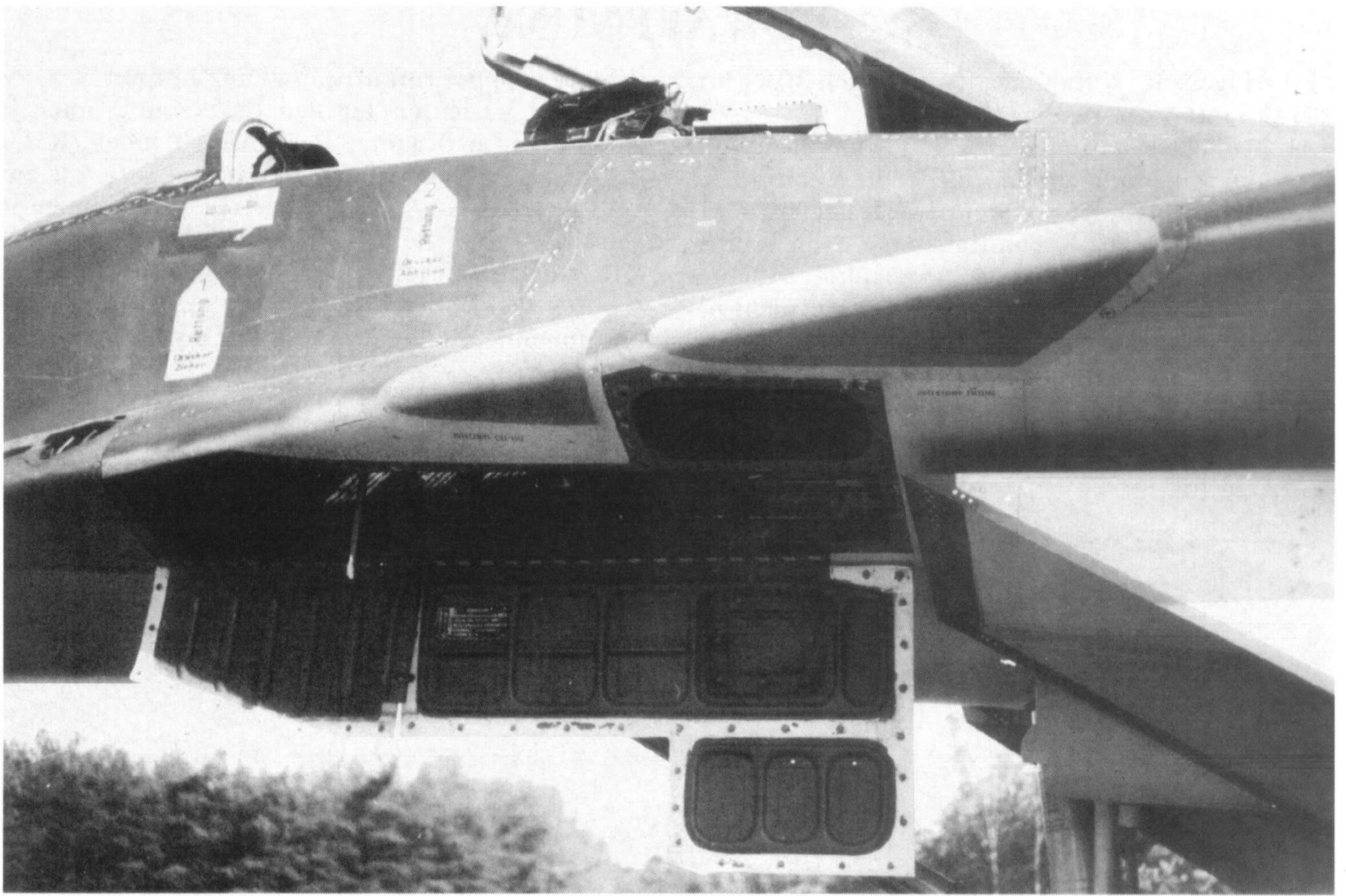
So ist der Zugang zur Kanone möglich (Blick in die geöffnete Luke von der Seite und von unten). Der effektive Schußbereich gegen Luftziele beträgt 200 bis 600 m.
