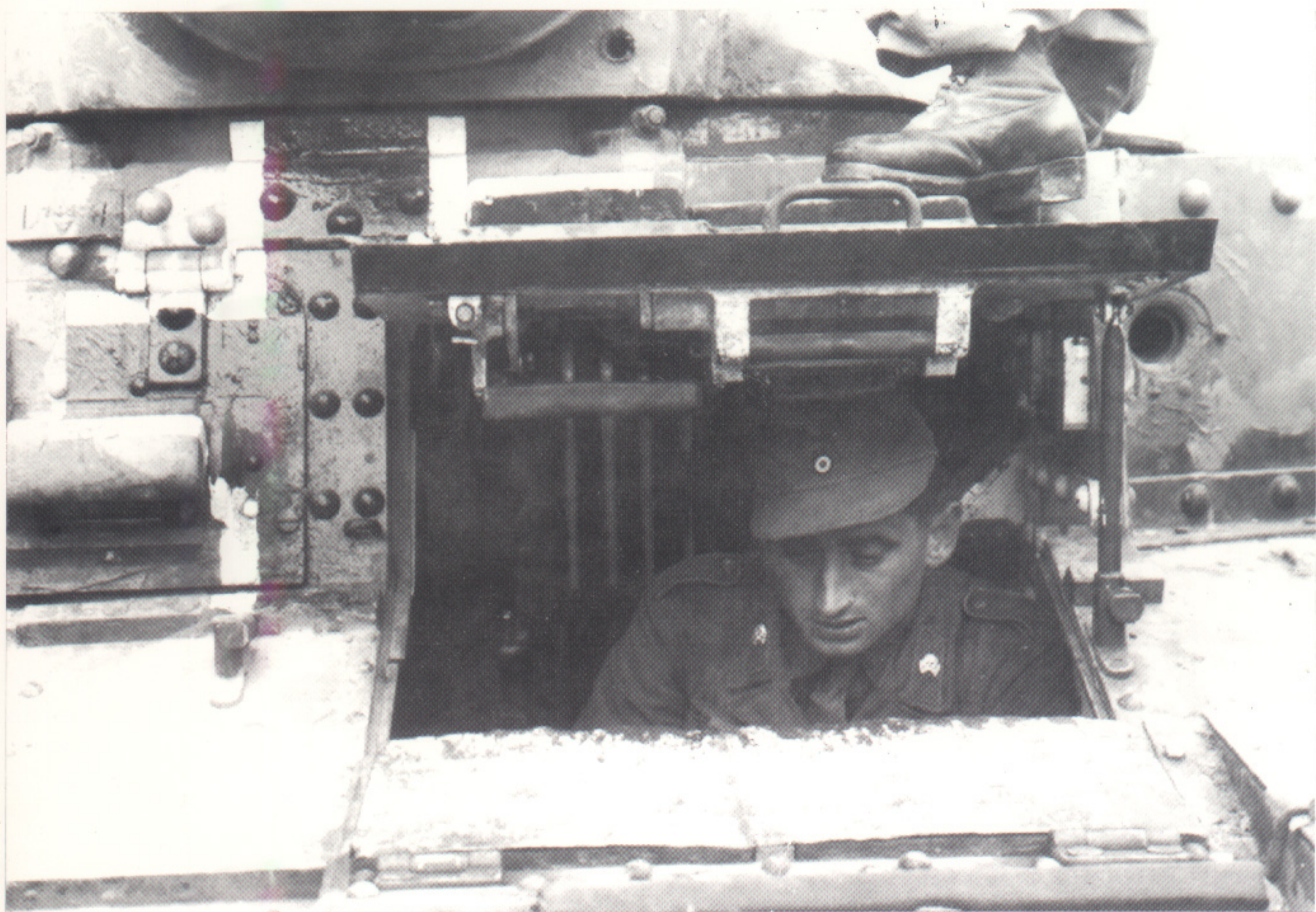
Unten: Der Platz des Fahrers in Nahaufnahme. Sehr deutlich ist rechts unter der Blende der Turmwaffen ein Einschuß zu sehen. Rechts neben der Sehklappe des Fahrers die Öffnung für ein Kasematt-MG. (BA)
