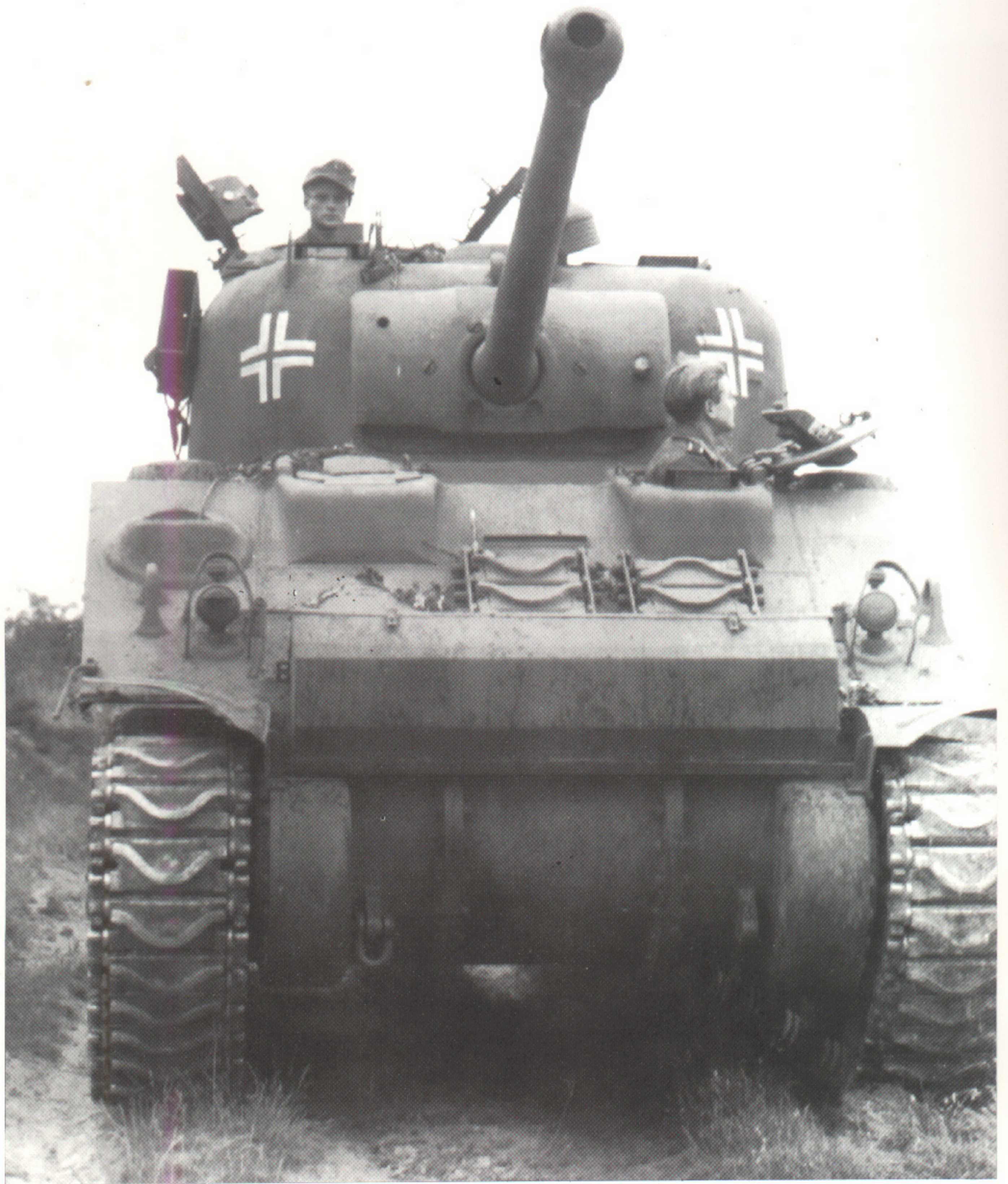
Ein Photo des Sherman VC Firefly, der als Vorlage für das Titelbild diente. Der Panzer ist vollständig umgespritzt, damit er keine englischen Kennungen mehr zeigt. Die Staukiste am Bug wurde normalerweise am Heck befestigt. Es scheint sich um eine Eigenheit dieses Fahrzeuges zu handeln. (BA)
