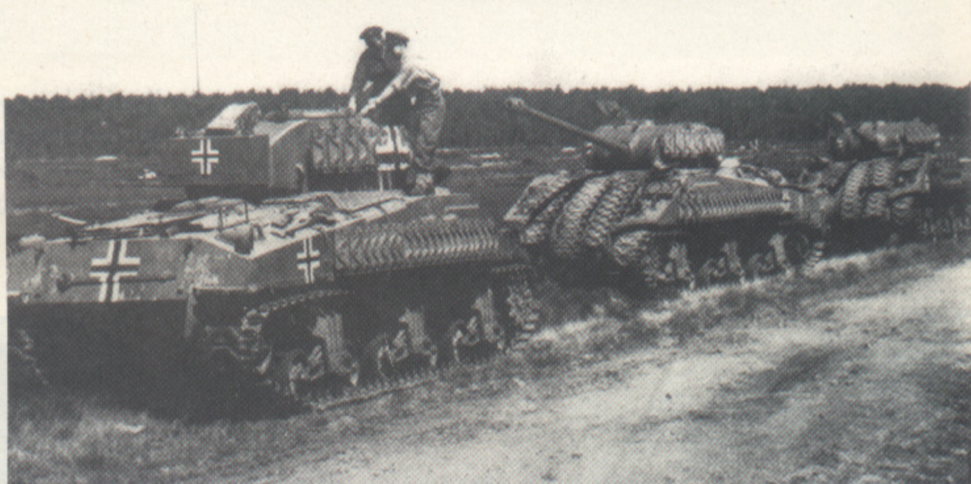
Rechts: Zwei britische Soldaten untersuchen zurückerbeutete Sherman Panzer, die an Bug, Seiten und Turm mit Kettenteilen als Zusatzpanzerung versehen sind und recht viele Balkenkreuze aufgemalt zeigen. Es handelt sich um drei ehemals britische Panzer. In der Mitte ein Sherman VC Firefly mit engl. 7,6-cm-Kanone, hinten ein M4 mit 7,5-cm-Kanone und vorn ein M4A3. (WSN)
