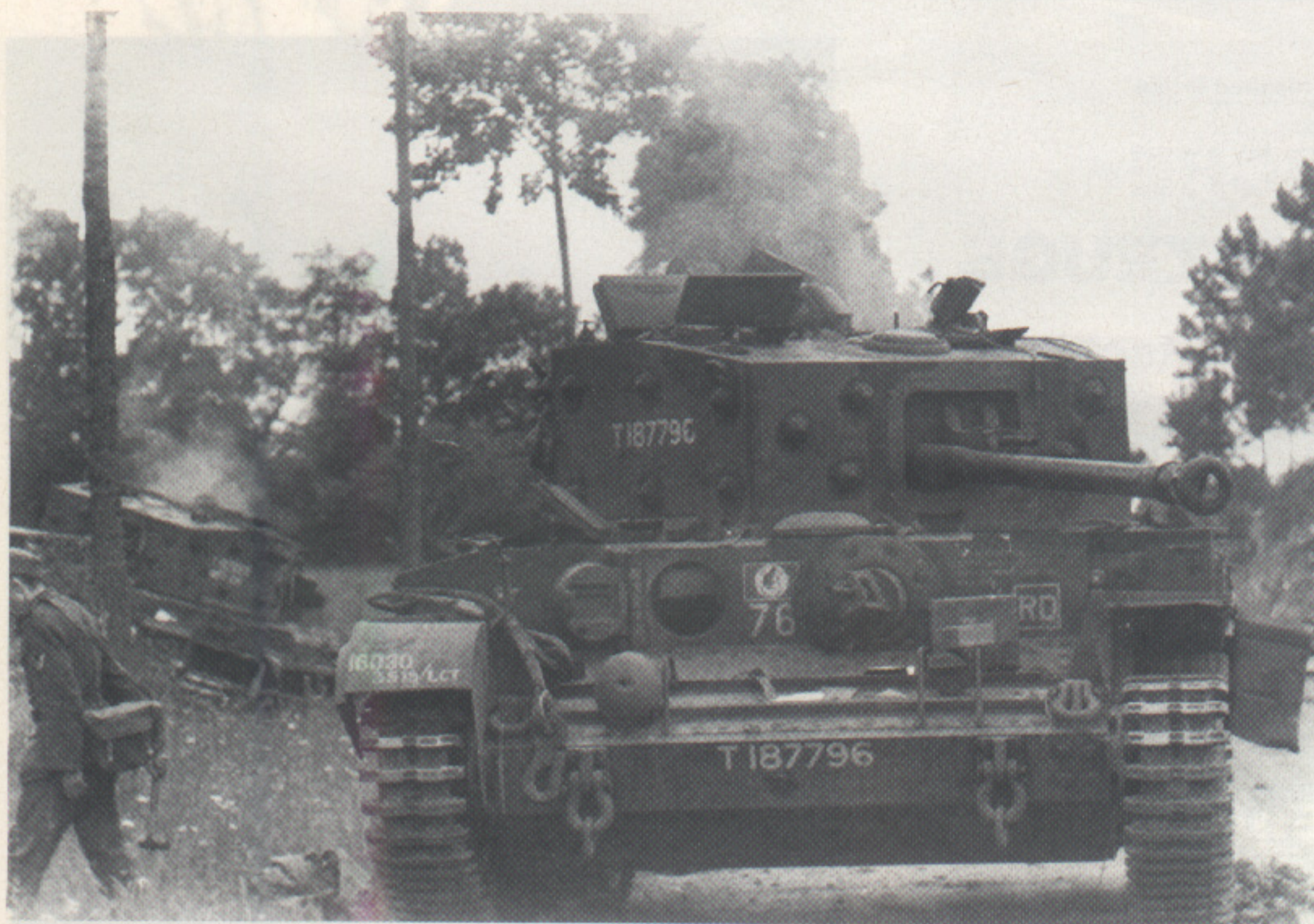
Links: Die 7. engl. Panzerdivision setzte den Kampfpanzer Cromwell in der Normandie ein. Einige fielen bei einem Angriff des 1. SS Pz. Korps in deutsche Hände. Hier ein Cromwell mit 7,5-cm-Kanone und Kennung T. 187796. (BA)
