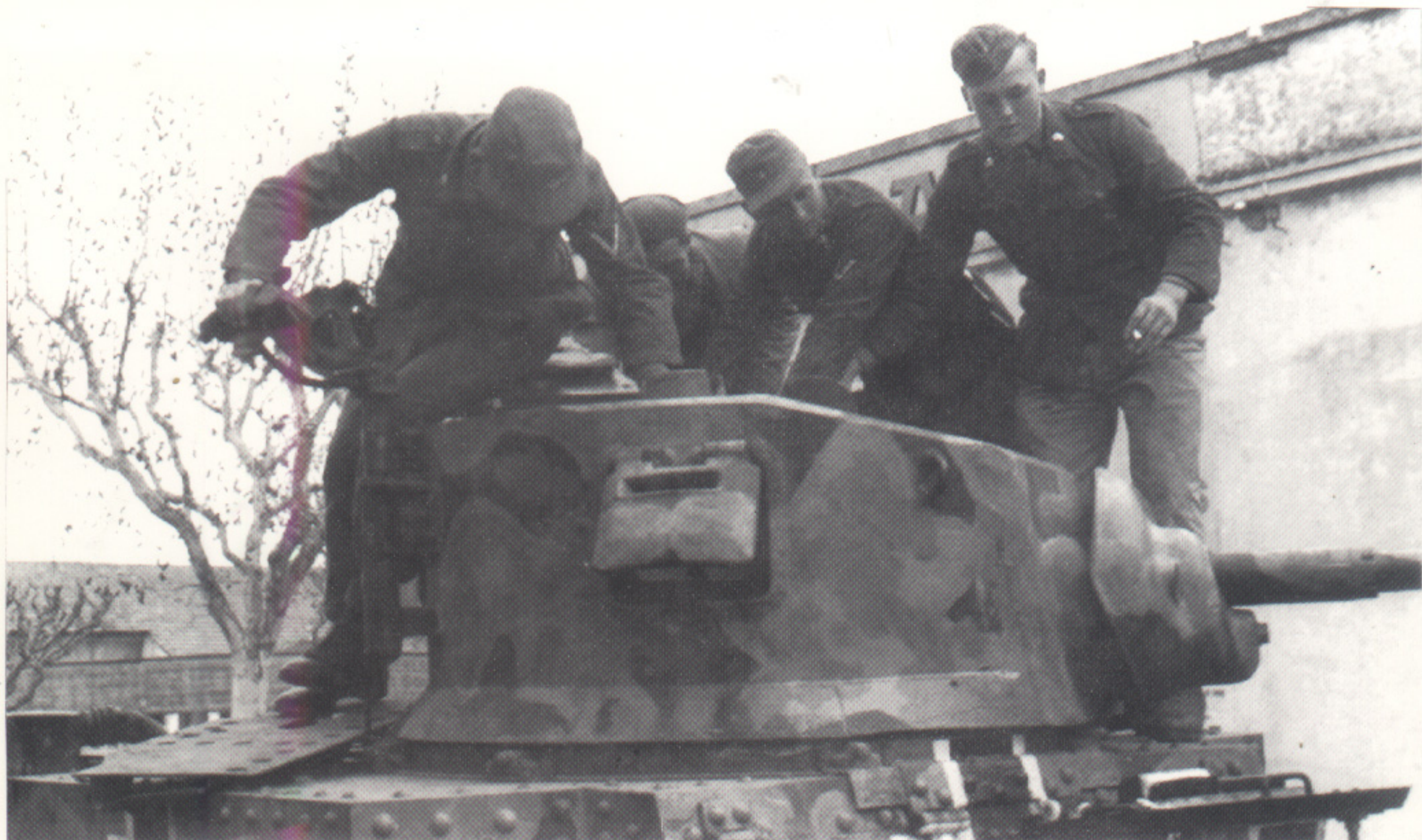
Oben: Der Turm eines in Tunesien erbeuteten M3A1 mit der Halterung für das Flugabwehr-MG. Die Ausführung M3A1 hatte keine Kommandantenkuppel mehr. (BA)
