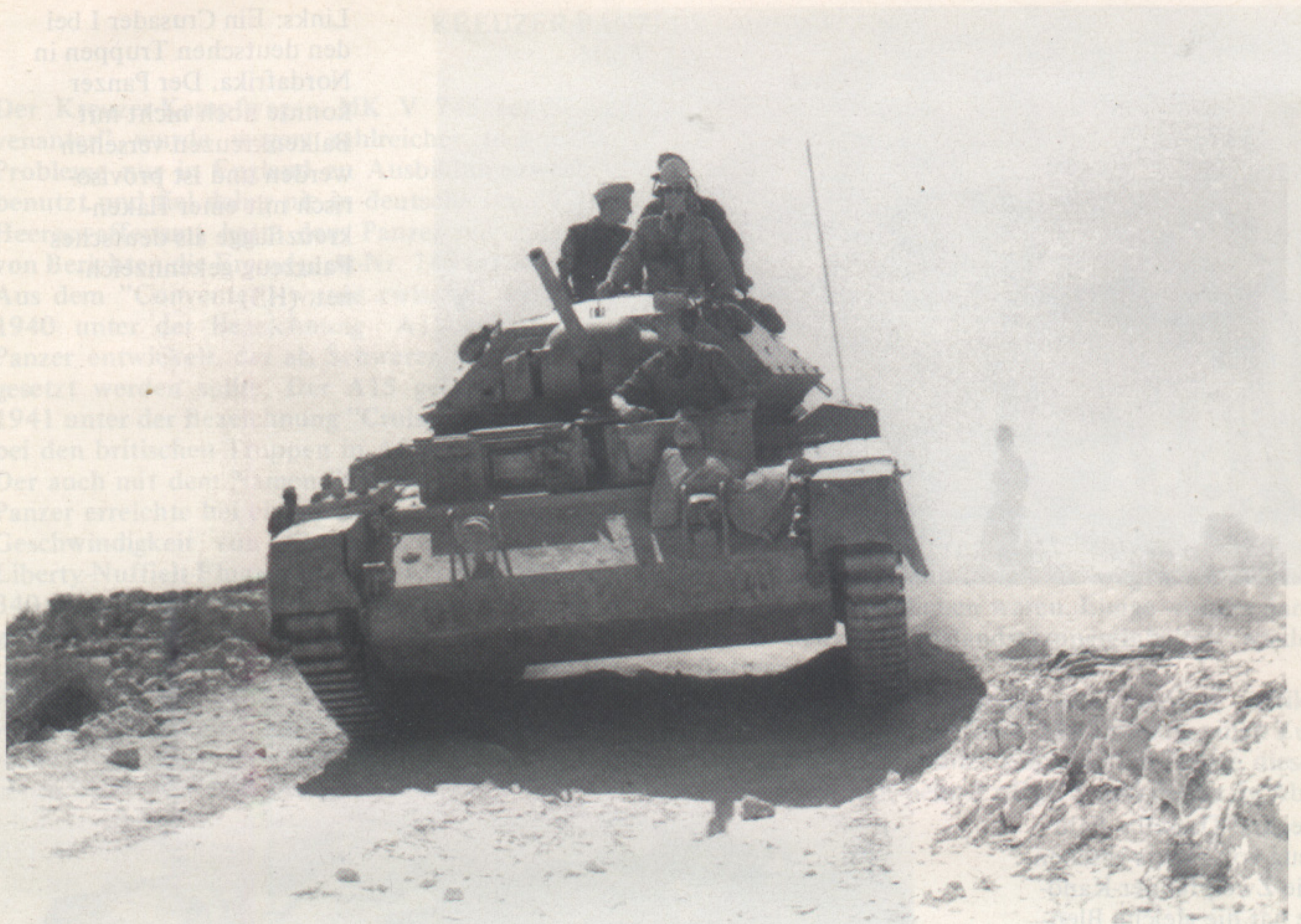
Oben: Ein Crusader II mit deutscher Besatzung auf dem Marsch. Der Crusader II hat eine geänderte Waffenblende am Turm, aber immer noch die zweipfündige Kanone als Hauptwaffe. Nur die ersten Modelle dieser Ausführung waren noch mit dem MG-Turm ausgestattet. (BA)
