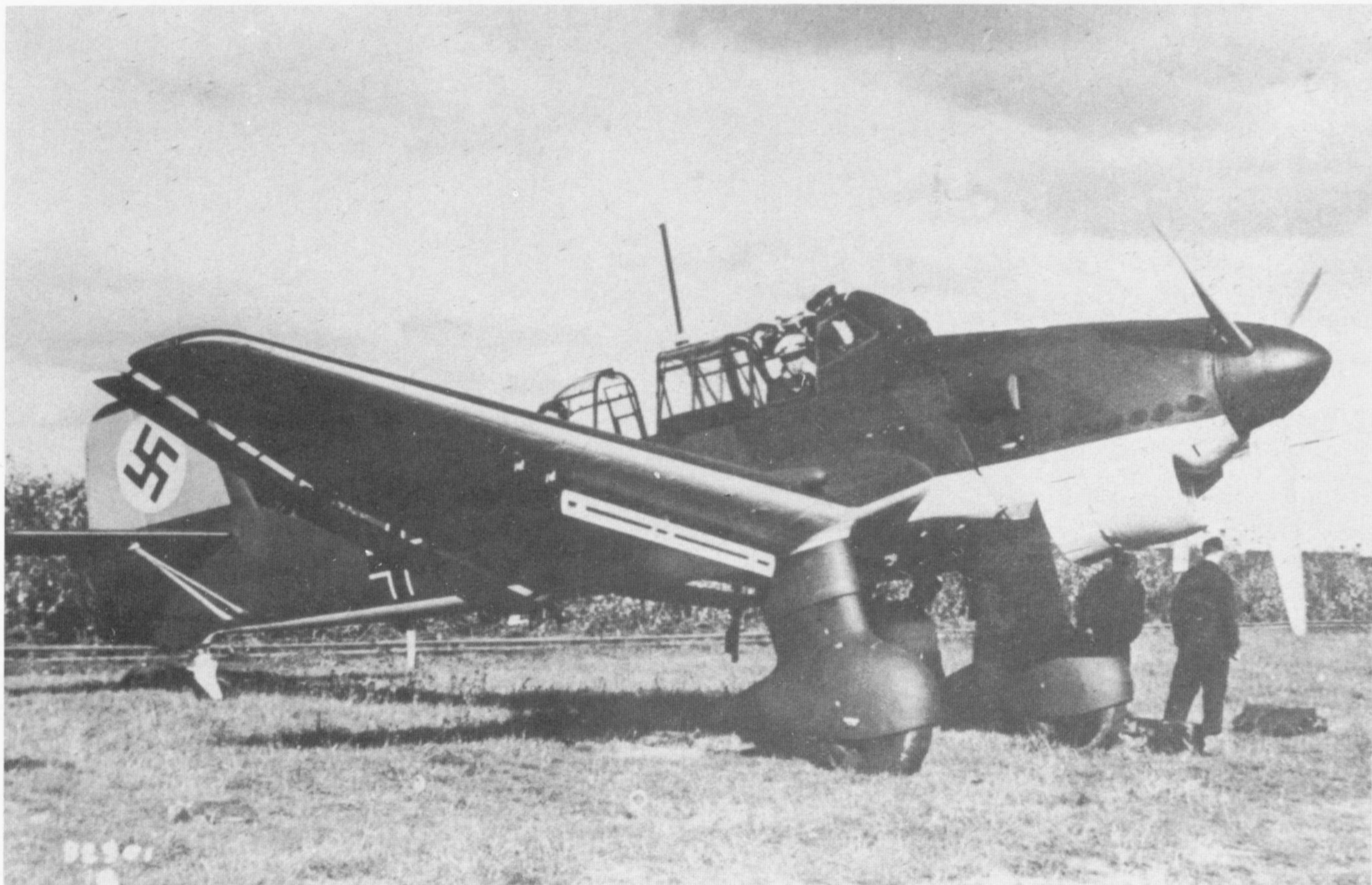
Unten: Einflugbetrieb mit der Ju 87 B-1. Gut sichtbar die ausgefahrenen Sturzflugbremsen.
