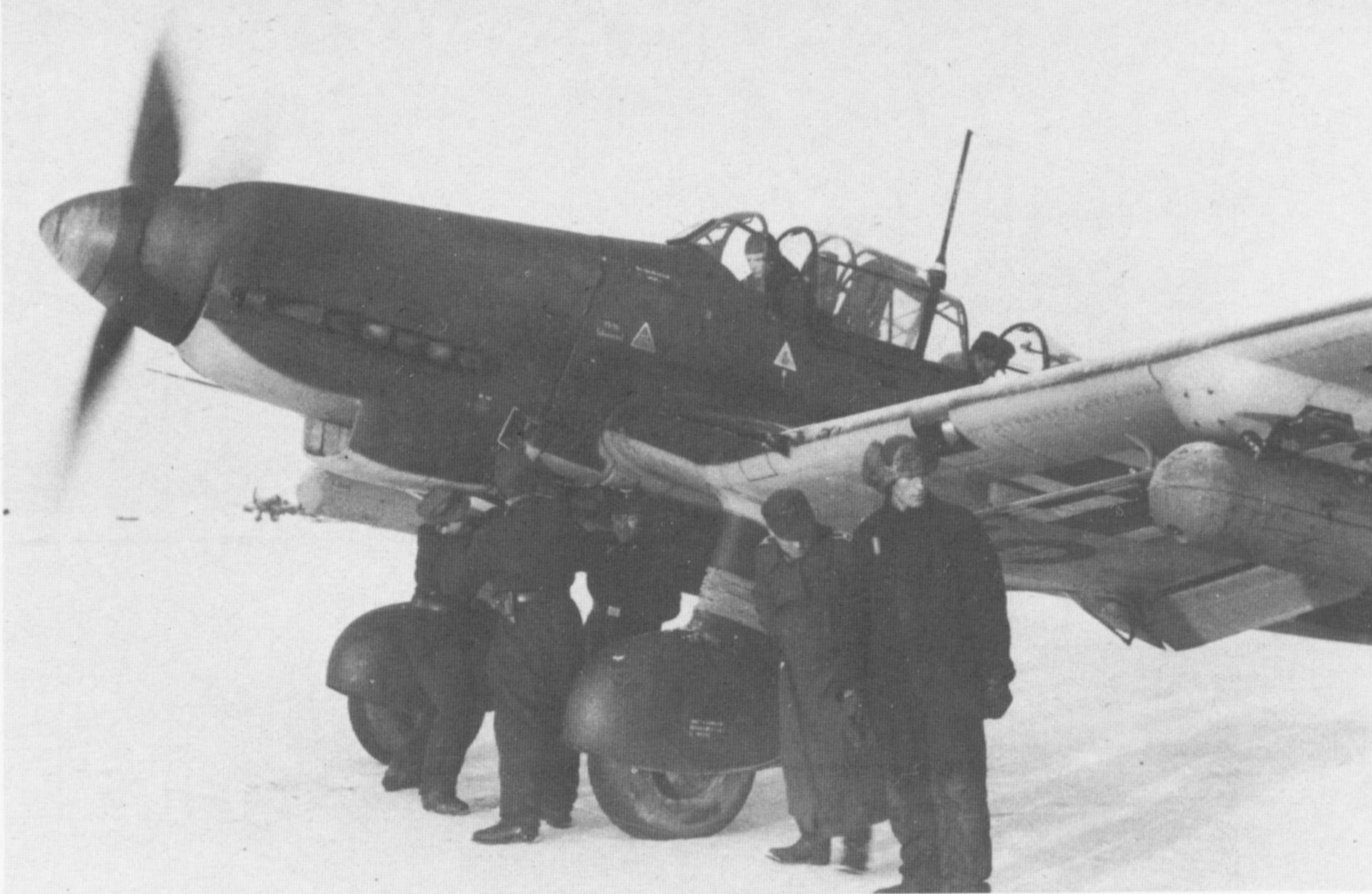
Diese Ju 87 D-5 trägt eine Sprengbombe und zwei Abwurfbehälter (AB) 250.
