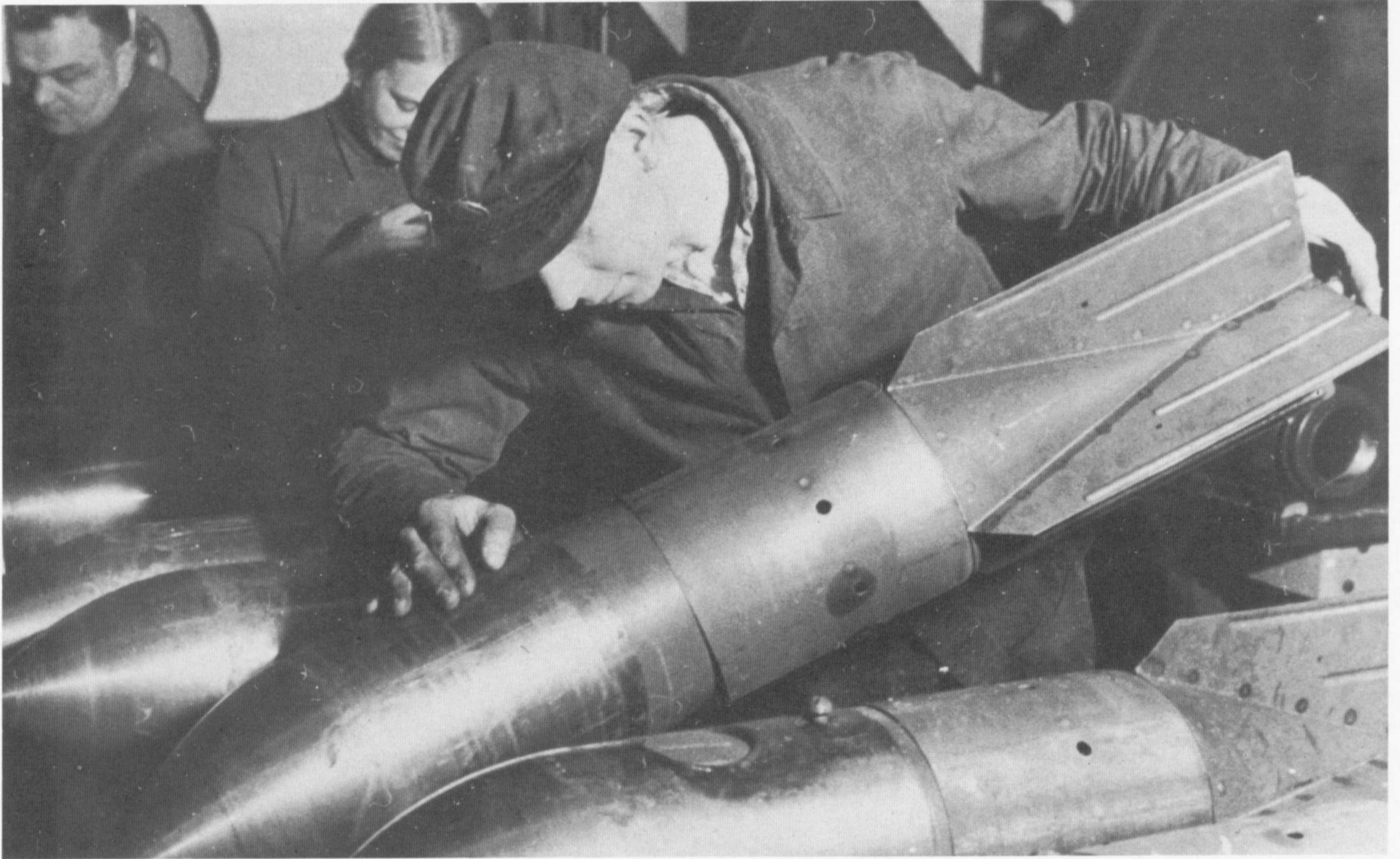
Oben: Endkontrolle bei der SC 50-Bombenpro- duktion.
