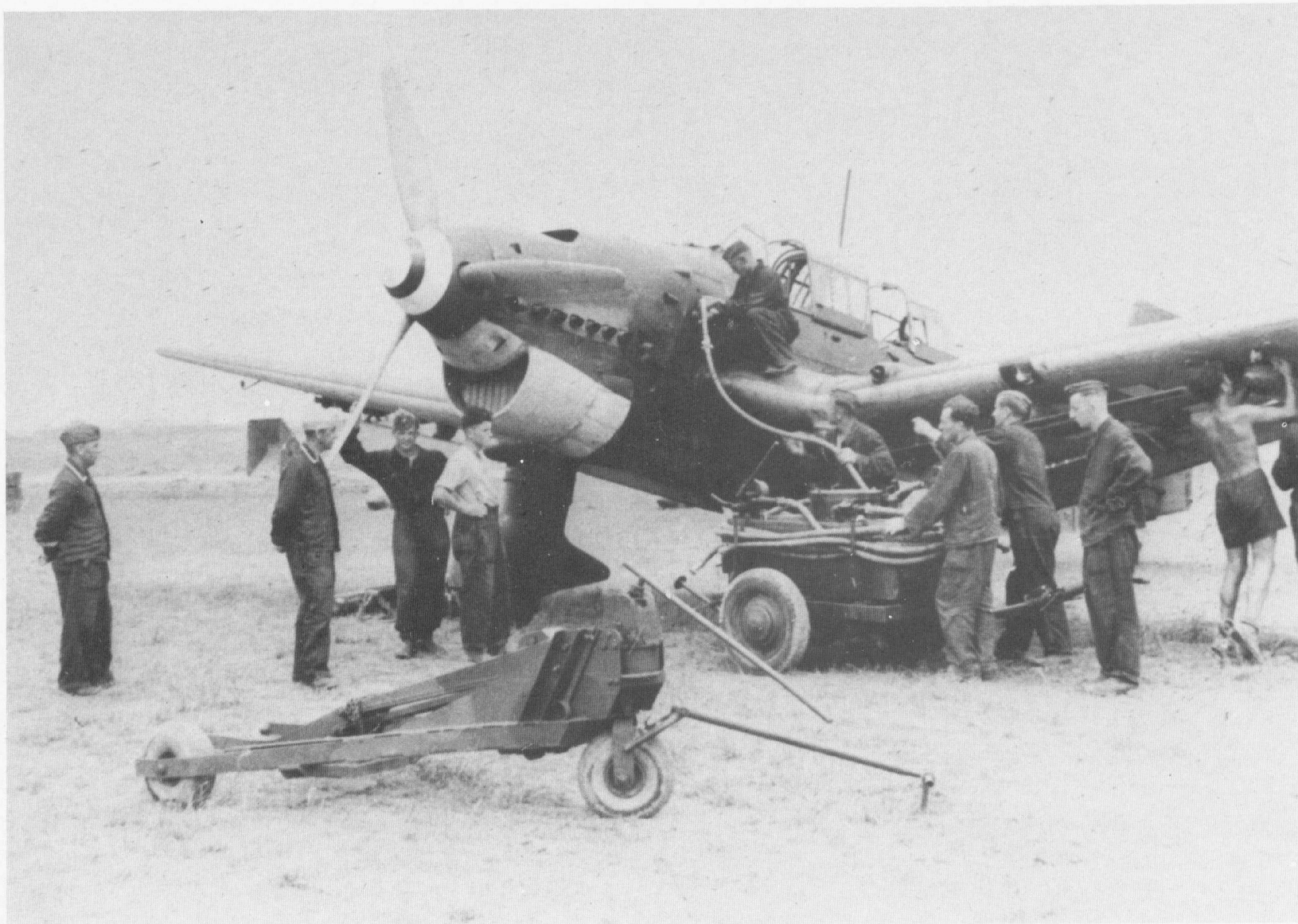
Oben: Eine modifizierte Ju 87 B-1, die zu den ersten ihrer Baureihe gehörte und zwischenzeitlich verbesserte Kühlerklappen erhalten hat.
