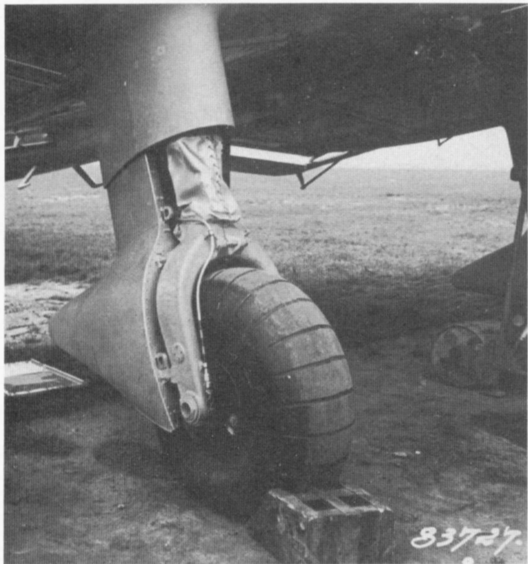
Oben: Eine Nahaufnahme des Ju 87 B-Hauptfahrwerks mit teilweise abgenommener Verkleidung. Gut sichtbar: Bremsölleitung und der lederne Schutz, der eine Verschmutzung verhindern sollte.
