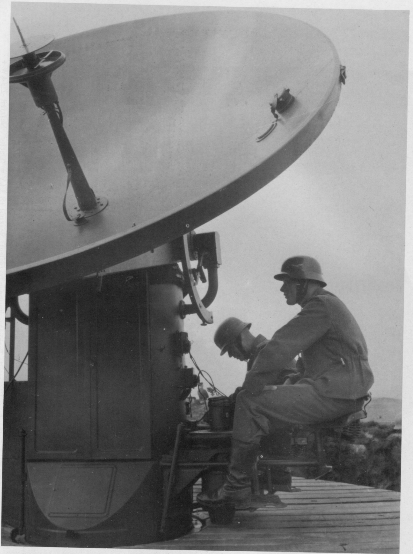
Das "Würzburg C"-Gerät hatte eine rotierende Antenne und ein neues Sichtgerät ANG 62. Am inneren Spiegelrand ist einer der Kenndipole mit der Schutzkappe zu sehen. Am äußeren Spiegelrand erkennt man eines der beiden Schnappschlösser, mit denen die beiden Spiegelhälften verbunden wurden. Von den Bedienungsleuten sitzt der B6 vor dem Höhengradbogen und der B5 am Seitenteilkreis, um bei Ausfall des Übertragungsgerätes 37 die Werte fernmündlich zu dem angeschlossenen Kommandogerät oder Scheinwerfer zu übertragen.
