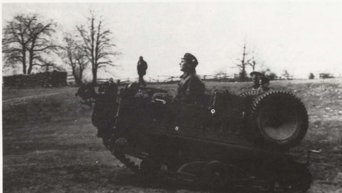
Oben: MG-Karrette ADMK mit reinem Ket- tenantrieb. Vordersitz und Vorderachse sind hochgeklappt, die vier Räder sind am Heck angebracht. Beachte Andre-Kurbel des Heckmotors.
