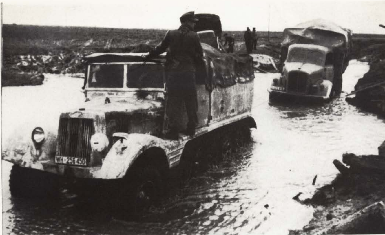
Oben: Ein leichter Zugkraftwagen 3 t (Sd.Kfz.11) (WH 256 450) schleppt einen Lkw der Waffen-SS (SS 255 858) durch eine "Wasserstraße".
