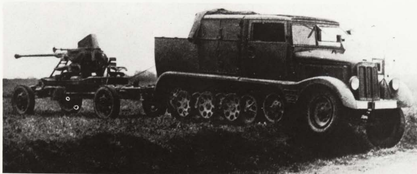
Unten: Ein ungarischer Lizenzbau des Sd.Kfz. 11 mit vergrößertem Munitionsraum, festem Dach und einer 4cm-Oerlikon-Kanone.
