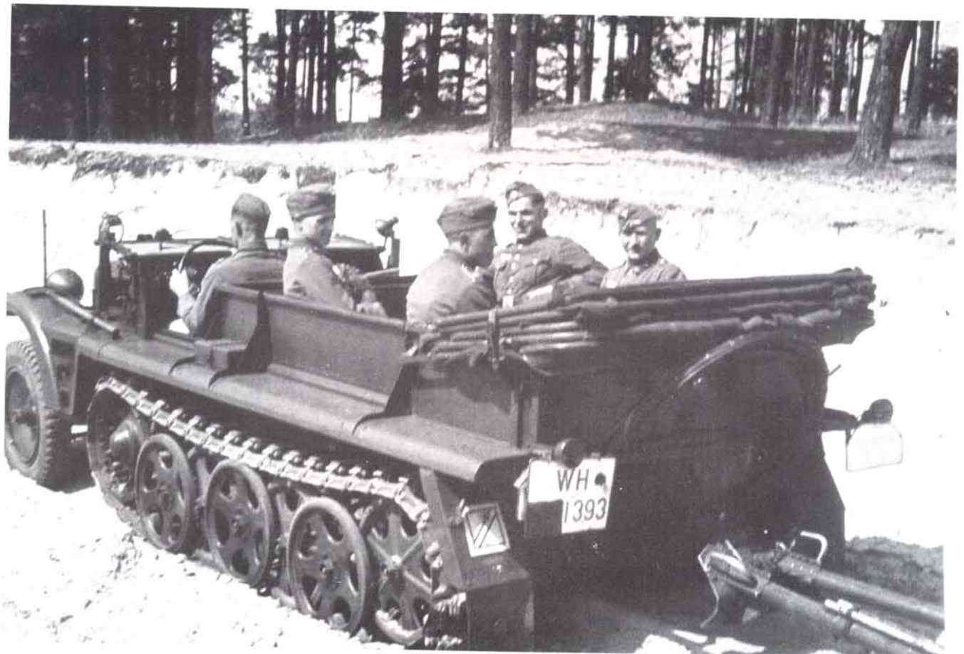
Leichter Zugkraftwagen 1 t (Sd.Kfz.10) mit 3,7 cm Pak im Übungsgelände; ein Fahrzeug der Adlerwerke. Gut ist neben dem Fahrer die Führungsschiene für die versenkbare Einstiegsklappe zu sehen. Am Heck eine Rolle Sperrdraht, der nur gegen Radfahrzeuge und sehr leichte Panzer wirksam war. (Achilles)
