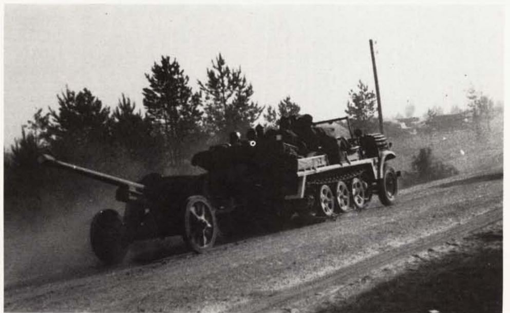
Panzerjäger der 18.I.D. (mot) bei Wilna, Juni 1941: Sd.Kfz.10 mit 5 cm Pak 38. Die meisten Fahrzeuge dieser Division hatten die Auspuffabdeckung in Gitterausführung. Beachte den hohen Gepäckbehälter hinter dem Fahrer.
