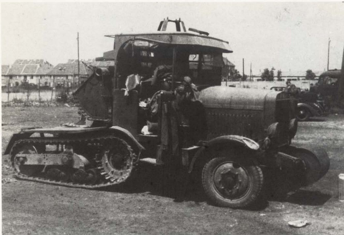
Oben: Erbeuteter französischer Protzkraftwagen für schwere Artillerie, Somua MCG 11. Dieses Fahrzeug wurde für die Wehrmacht meist mit einem Pritschenaufbau versehen.
