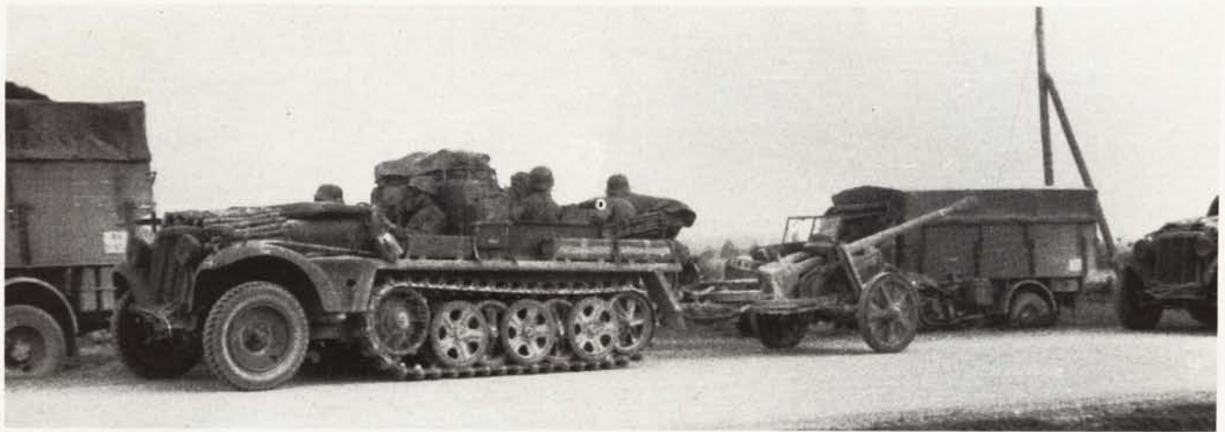
Panzerjäger der 18.I.D. (mot) bei Wilna, Juni 1941: Sd.Kfz.10 mit 5 cm Pak 38. Die meisten Fahrzeuge dieser Division hatten die Auspuffabdeckung in Gitterausführung. Beachte den hohen Gepäckbehälter hinter dem Fahrer.
