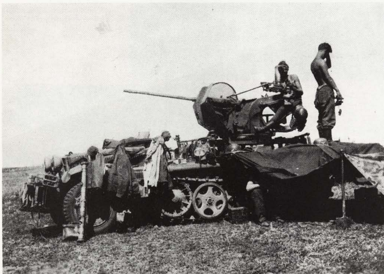
Unten: Ein Sd.Kfz.10/4 sichert am Dnjepr-Übergang bei Dorogobusch. Der Entfernungsmesser Em 1m R36 lehnt am Vorderrad.
