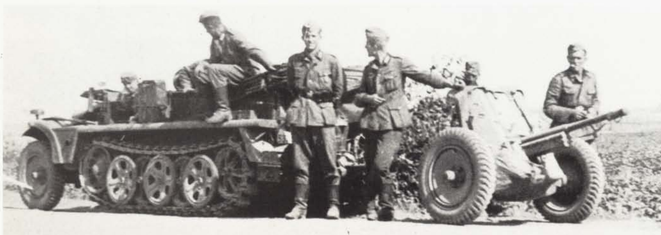
Oben: Sd.Kfz.10 mit 3,7 cm Pak der 14./I.R.51 nach der Kesselschlacht von Smolensk 1941 an der Rollbahn bei Duchowitschina. Leitrad mit Doppelrippen, Laufräder mit Verstärkungsrippen.
