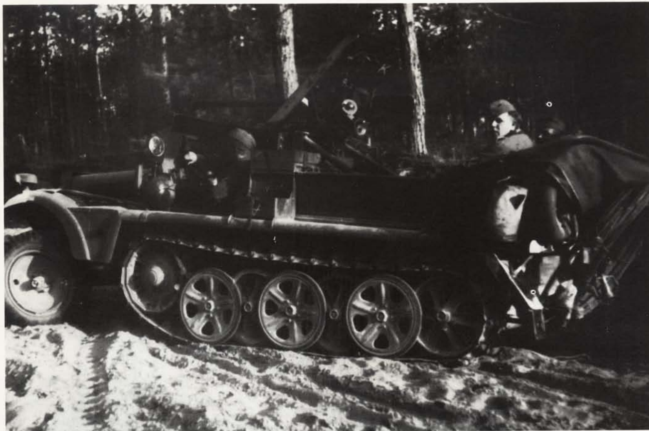
Oben: Ein Sd.Kfz. 10 mit feldmäßig aufgebauter 3,7 cm Pak der 18.I.D.(mot) auf dem Weg zur Düna bei Polosk, Anfang Juli 1941. Gut zu erkennen: Kühlerschutz, Fahrerpanzerung, Geschützabstützung, gitterförmige Schalldämpfer-Verkleidung und seitlich angebrachte Div.-Abzeichen ("Verpflegung gestrichen").
