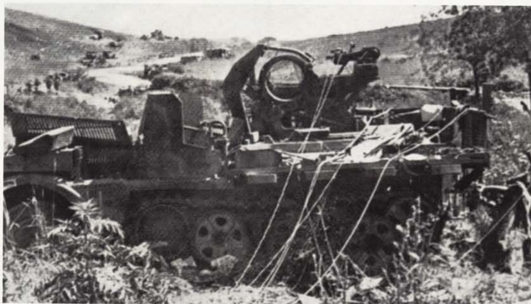
Rechts: Italien 1944: Lie- gegebliebener 1- Tonner mit 2 cm Flak 38, Kara- binerkasten und Fahrer-Panzer- Schutz.
