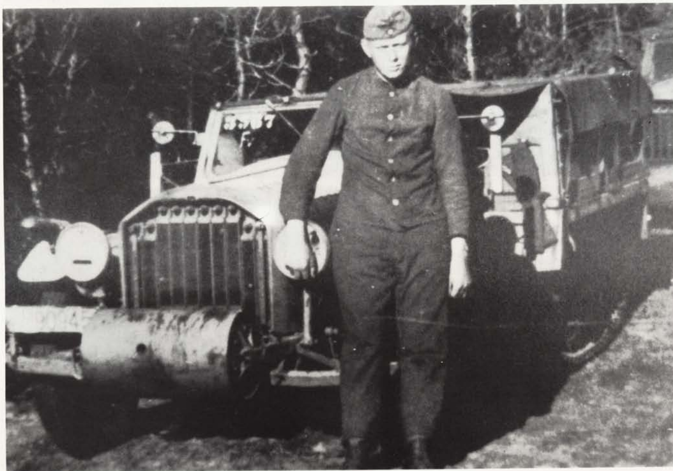
Unten: Die französische Firma Unic in Puteaux stellte bis zum deutschen Einmarsch nur etwa 250 Zugkraft- wagen des Typs TU 1 her. Darum sind Aufnahmen dieses Fahrzeugs, das bei der Wehrmacht als "Zgkw U 305 (f)" lief, selten.
