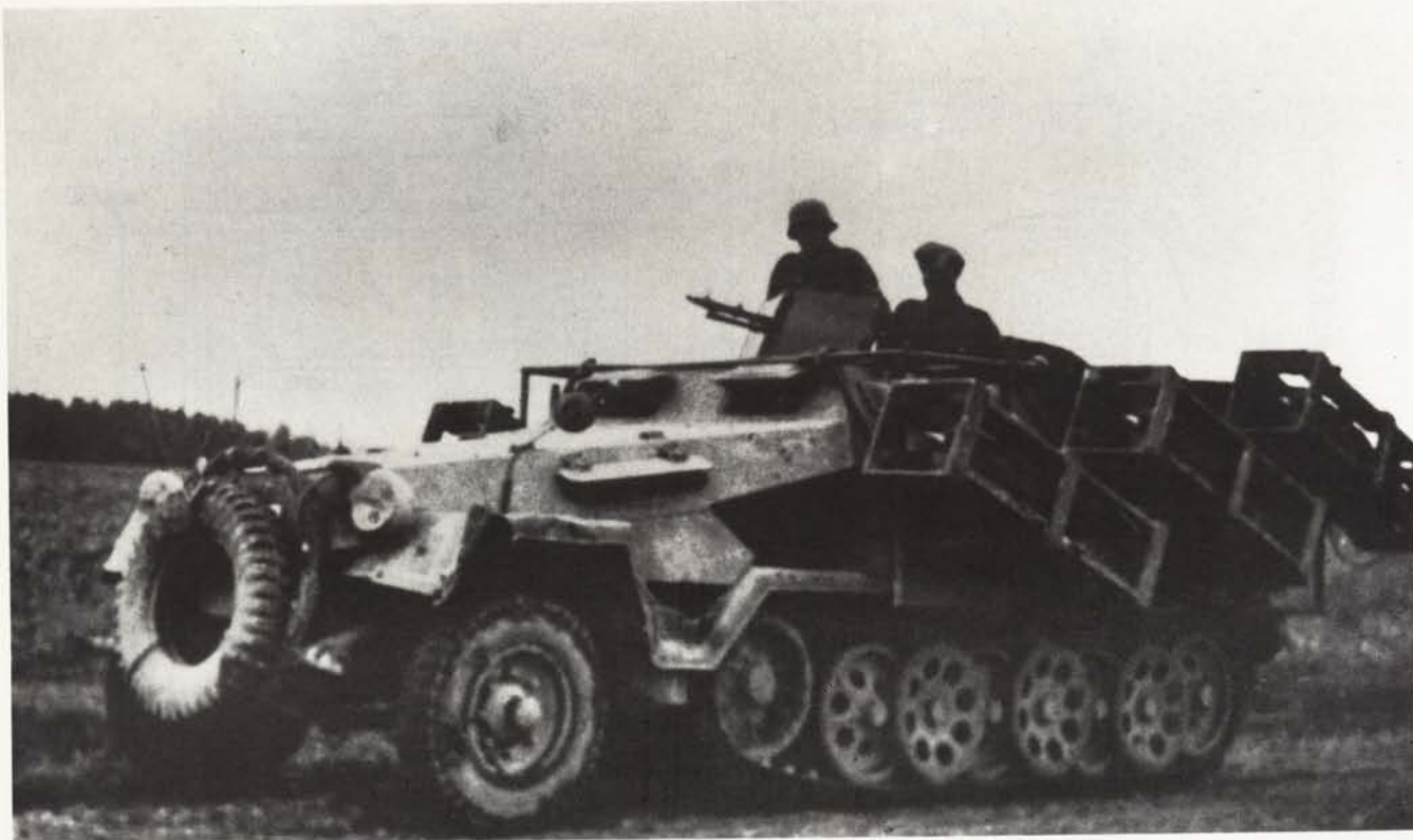
Oben: Die gepanzerte Ausführung des 3-Tonnners: Mittlerer Schützenpanzerwagen Sd.Kfz. 251/1 Ausf. B mit Wurffrahmen 40 des Pz.Pi.Btl. 16.
