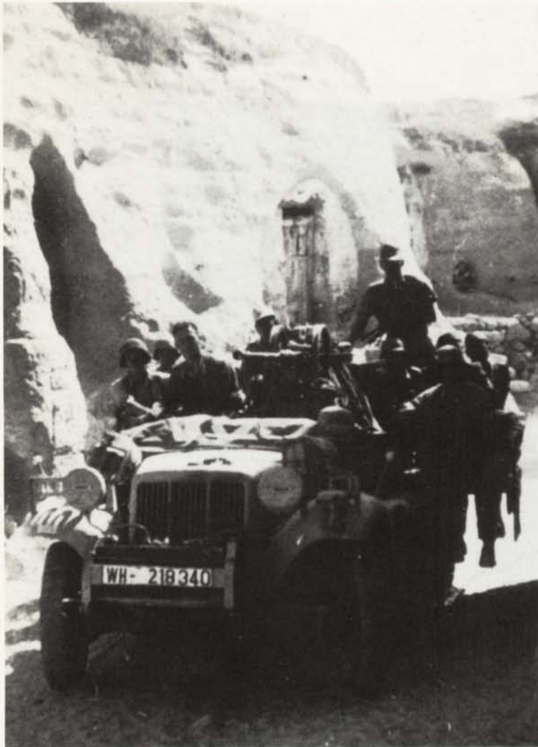
Links: 2 cm Flak 38 auf Zugkraftwa- gen 1 t der Abt. von Koenen in Tunesien im Dez. 1942. Si- cherlich ein Sd.Kfz.10/4 trotz der neuen Flak. Die Vor- spur entspricht keinesfalls den Angaben des Herstellers!
