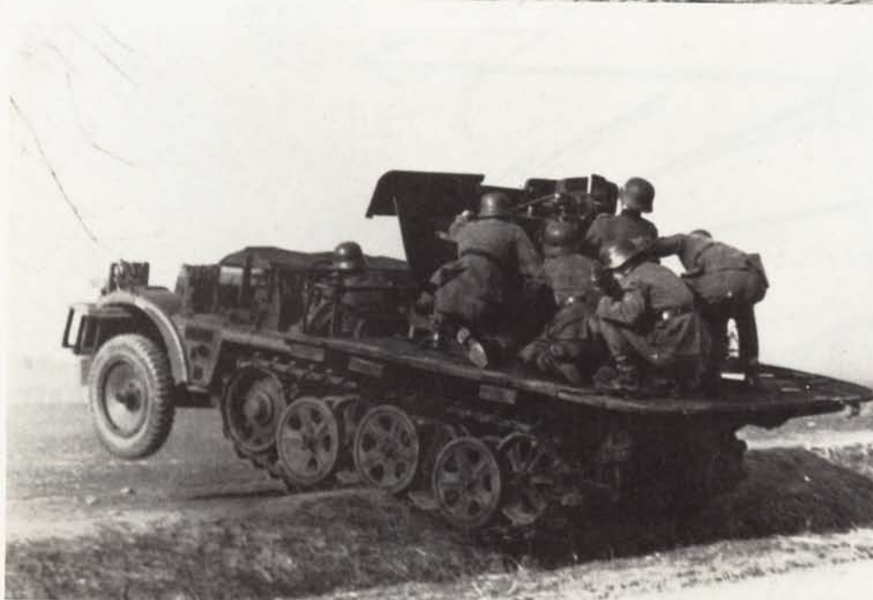
Links: Sd.Kfz.10/4 (WH 516 132) der Heeres-Fla bei einer Gefechtsübung. Das Geschütz ist mit einem abklappbaren Schutzschild zur Ver- ringerung der Sicht- höhe im Erdkampf versehen.
