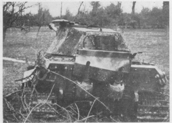
Oben: Dieser verlassene Tiger zeigt die rückwärtige Luke des Turmes – hier noch ein Porsche-turm. Durch sie wurden die Patronengranaten geladen und im Bedarfsfall (Reparaturen) konnte hierdurch die Kanone herausgezogen werden.
