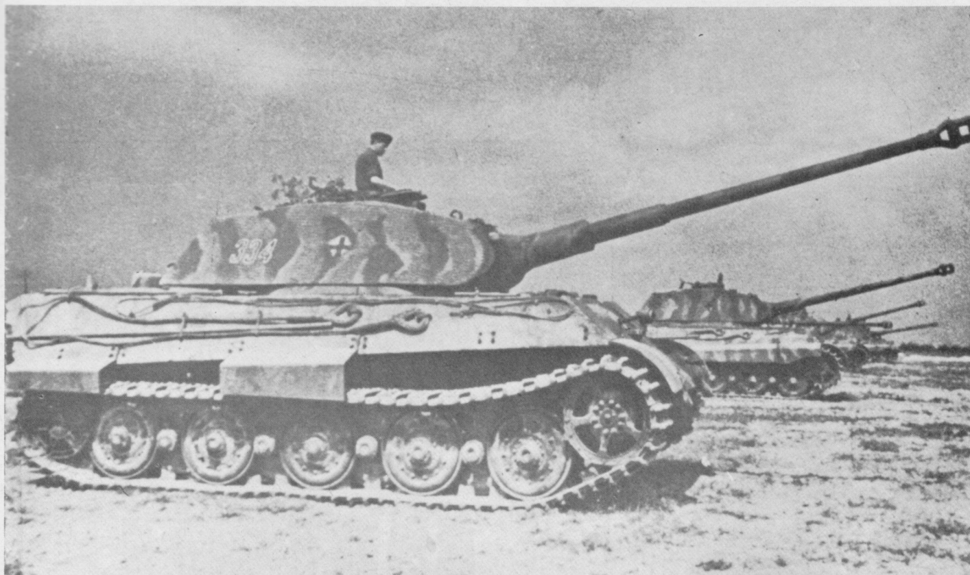
Oben: Fünf Tiger II (Ausführung B) mit Porscheturm bei Schießübungen. Der vordere Panzer hat Teile seiner Kettenabdeckung verloren. Er zeigt ein zweiteiliges Rohr.
