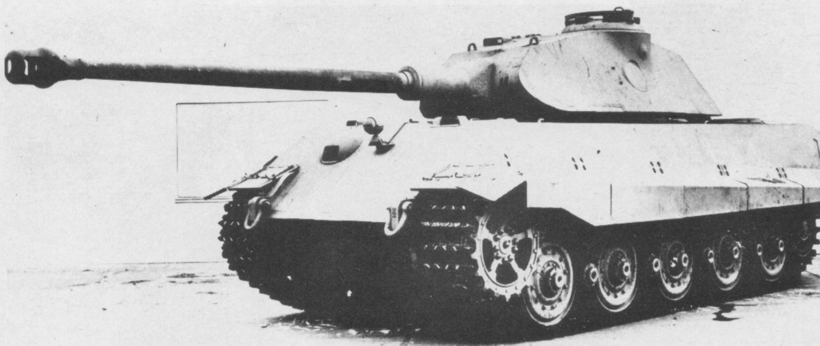
Oben, Mitte und unten: Der Panzerkampfwagen VI/Ausführung B – Tiger II (Sd.Kfz. 182) mit "Porsche-turm" von verschiedenen Seiten. So sahen die ersten 50 produzierten Exemplare aus. Er zeigt gut die völlig neue Formgebung dieses Panzers gegenüber dem Tiger I – er ähnelt mehr dem Panther.
