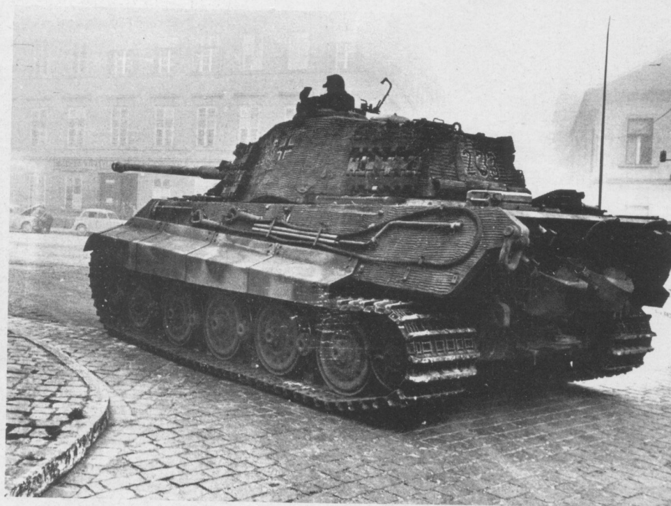
Links: Königtiger der schwe- ren Panzerabteilung 503 in Budapest (Oktober 1944). Er läßt die Halte- rung für das Flieger-MG an dem Ring der Kom- mandantenkuppel er- kennen.
