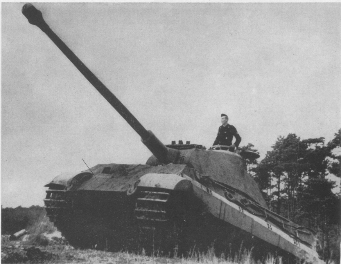
Oben links: Bei der Durchfahrt einer Waschanlage auf dem Übungsplatz. Oben rechts: Hier sind gut erkennbar die Lafettierung der Kanone im Turm und die Ausblicke der Optik. (1 x BA)
