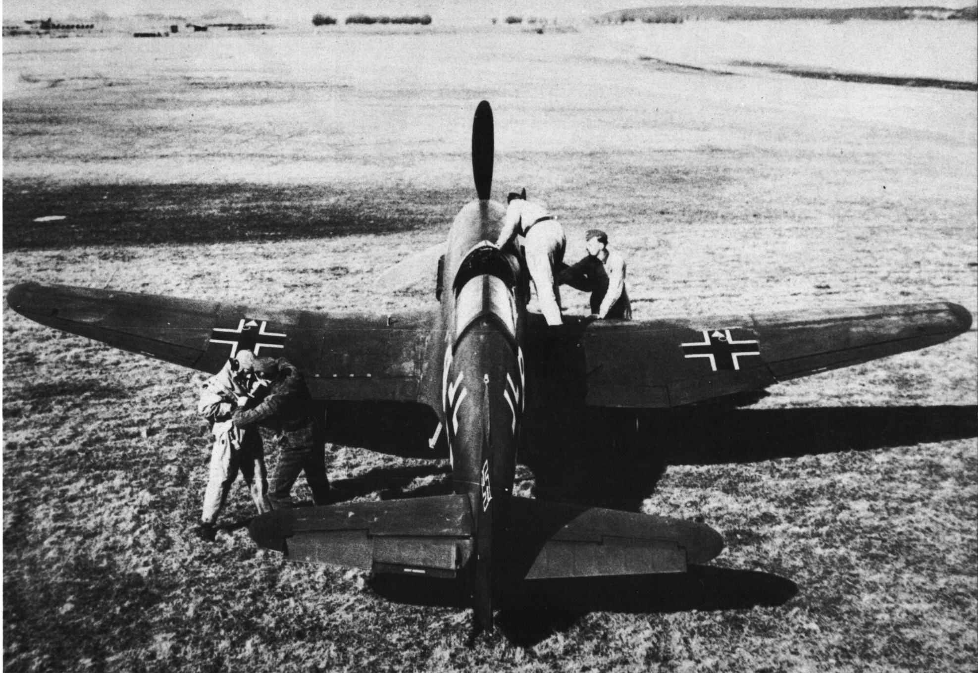
Diese He 100 D hat normale Kühlung, die Oktan-Dreiecke befinden sich in den Balkenkreuzen.
