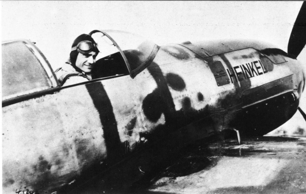
Die V-8 hatte während des Rekordfluges keinen Anstrich und keine Zulassung aufgemalt. Die dunklen Flecken sind verschliffene Spachtelstellen.
