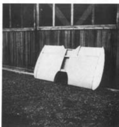
Die Tragfläche der "Natter" in verschiedenen Fertigungsstadien. Die Holzkonstruktion der BP-20 hatte den Vorteil, kriegswichtige Materialien zu schonen und den Bau der Maschine zu vereinfachen. Mit relativ schlichten Werkzeugen ließ sich die Tragflächenhälfte einer Ba 349 produzieren.
