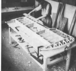
Die Tragfläche der "Natter" in verschiedenen Fertigungsstadien. Die Holzkonstruktion der BP-20 hatte den Vorteil, kriegswichtige Materialien zu schonen und den Bau der Maschine zu vereinfachen. Mit relativ schlichten Werkzeugen ließ sich die Tragflächenhälfte einer Ba 349 produzieren.
