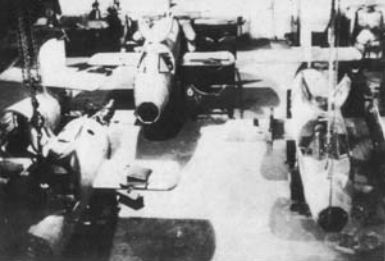
Links: Endmontage der Bachem Ba 349. Bei der linken Maschine ist das Triebwerk zu erkennen.
