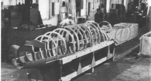
Rumpf der Bachem Ba 349 „Natter“ auf der Lehre in Flugrichtung gesehen. Die Spanten und Unterschale sind montiert; unten wurden die Längsurte bereits aufgeleimt.
