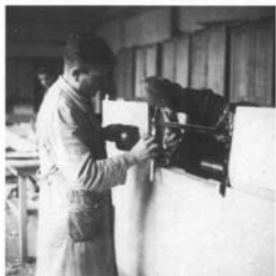
Die Tragfläche der "Natter" in verschiedenen Fertigungsstadien. Die Holzkonstruktion der BP-20 hatte den Vorteil, kriegswichtige Materialien zu schonen und den Bau der Maschine zu vereinfachen. Mit relativ schlichten Werkzeugen ließ sich die Tragflächenhälfte einer Ba 349 produzieren.
