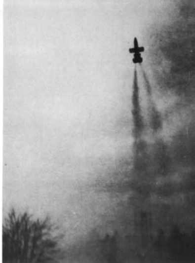
Die BP-20 verläßt mit Hilfe der Startraketen die Lafette.
