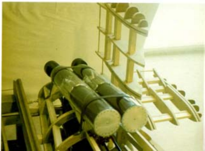
Rechts: Maßstäbliches Modell der Ba 349 "Natter". Deutlich ist der relativ einfache Holzaufbau erkennbar, der eine Produktion im Krieg an vielen Orten ermöglichen sollte.
