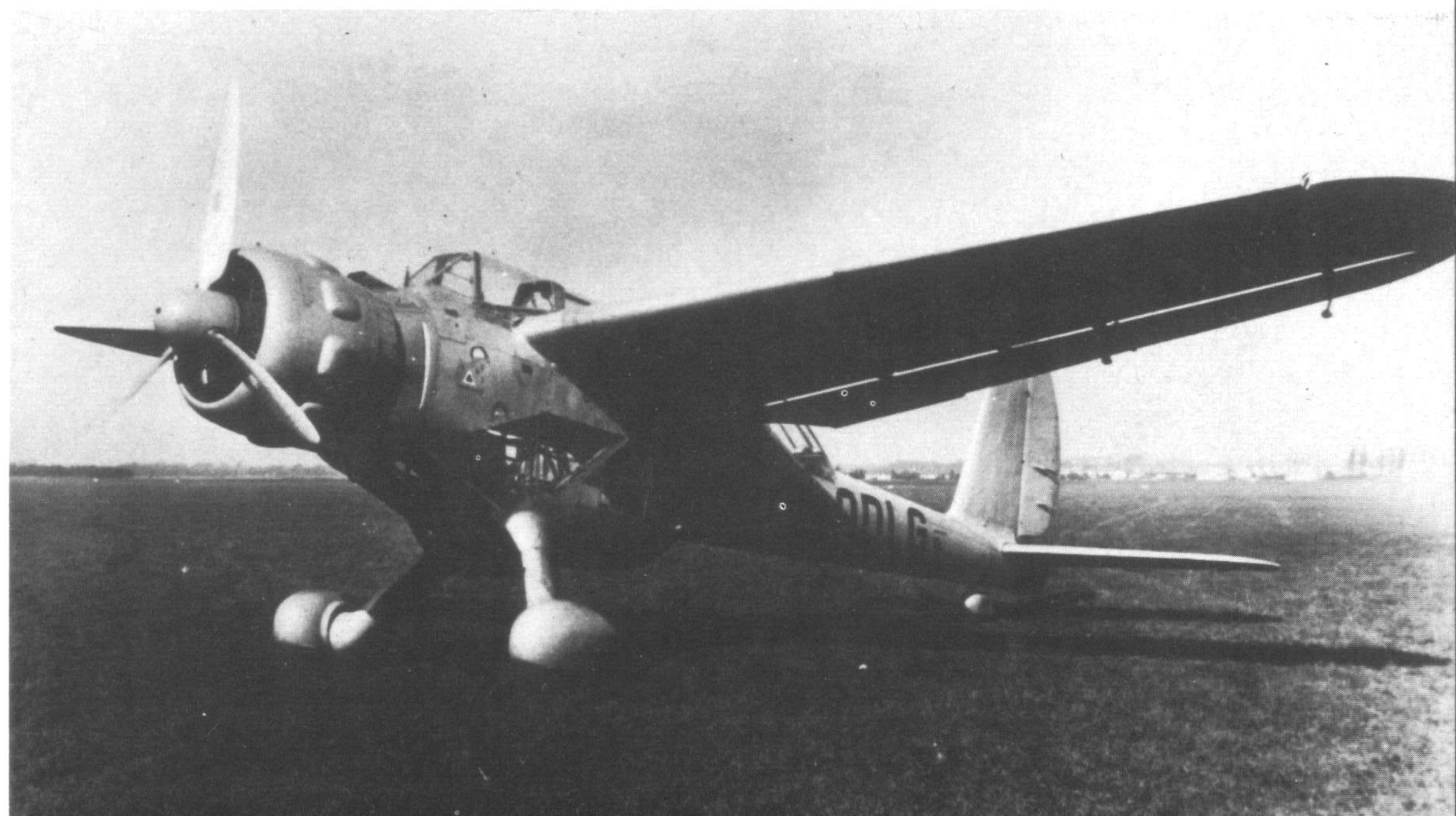
Die Ar 198 wurde 1937/38 als moderner Nahaufklärer konzipiert. Durch die großzügige Verglasung, insbesondere unter dem Rumpf, erhofften sich die Konstrukteure hervorragende Rundumsicht. Aufgrund ungenügender Flugeigenschaften und -leistungen wurde aber nur ein Exemplar, die D-ODLG, gebaut.
