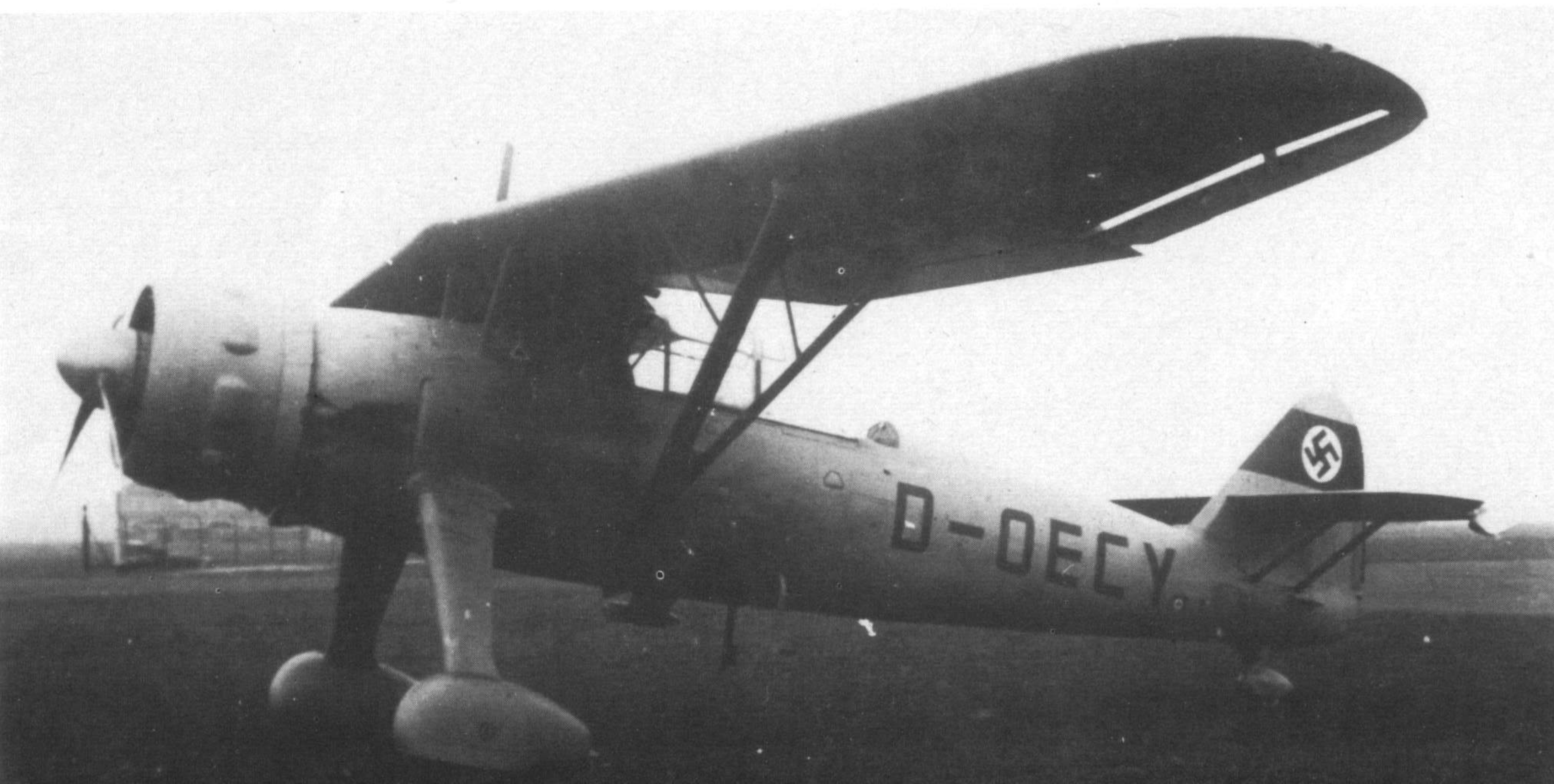
Unten und folgende Seite: Die D-OECY war das dritte Versuchsmuster von 910 gebauten Henschel Hs 126. Die Maschine besaß einen 830 PS leistenden Bramo 323 A1-Sternmotor mit VDM-Luftschaube.
