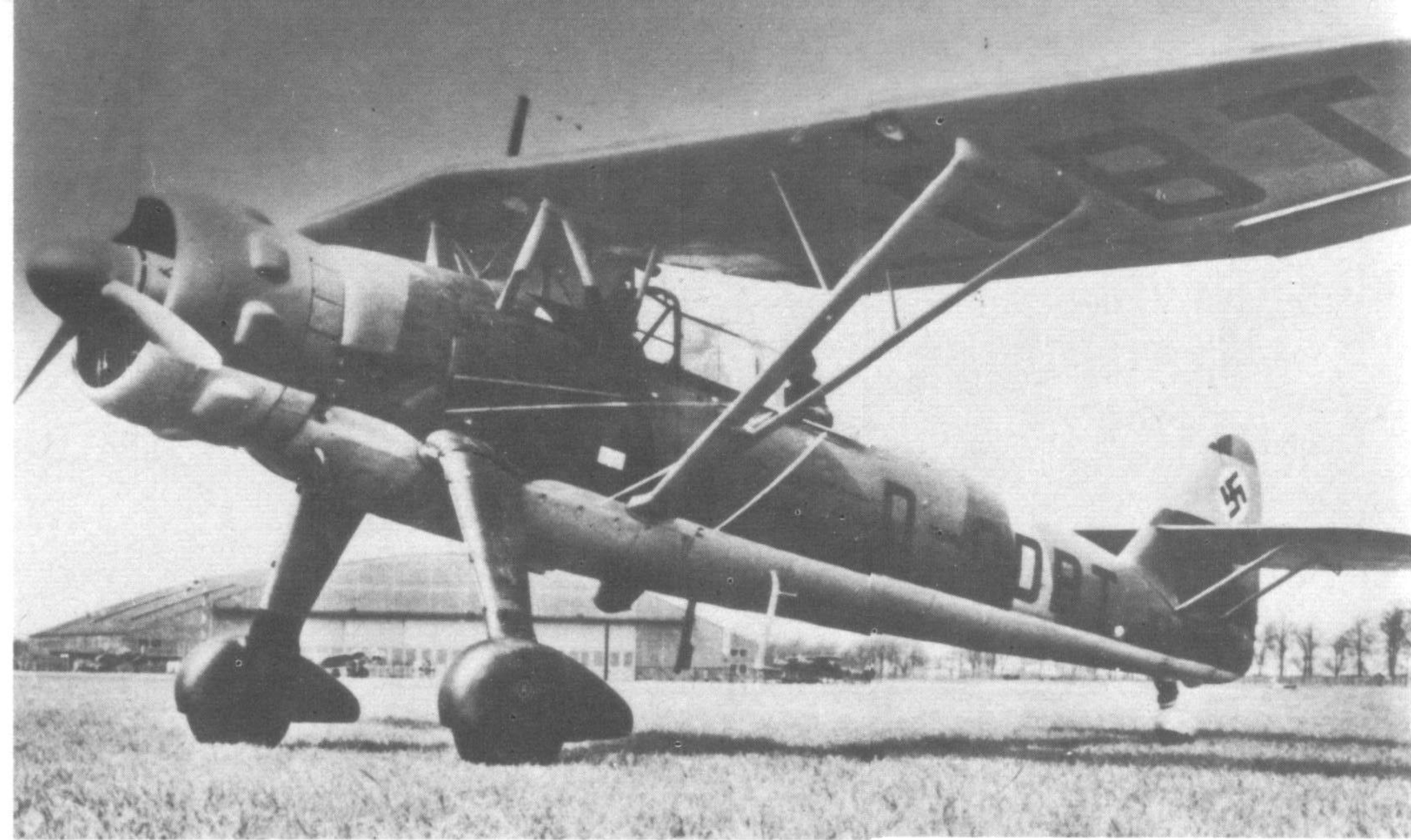
Oben: Henschel Hs 126 A-1, Kennung D-ODBT, im Vorkriegsanstrich während der Werkserprobung. Bei der Hs 126 befand sich der Pilot in einer vollverglasten Kabine, während der Beobachter im Freien saß.
