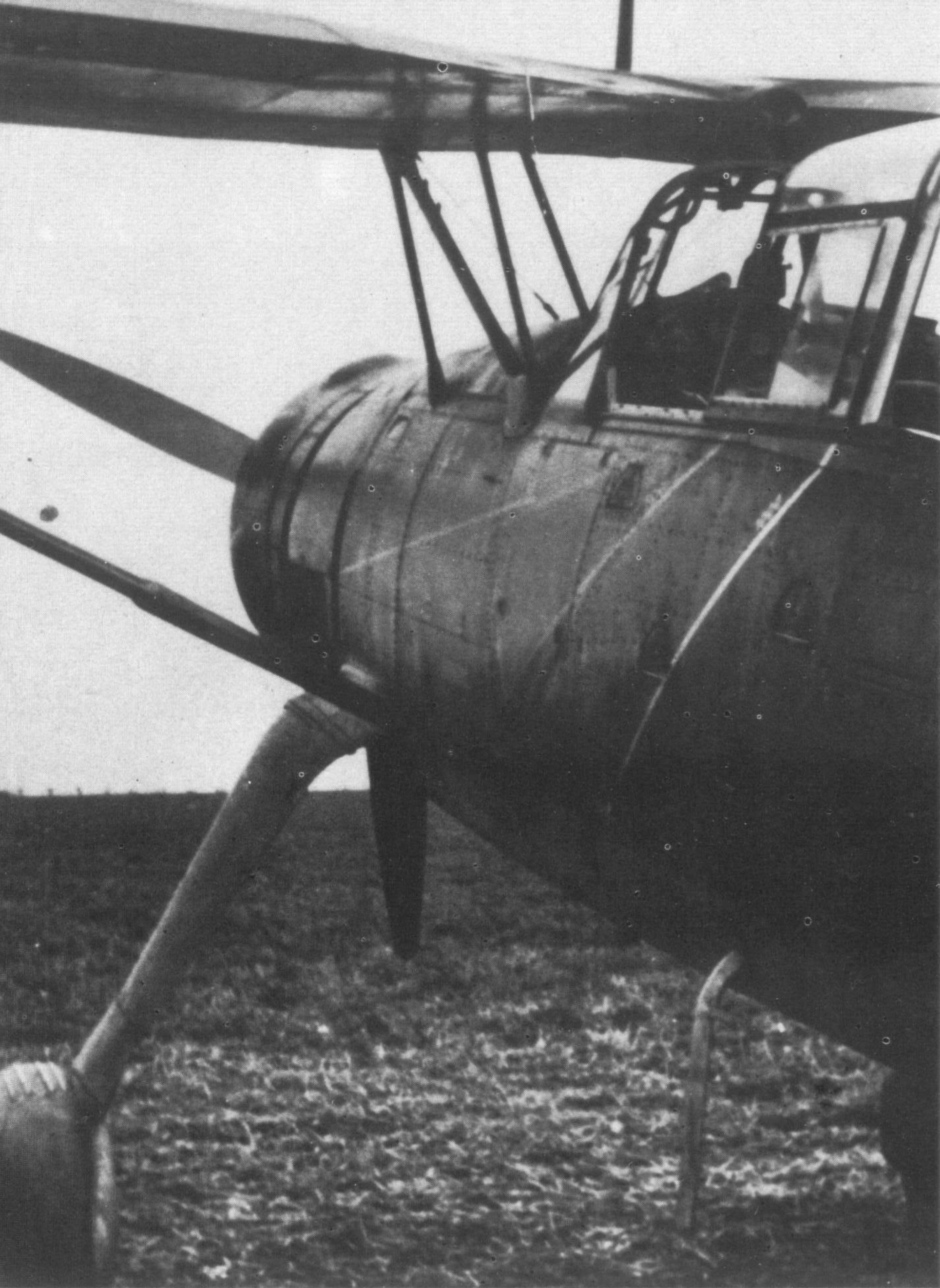
Oben: Deutlich sind bei dieser Hs 126 B-1 die an der Rumpfseite aufgemalten Visierlinien zu erkennen. Sie halfen den jeweiligen Gleit- bzw. Sturzwinkel für den Bombenwurf zu bestimmen.
