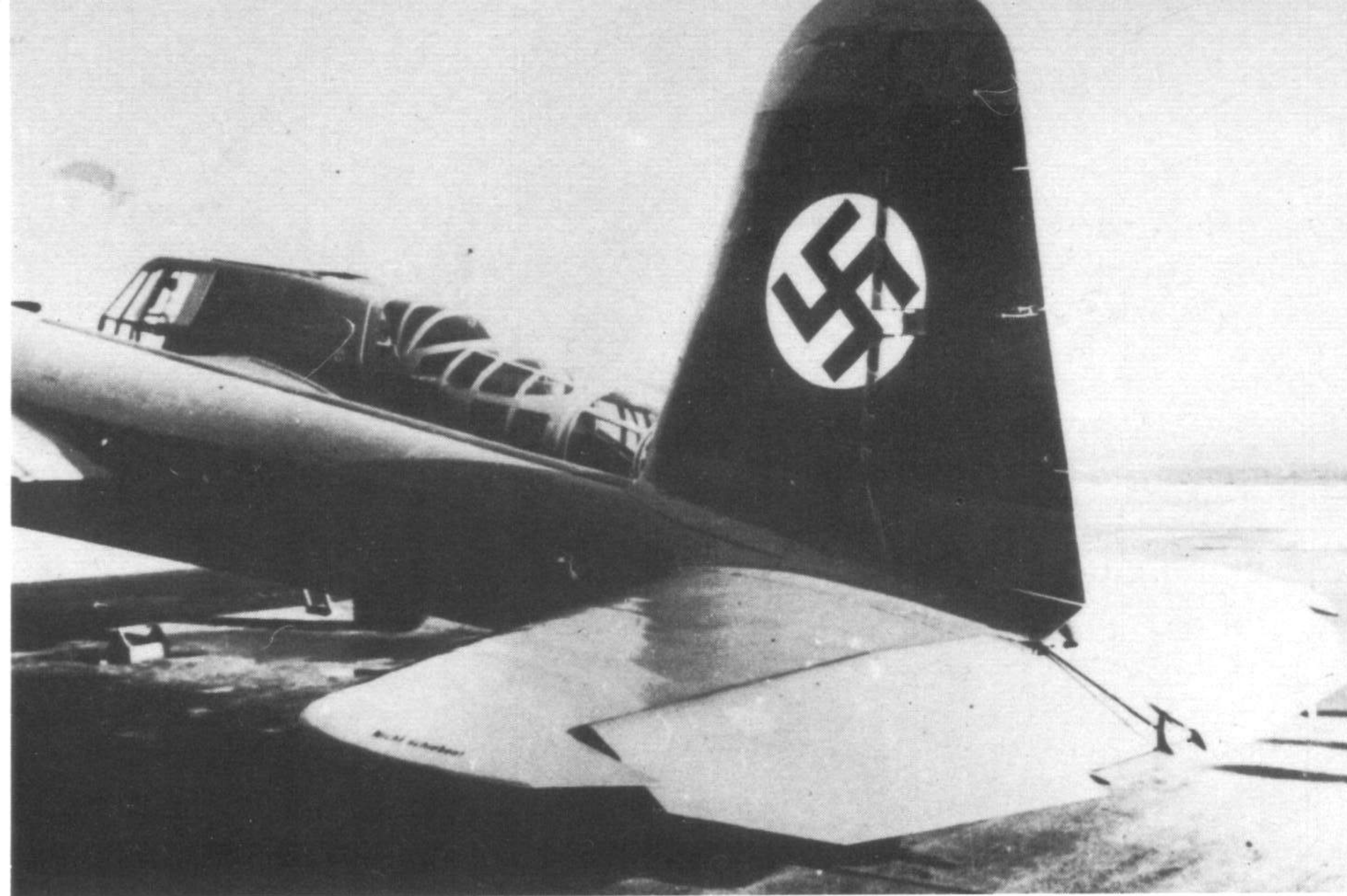
Links: Detailaufnahme des Leitwerkes der BV 141 mit symmetrischem Seitenruder.
