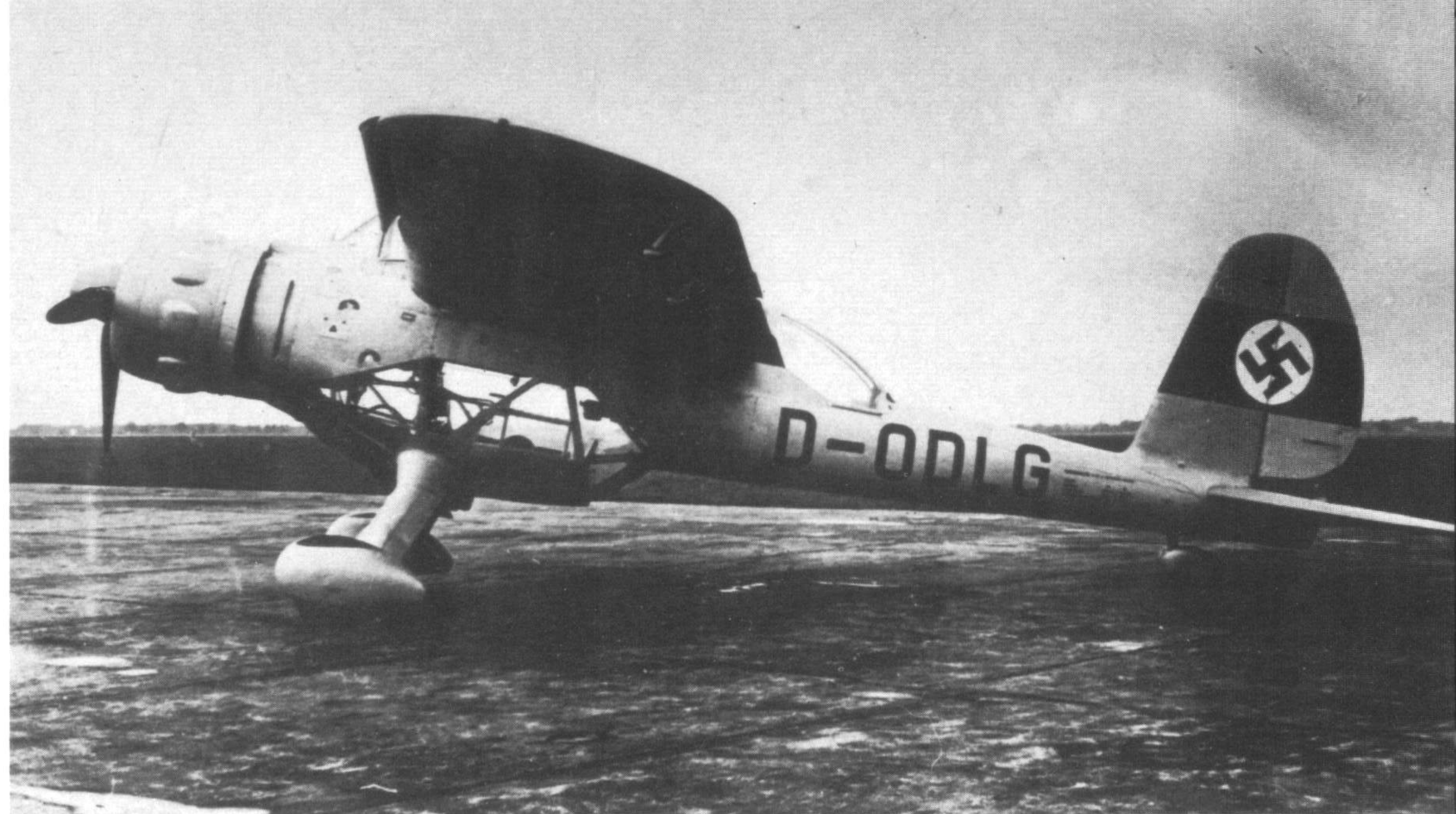
Die Ar 198 wurde 1937/38 als moderner Nahaufklärer konzipiert. Durch die großzügige Verglasung, insbesondere unter dem Rumpf, erhofften sich die Konstrukteure hervorragende Rundumsicht. Aufgrund ungenügender Flugeigenschaften und -leistungen wurde aber nur ein Exemplar, die D-ODLG, gebaut.
