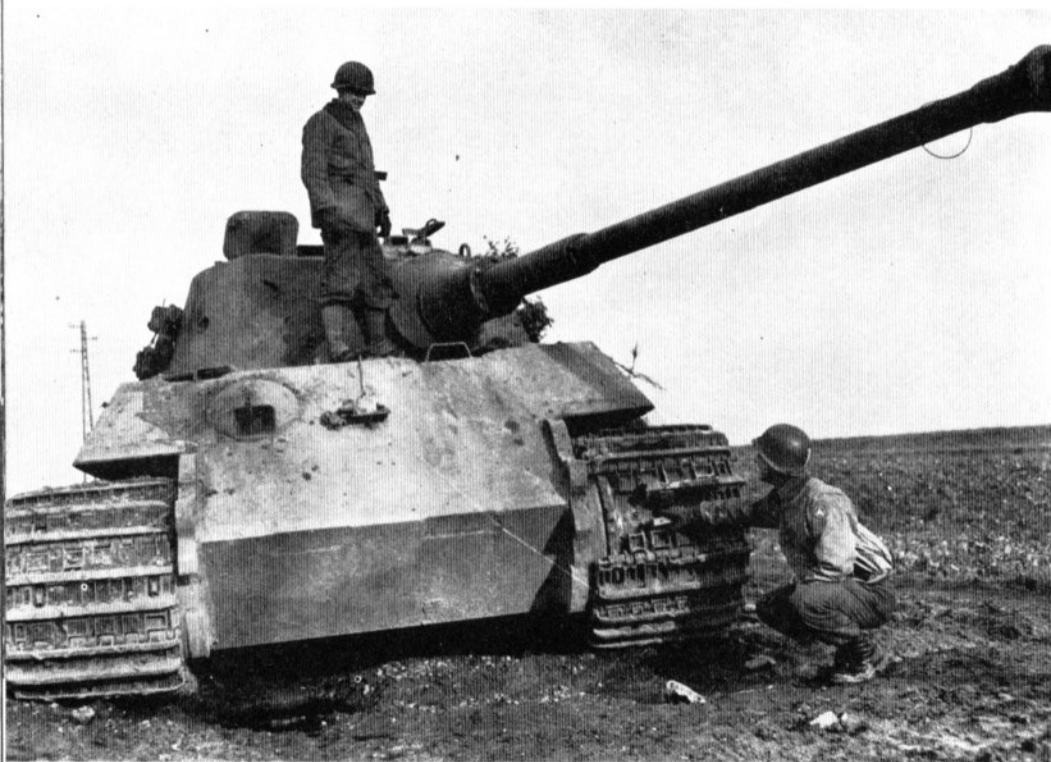
Links: Dieser Wagen erhielt bei Freialdenhoven einen Laufwerkstreffer vorn links und wurde aufgegeben. Die US-Bildunterschrift "Abschuß durch einen M-36-Jagdpanzer" (Treffer rechte Turmseite) ist irrig. Viele liegengebliebene Tiger erhielten nachträglich z. T. mehrere "Treffer", die dann alliierte Panzerbesatzungen als Erfolg meldeten.
