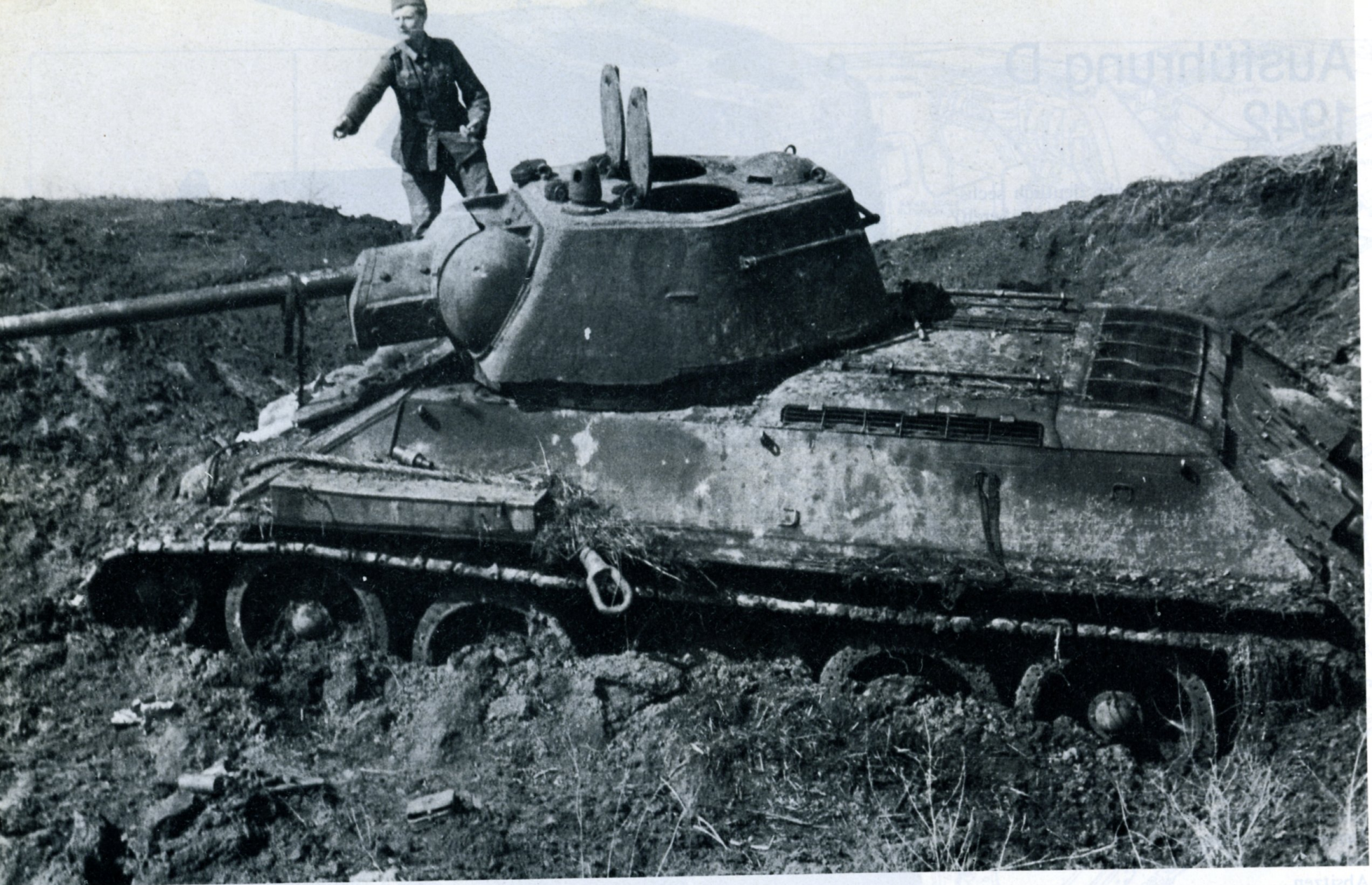
Dieses Foto zeigt gut die neue Form der Lafettierung mit den seitlichen Auswölbungen. Im Gegensatz zur deutschen 7,5 cm-Kanone hatte die russische 7,62 keine Mündungsbremse.
