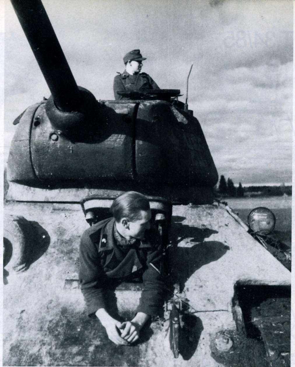
Das Typische für den T-34/85 ist der massige große Gußturm mit dem stärkeren und längeren Rohr der 8,5 cm-Kanone. Hier ein erbeuteter Panzer mit zur Aufnahme posierender "deutscher Besatzung". (BA)
