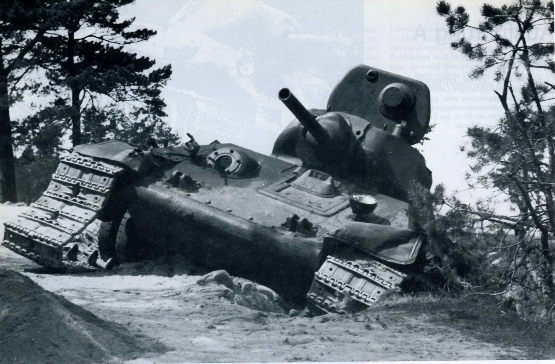
Ein sich festgefahrener und die rechte Kette geworfener T-34(A) mit gegossenem Turm. Neben der günstigeren Form, der starken und – gegenüber dem damaligen deutschen Gegner – längeren (höhere VO-Wucht) Kanone, zeichneten ihn robuste und schwerer brennbare Dieselmotoren, breite Ketten (Geländegängigkeit) und leichte Bedienung aus. (BA)
