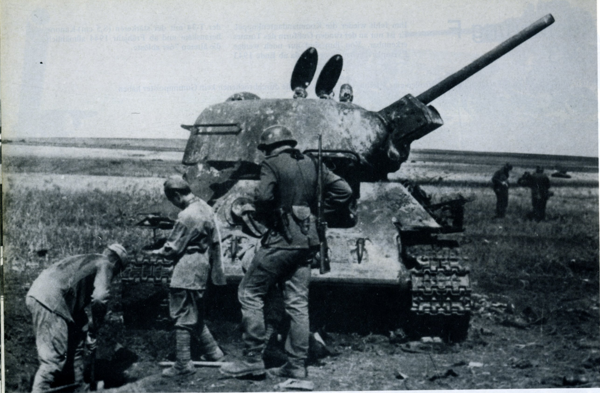
Typisch für die F-Ausführung ist der schildkrötenförmige Gußturm mit einem konturenreichen unteren Rand. Durch das Fehlen einer Kommandantenkuppel ähnelt er der Ausführung D – deren Turm jedoch sechseckig ist.
