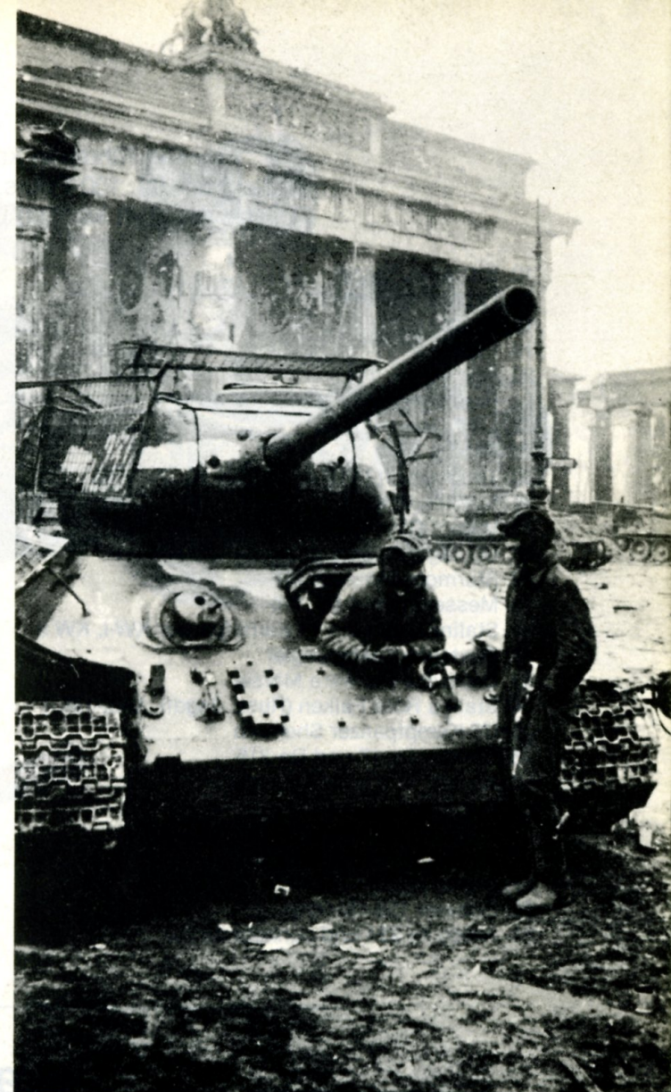
Ein T-34/85 vor dem Brandenburger Tor in Berlin. Er zeigt die stark gegliederte Kette und Gitter (gegen Handgranaten etc.) um und über dem Turm.
