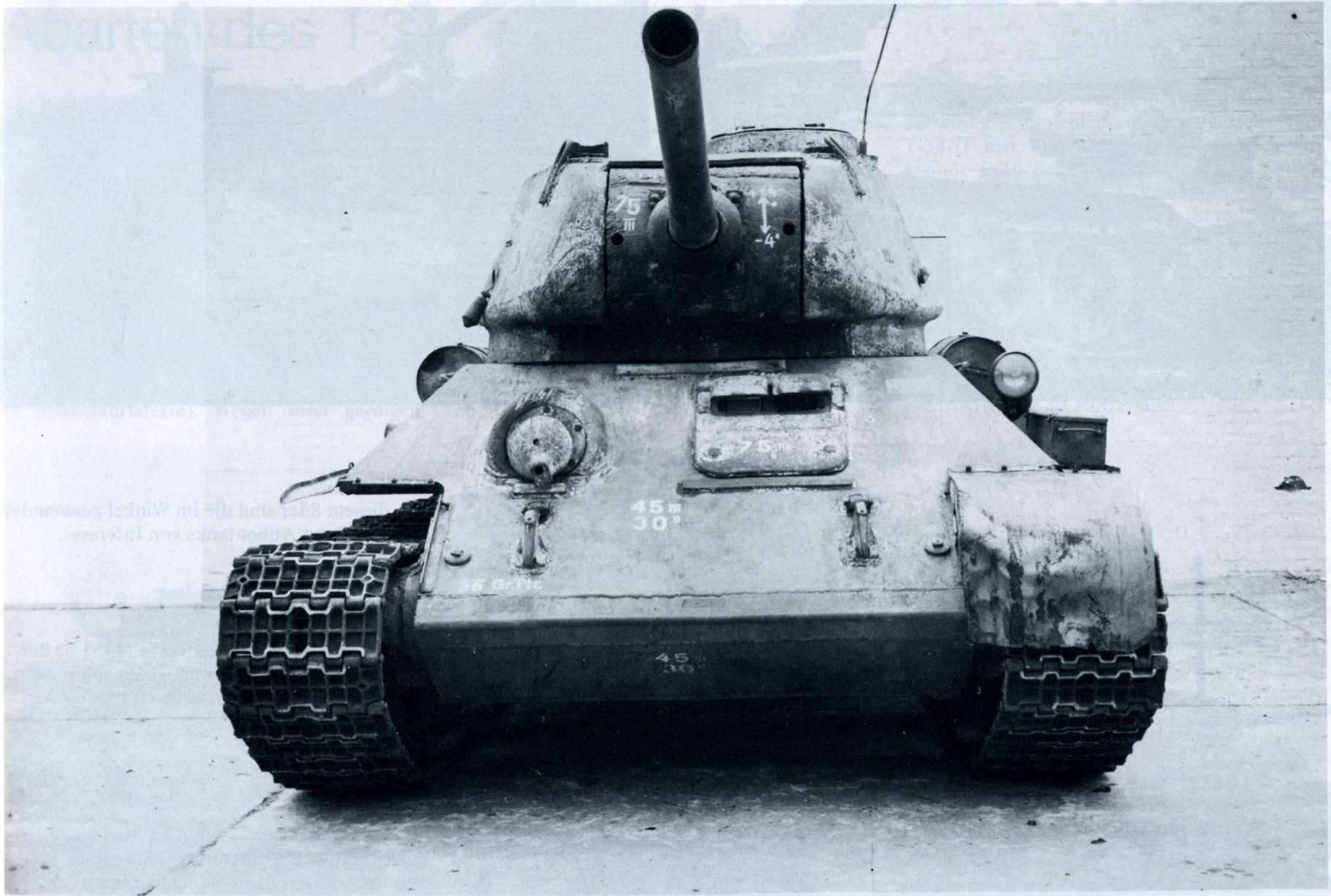
Dieser erbeutete T-34/85 war ein Demonstrationsstück der Wehrmacht und gab durch die aufgetragenen Zahlen Panzerstärken, Anzahl der Granaten und den Höhenschwenkbereich der Kanone bekannt.
