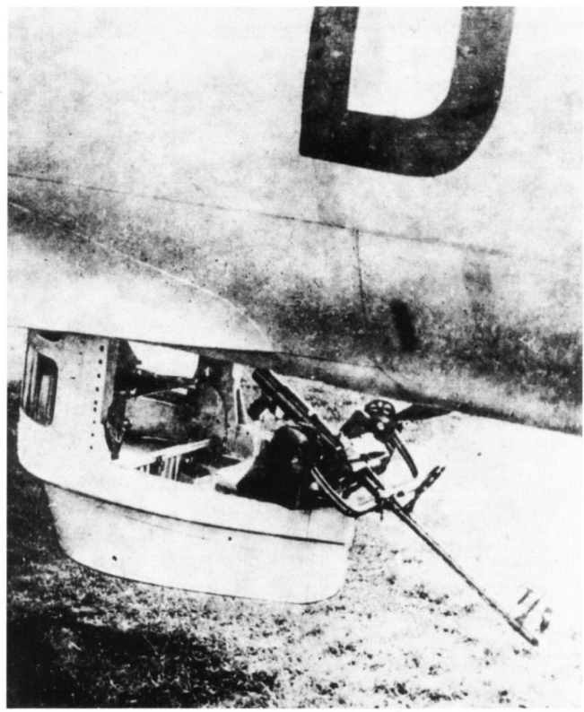
Nahansicht der ausfahrbaren Bodenlafette (Bola) 30 bei einer Ju 86.
