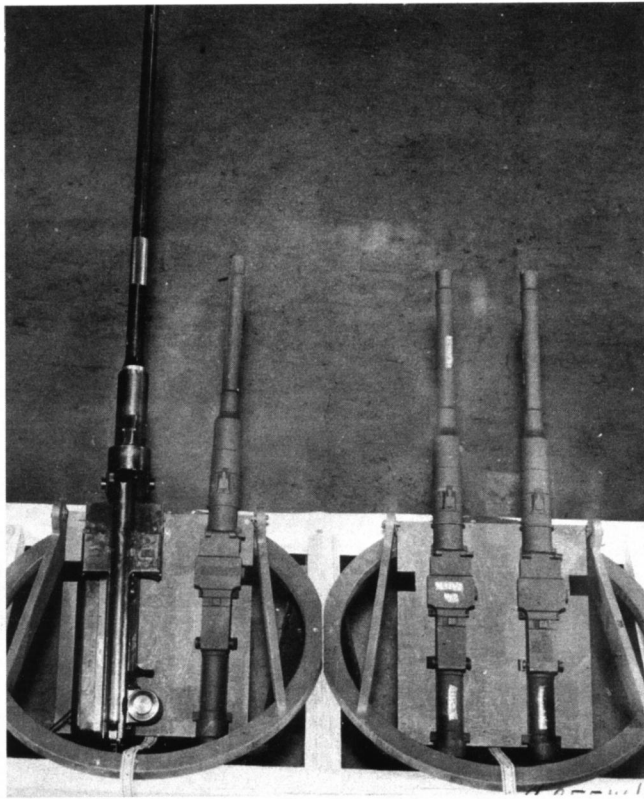
Zwei Musterbauten für Waffenstände mit MG 131- und MG 151-Waffen. Die Stände waren zweitweise sowohl für die Ju 288 B als auch die C-Version geplant.
