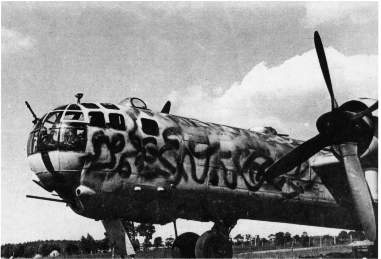
Ein schwerer He 177A-Bomber des KG 1 mit MG 151 im unteren A-Stand sowie einem MG 131 im oberen Abwehrstand.
