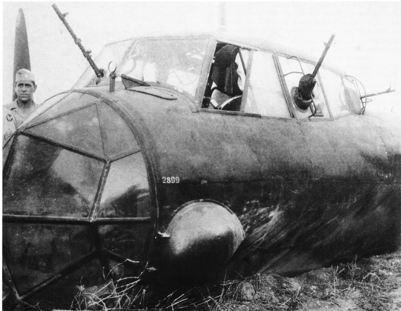
Die Do 17 Z konnte mit bis zu sechs MG 15 im oberen Kabinenbereich versehen werden.
