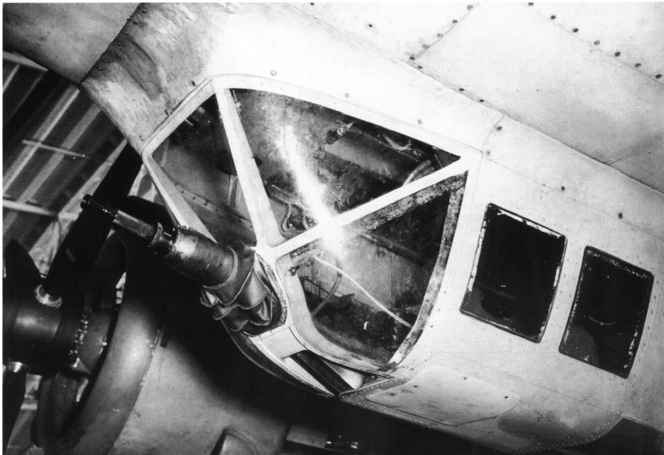
Bei der Fw 200 C war für diesen Verwendungszweck ebenfalls ein MG FF in der unter dem Rumpf angebrachten Waffenwanne installiert.
