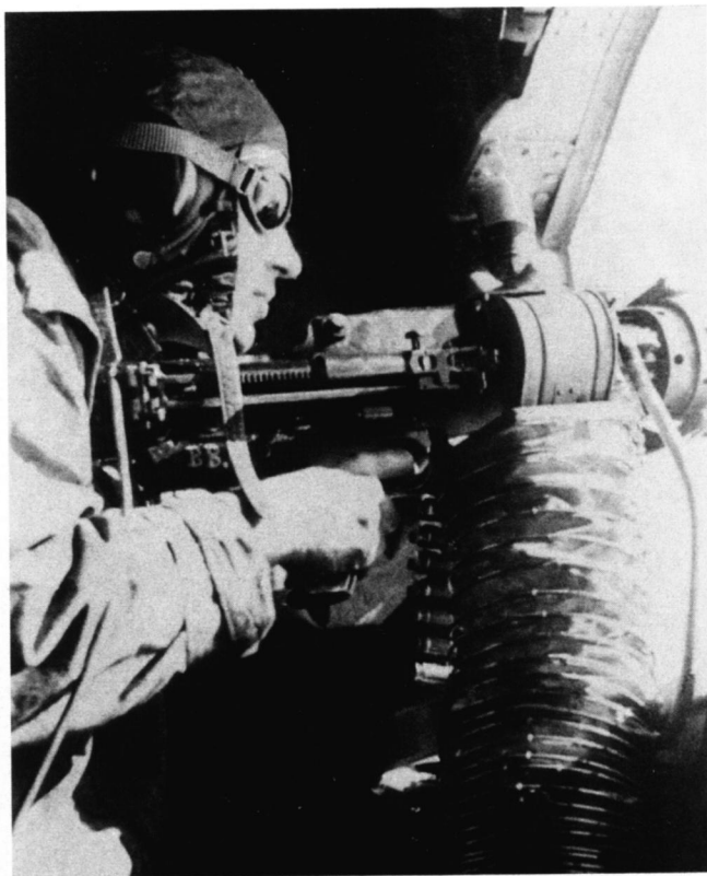
Nahansicht des in den Rumpfsseiten einer Me 323 einge-bauten MG 131.
