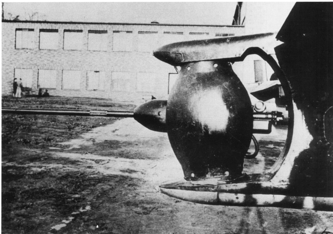
Der versuchsweise bei der Ju 288 C-1 verwendete Waffenstand mit fernbedientem MG 151.
