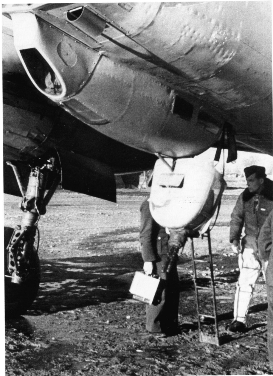
Als Schutz gegen von hinten unten angreifende Feindflugzeuge führte die Ju 88 A-4 einen C-Stand mit einem MG 81 Z in der Bola 81 Z mit.
