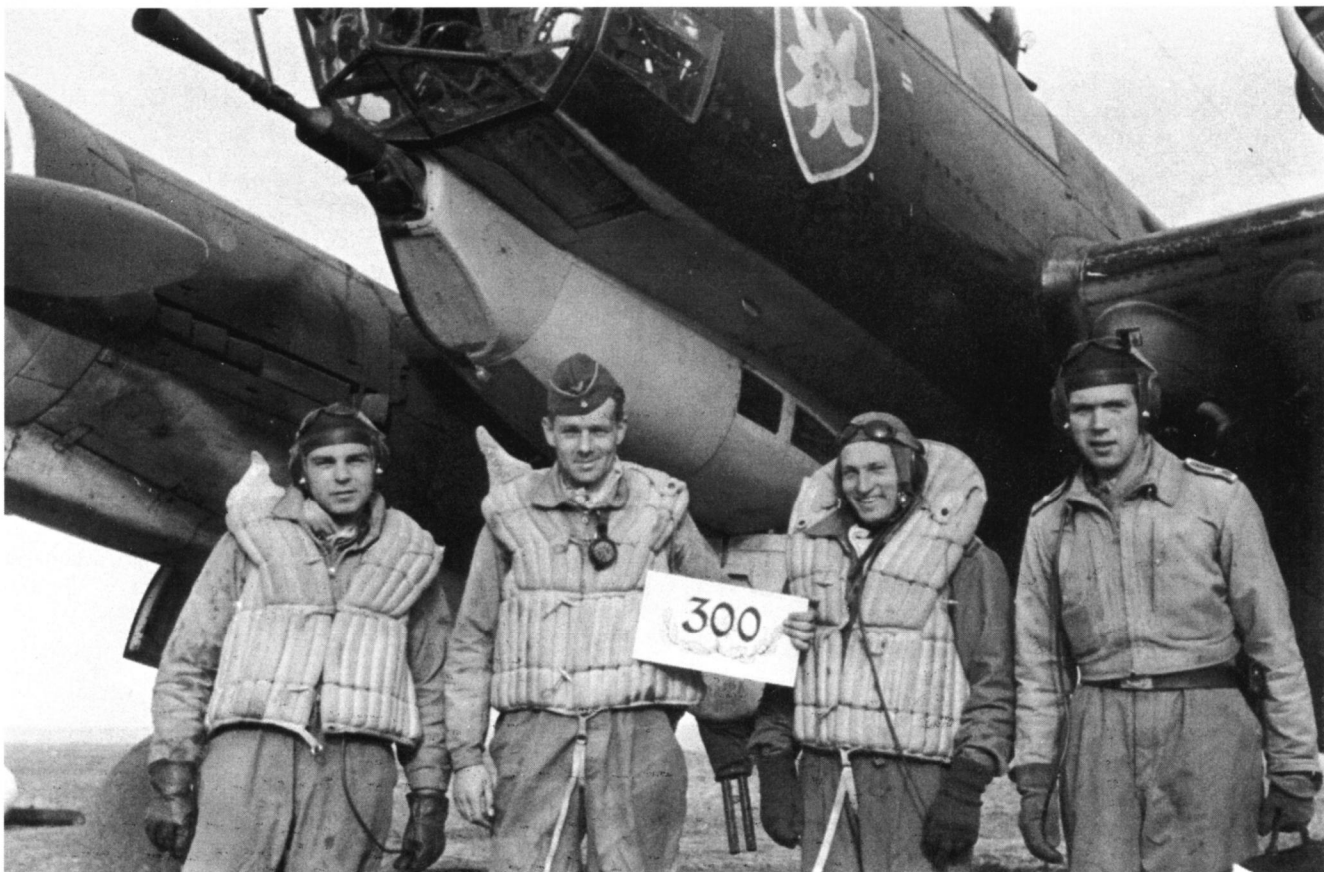
Diese Ju 88 A-14 führte ein MG FF mit Feuerdämpfer in der modifizierten Bodenwanne mit. Die Maschine gehörte zum Bestand des KG 51.
