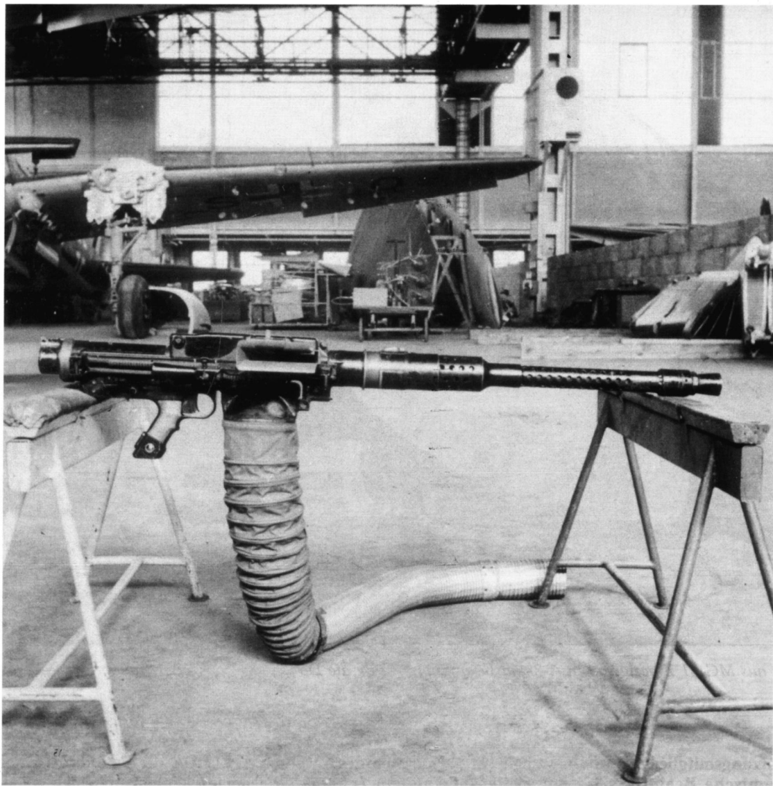
Nahansicht des MG 131-Maschinengewehrs, das außer bei Jagdflugzeugen auch bei den mittleren Kampfflugzeugen der Luftwaffe das MG 17 sowie das MG 811 ersetzte.
