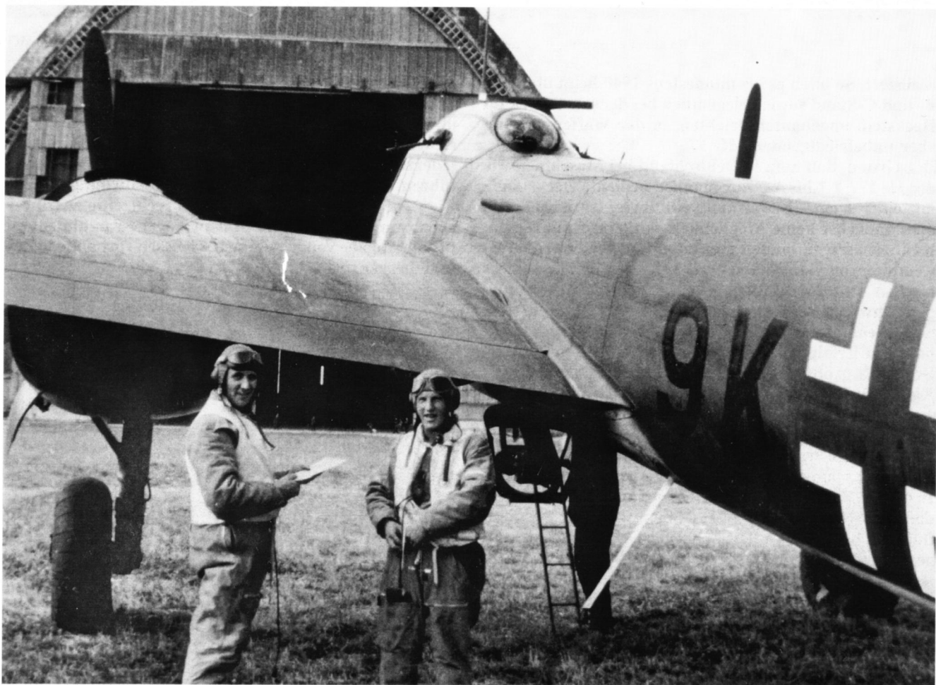
Diese Ju 88 A-1 wies eine Linsenlafette LLK auf. Zu beachten sind zwei zusätzliche MG 15 in der seitlichen Kabine.
