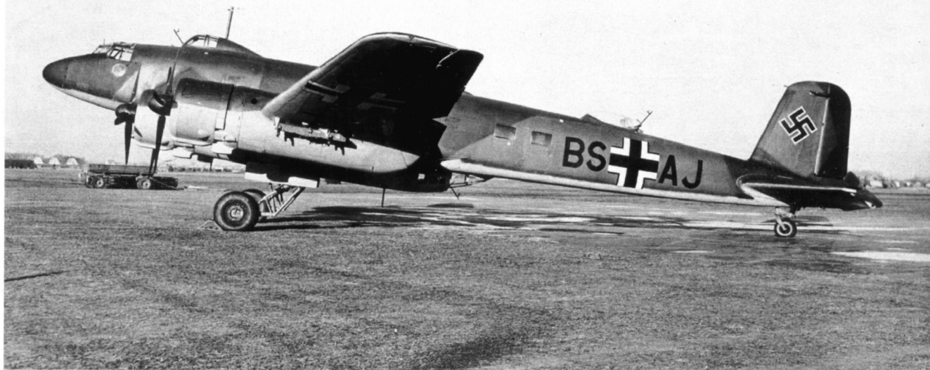
Zunächst erhielten die frühen Fw 200 C einen verglasten Waffenstand hinter der Kabine, der später gegen eine Drehlafette ausgetauscht wurde.
