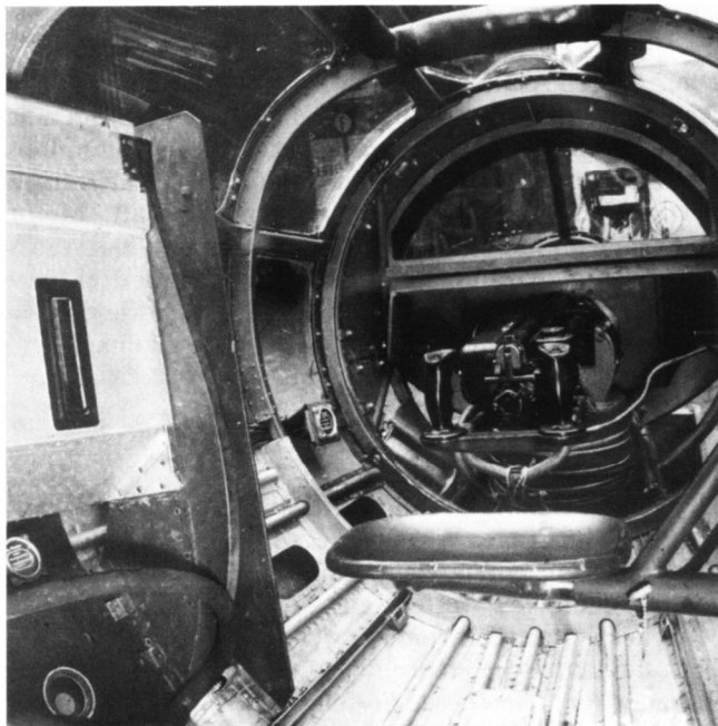
Innenansicht des MG 151/20-Heckstandes bei der Ju 290 A-2.
