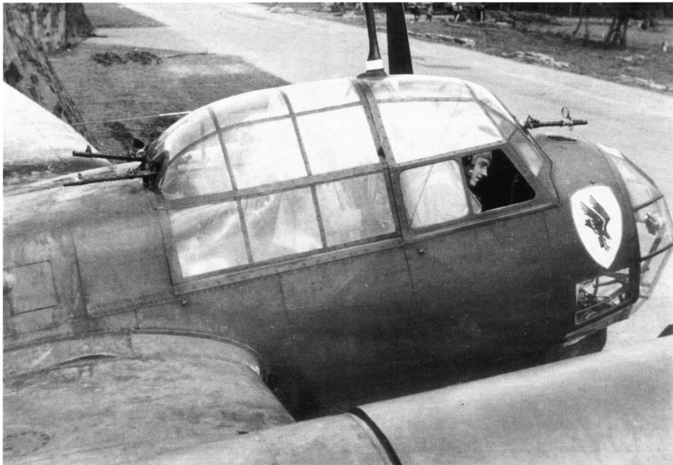
Die einzelne hintere Linsenlafette bei der Ju 88 A-1 wurde ab der A-5 durch zwei einzelne MG 15 mit Ikaria-Lafette ersetzt.
