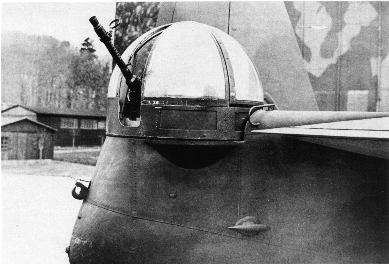
Nahansicht des Heckstands der Do 24, der mit einem MG 1 31 bestückt war.
