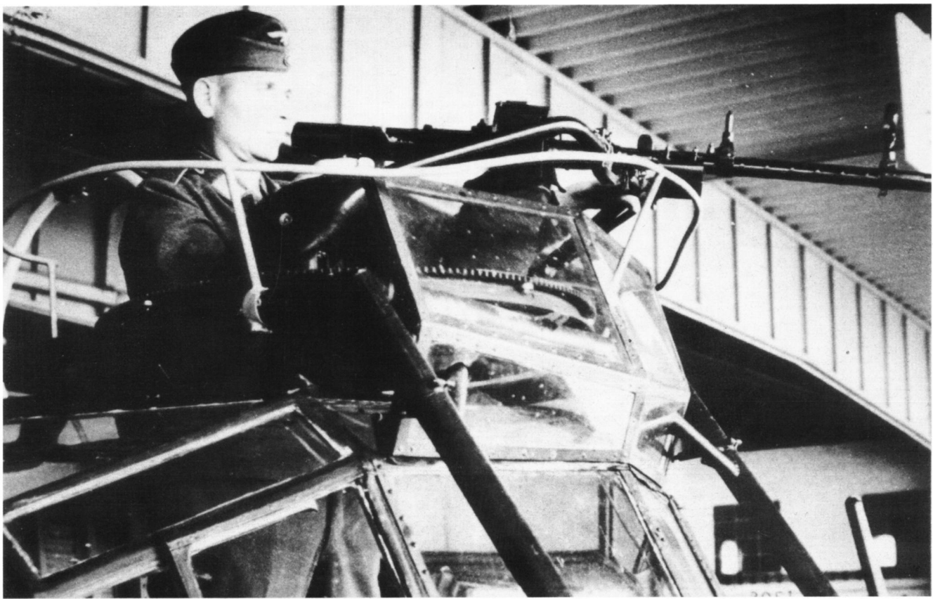
Die erste Versuchsausführung eines Abwehrstands im Bereich der Ju 52-Kabine.
