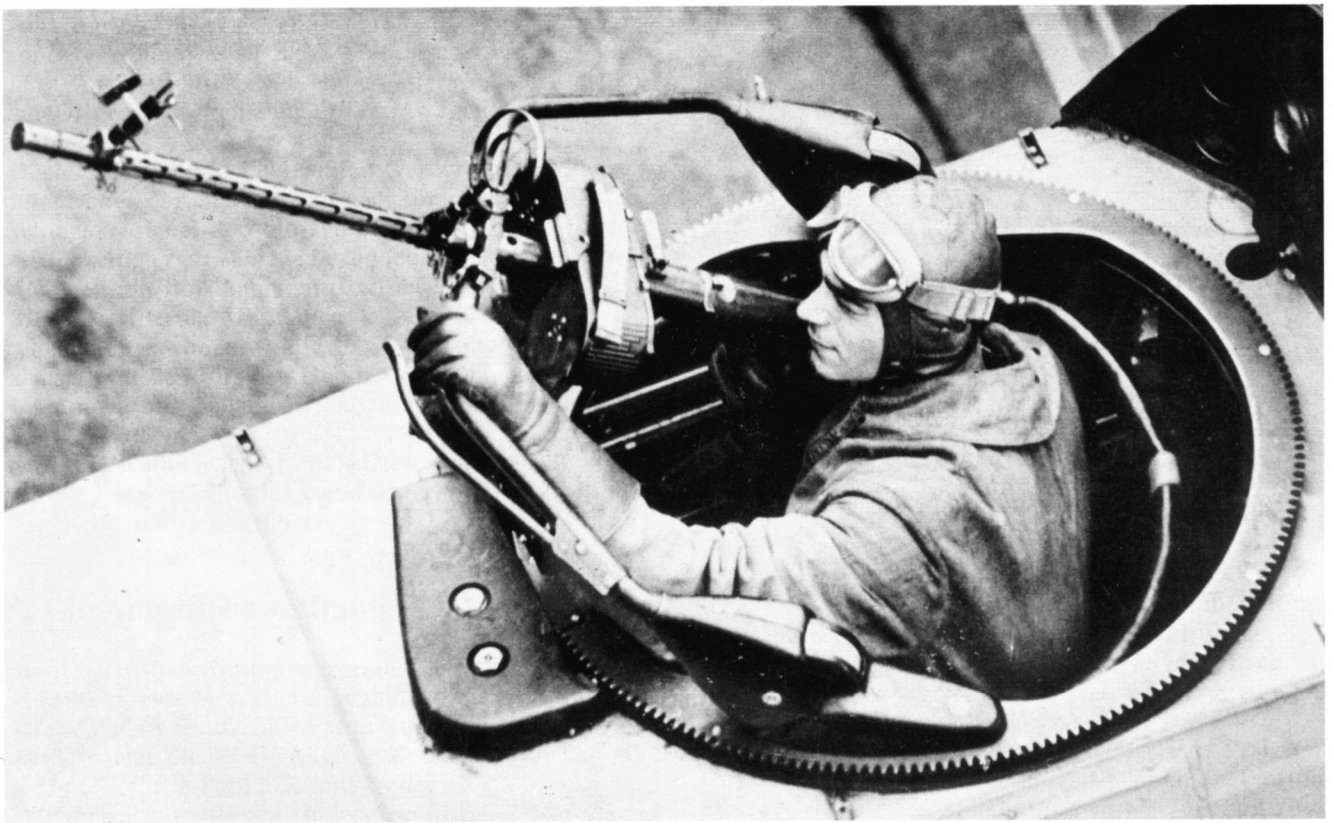
Einbau einer 2cm-Kanone mit Bug eines Dornier Wal-Flugbootes.
