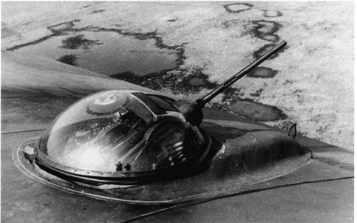
Mehrere dieser mit einem MG 151/15 bestückten Waffenstände wies der Großtransporter Me 323 auf.
