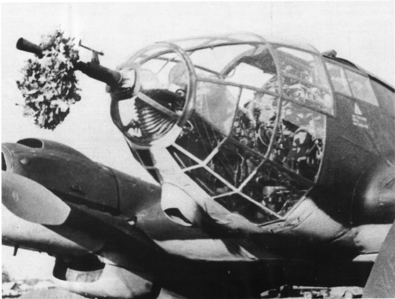
Als erste 2cm-Waffe wurde bei der Luftwaffe das MG FF in großer Zahl verwendet. Das Foto zeigt eine He 111 H-11 mit einer dieser Waffen, die wegen der durchzuführenden Nachtangriffe einen Feuerdämpfer erhielt.
