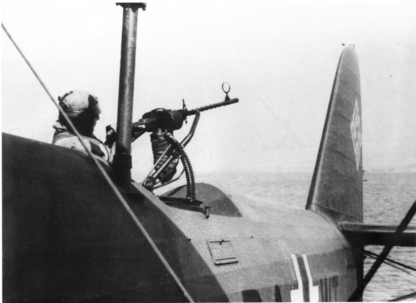
Einbau des MG 151 im B-Stand eines He 59-Schwimmerflugzeuges.
