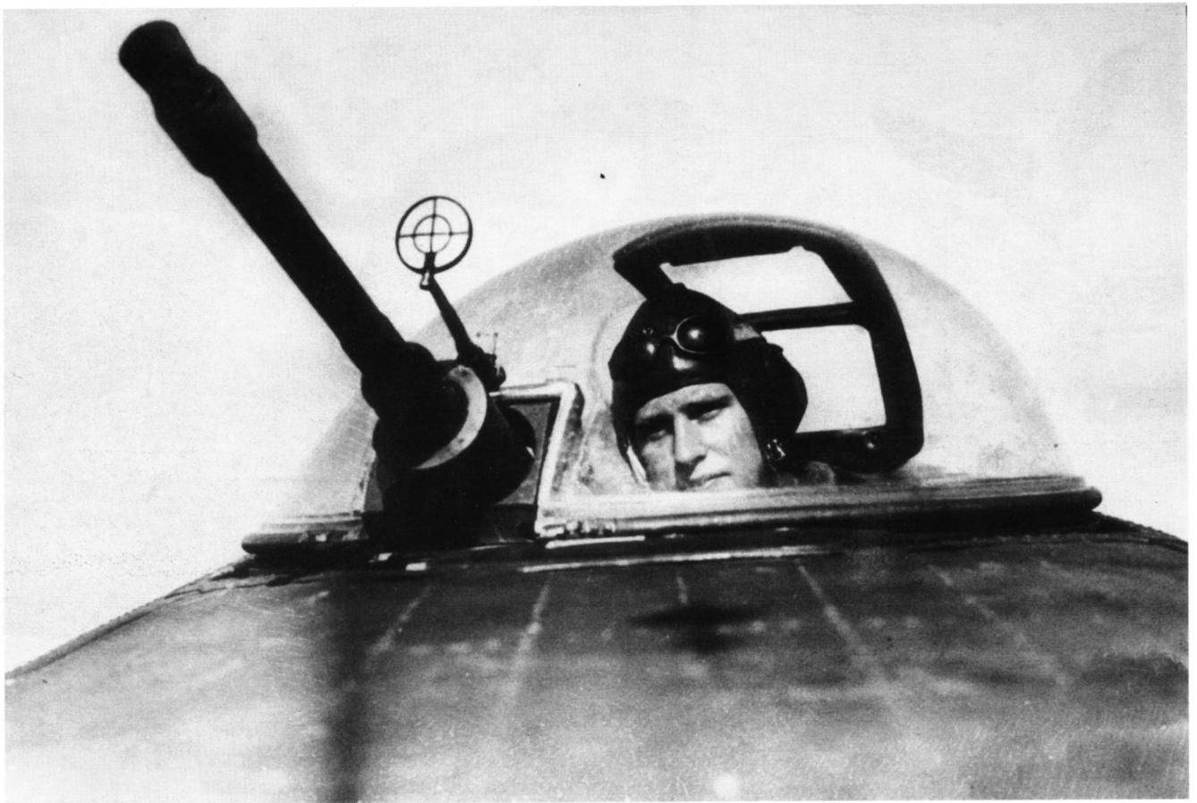
Nahansicht der bei der Fw 200 C verwendeten Rumpfbewaffnung, die schließlich aus MG 131 bestand.
