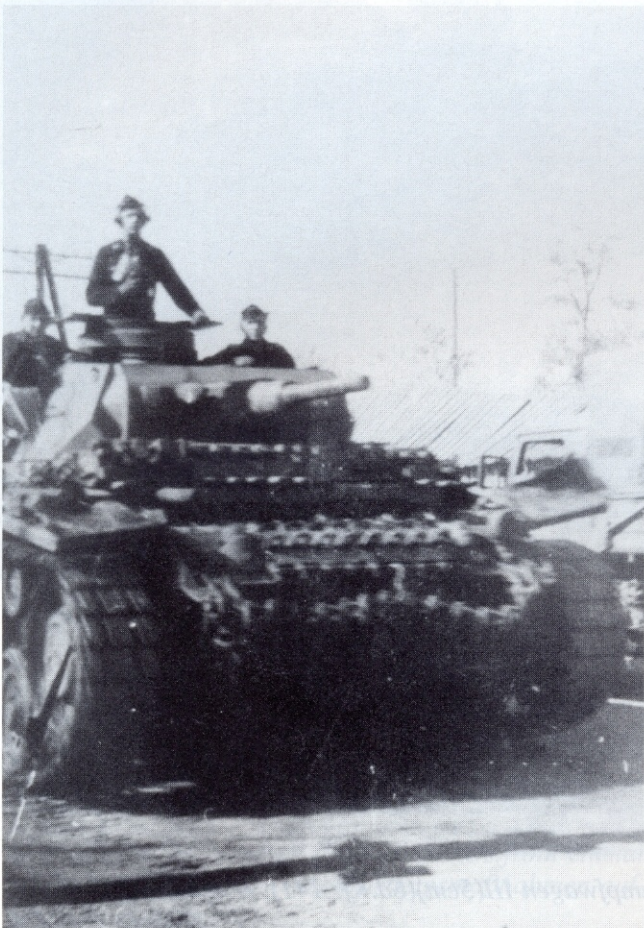
Als provisorische Verstärkung der Panzerung im Frontbereich dienten bei diesem Panzerkampfwagen III(5cm)(Sd.Kfz.141), Ausführung G Kettenglieder.
