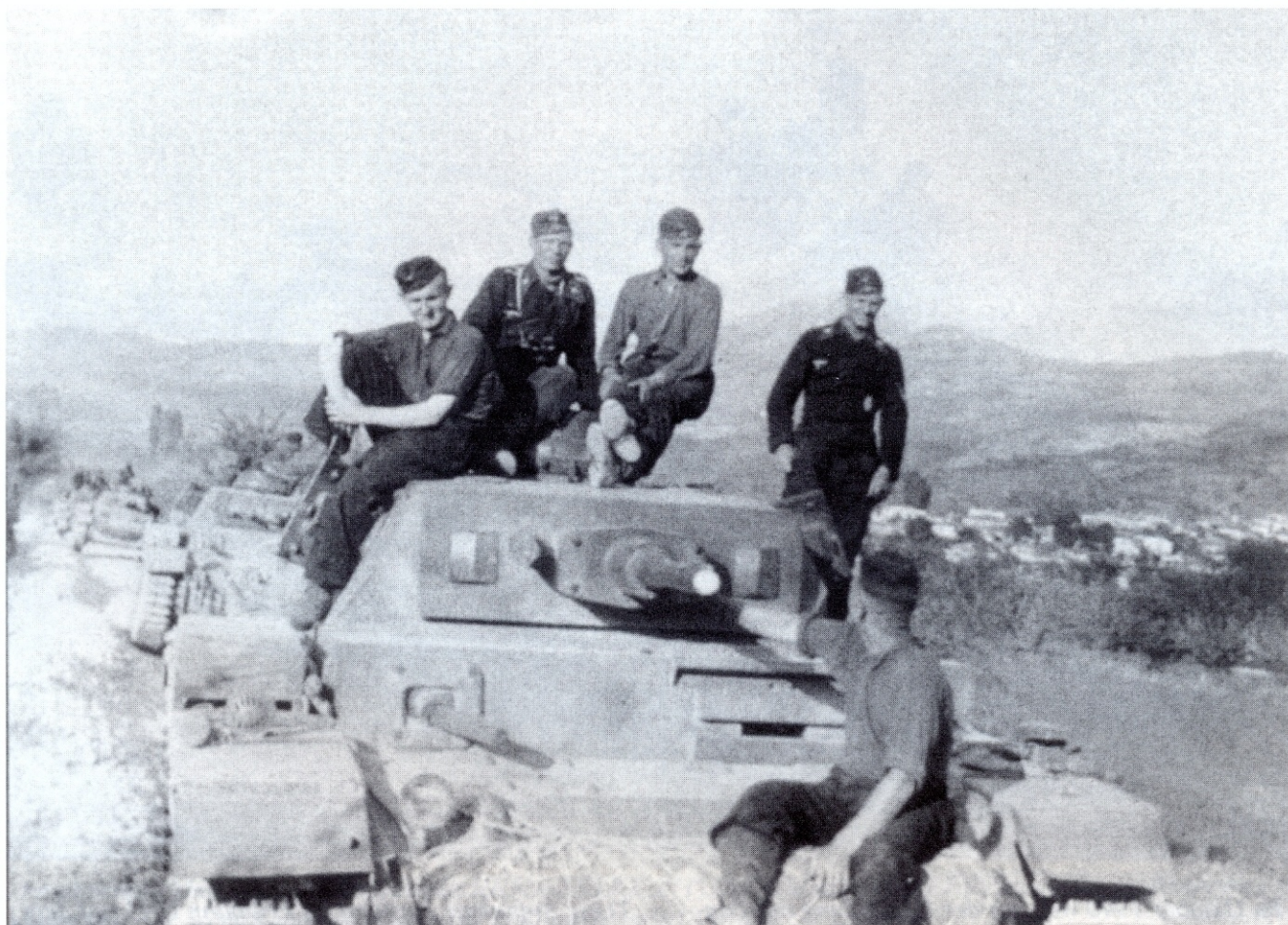
Panzerkampfwagen III(5cm)(Sd.Kfz.141), Ausführung G. Markanter äußerer Unterschied war neben der 5-cm-Kampfwagenkanone L/42 die außenliegenden Walzenblende mit der Blende für das Turmzielfernrohr und ein 7,92-mm-Maschinengewehr.
