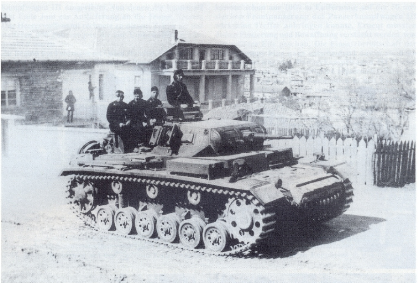
Sehr gute Gesamtansicht eines Panzerkampfwagen III(3,7cm) (Sd.Kfz.141), Ausführung F mit dunkelgrauen Anstrich (RAL 7021). Beachte die Verladeklötze am Bug. Funker, Ladeschütze und Richtschütze haben auf der sogenannten „Fresskiste“ auf dem Motorraum Platz genommen.
