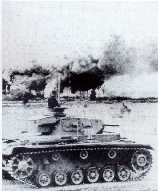
Zu einem weiteren charakteristischen Merkmal der Panzerkampfwagen III gehörte der Gepäckkasten am Turmheck. Das Bild zeigt einen Panzerkampfwagen III(5cm)(Sd.Kfz.141), Ausführung F im Sommer 1942 an der Ostfront.
