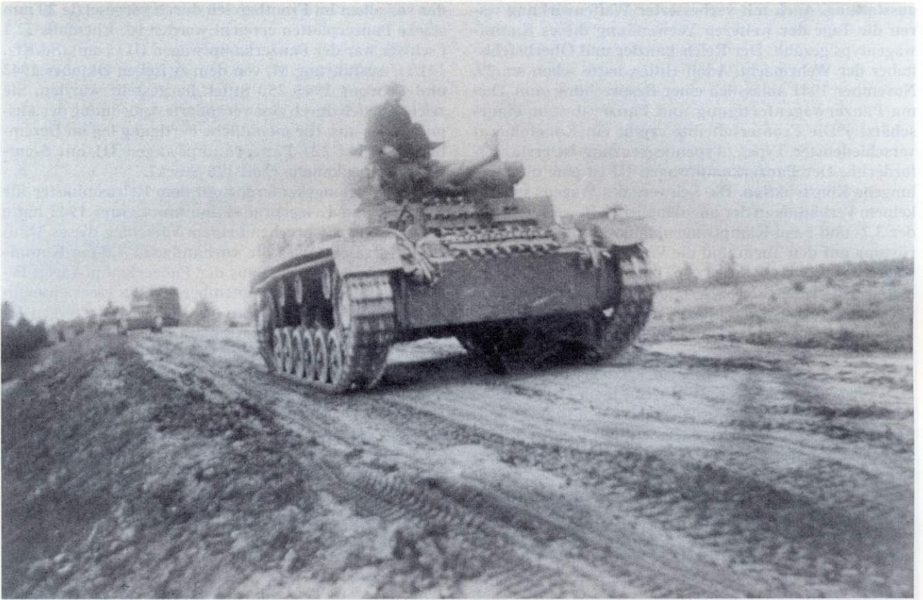
Aufnahme vom Oktober 1941. Der Panzerkampfwagen III(5cm)(Sd.Kfz.141), Ausführung G zeigt die übliche Zusatzpanzerung der Fahrerfront.
