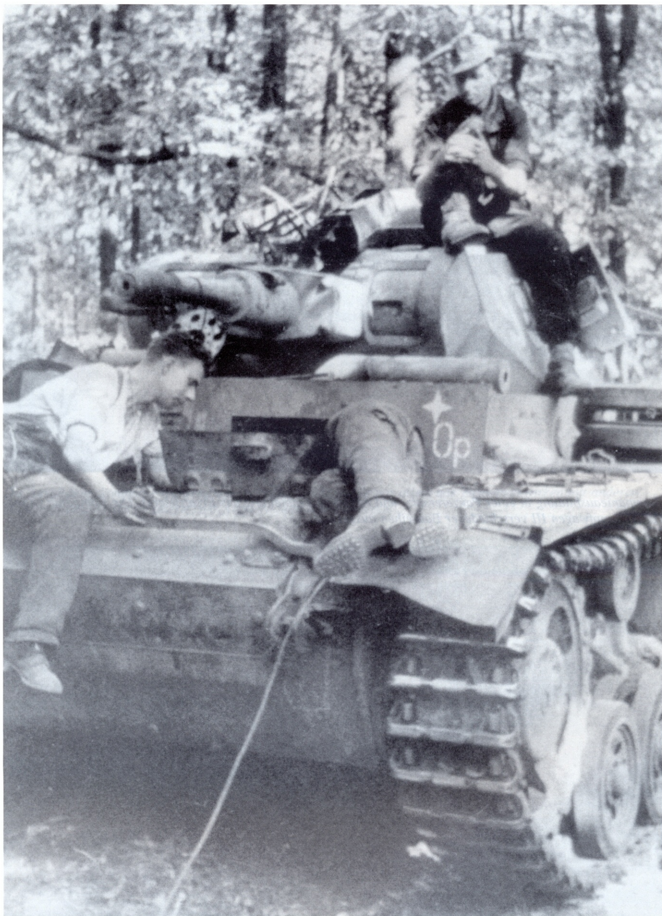
Beim Feldheer ausgesonderte Panzerkampfwagen III älterer Baureihen sind beim Ersatzheer für Ausbildungszwecke genutzt worden. Im Bild ein Panzerkampfwagen III(5cm)(Sd.Kfz.141), Ausführung F. Gut erkennbar die Zusatzpanzerung an der Fahrerfront. Die außenliegende Zusatzpanzerung der Walzenblende ist abgenommen, so daß die alte Waffenblende für die 3,7-cm-Kanone sichtbar ist.
