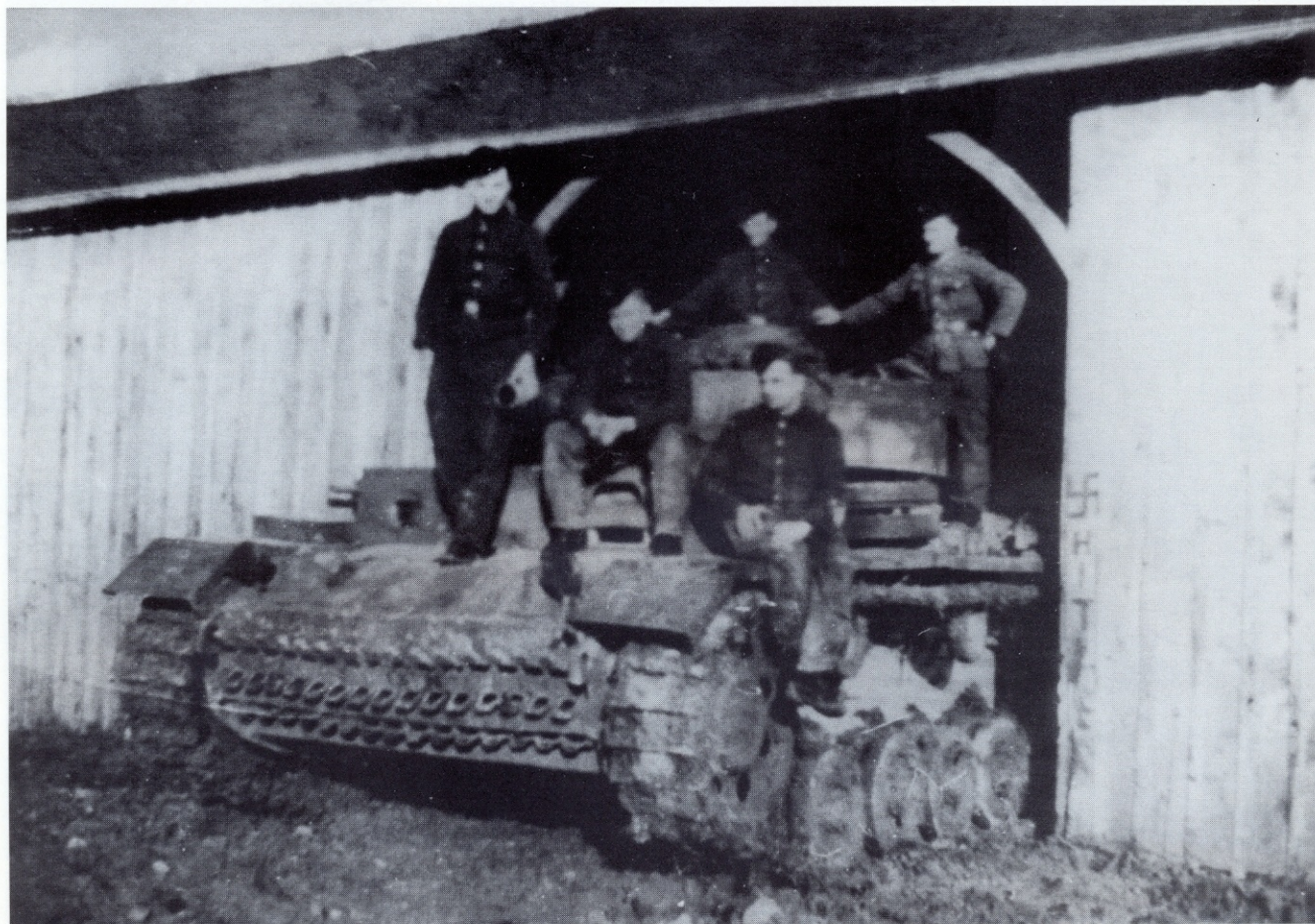
Mit der 7,5-cm-Kampfwagenkanone 37 L/24 waren Kampfwagen der M- und N-Ausführung ausgestattet worden. Das hier gezeigte Fahrzeug ist mit einer Schürzenpanzerung am Turm versehen.
