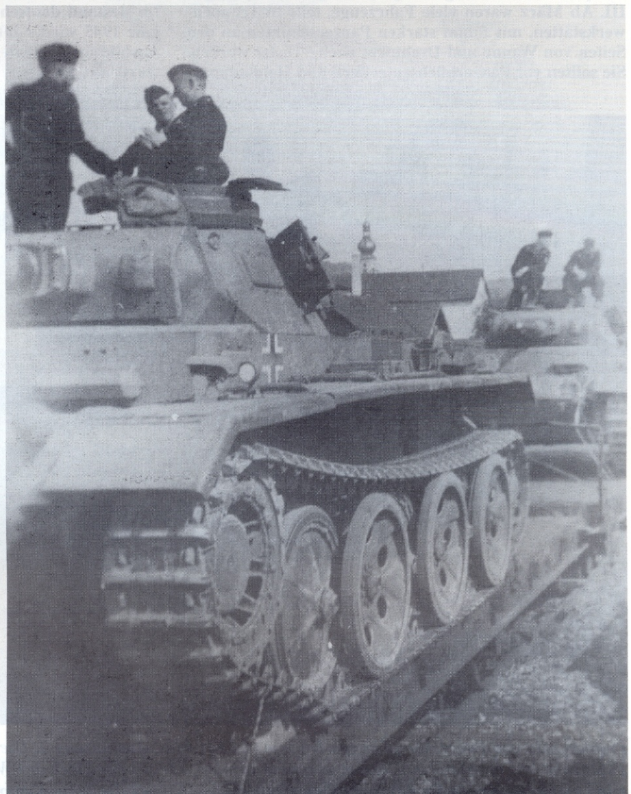
Die in geringer Zahl hergestell- ten Panzerkampfwagen III(5cm)(Sd.Kfz.141), der Baureihen G und H, die mit einem Schachtellaufwerk der Firma Famo ausgestattet worden waren, sind ebenfalls in den Panzerersatz- und Ausbildungsabteilungen im Heimatkriegsgebiet aufge- braucht worden.
