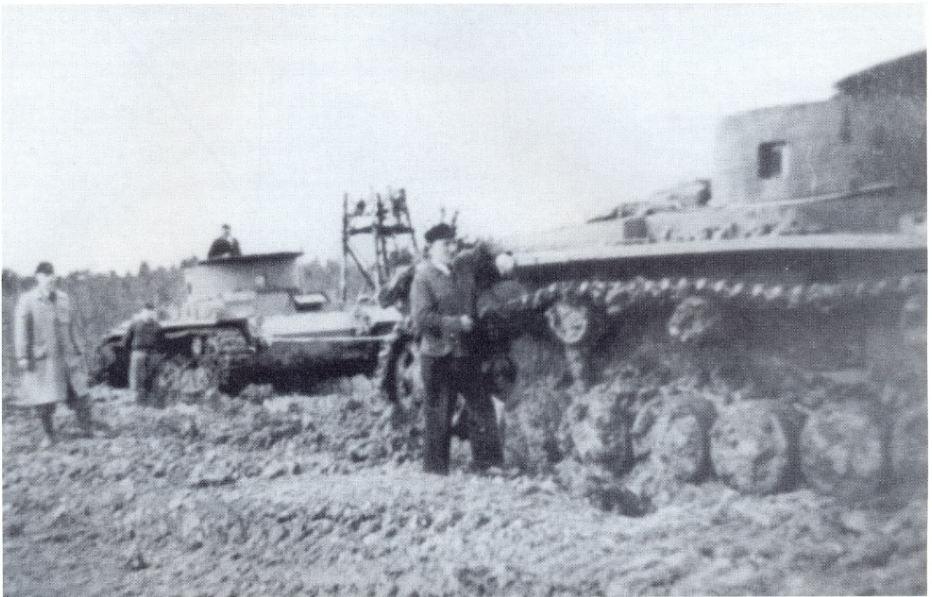
Fahrversuche mit dem Panzerkampfwagen III auf schweren Böden. Für diese Zwecke wurden Betontürme aufgesetzt, deren Gewicht dem der Kanonentürme gleich war.
