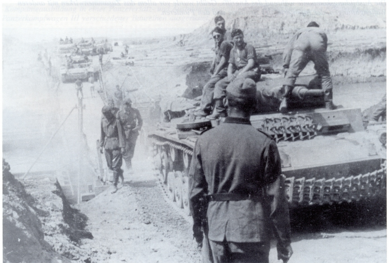
Panzerkampfwagen III(5cm)(Sd.Kfz.141), Ausführung G während der Angriffskämpfe an der Ostfront im Sommer 1941. Der dringende Bedarf an Kampfwagen verzögerte die bereits angelaufene Verstärkung der Panzerung durch Betriebe im Heimatkriegsgebiet.
