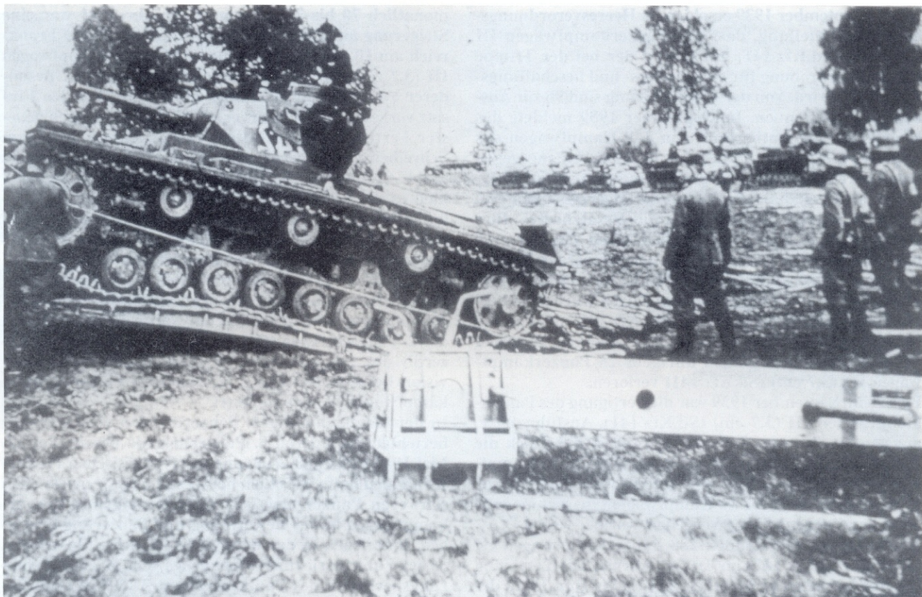
Ein Panzerkampfwagen III(3,7cm)(Sd.Kfz.141), Ausführung D während des Polenfeldzuges. Im Winter 1939/40 wurden alle Panzerkampfwagen III aus den Panzerverbänden des Feldheeres herausgezogen und gegen Fahrzeuge der Serien E und F ersetzt.
