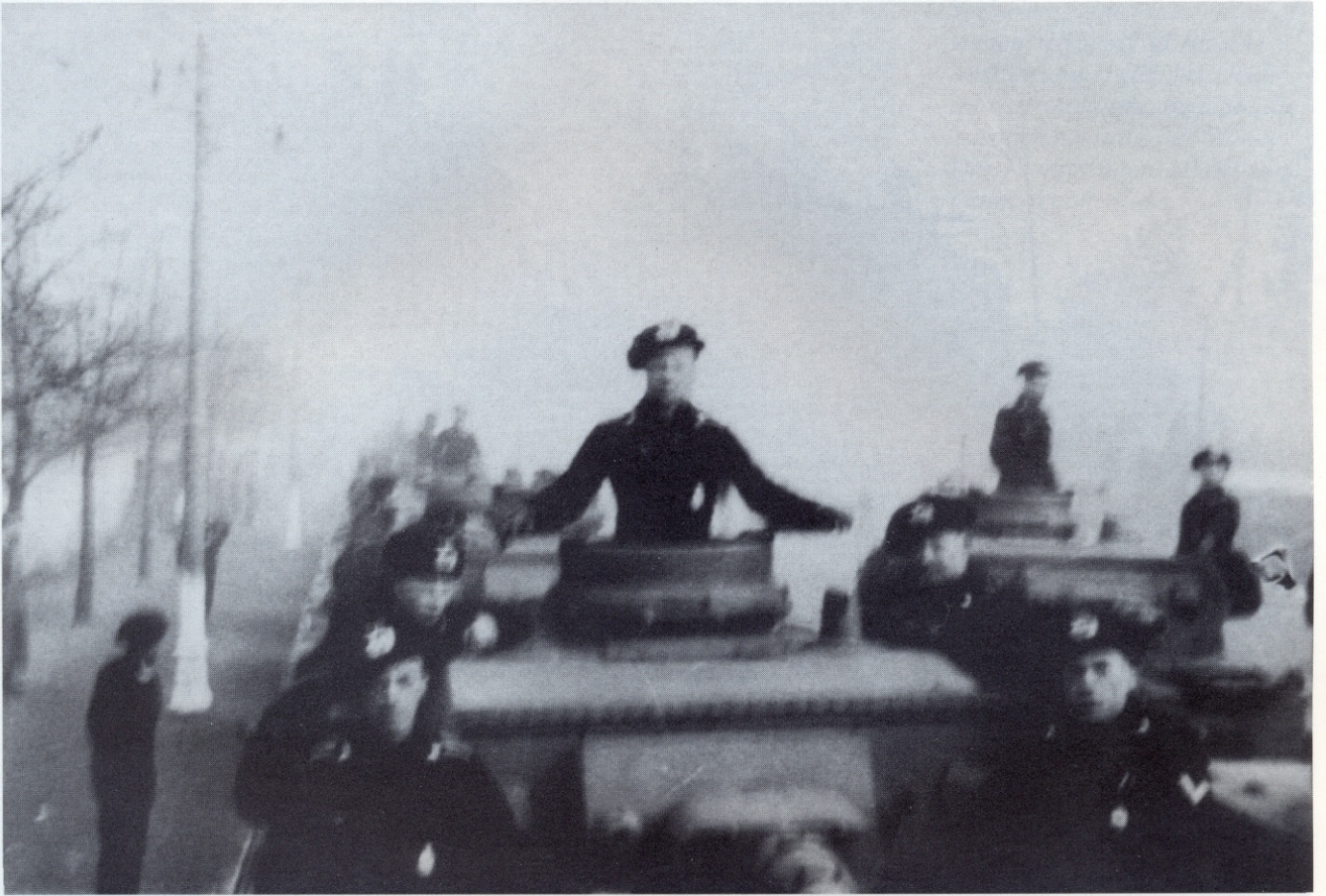
Unter der Bezeichnung Tauchpanzer III sind Panzerkampfwagen III verschiedener Baureihen in Erscheinung getreten. Die Bilder zeigen Fahrzeuge der Baureihen E und F, die zum Tiefwaten hergerichtet worden sind.
