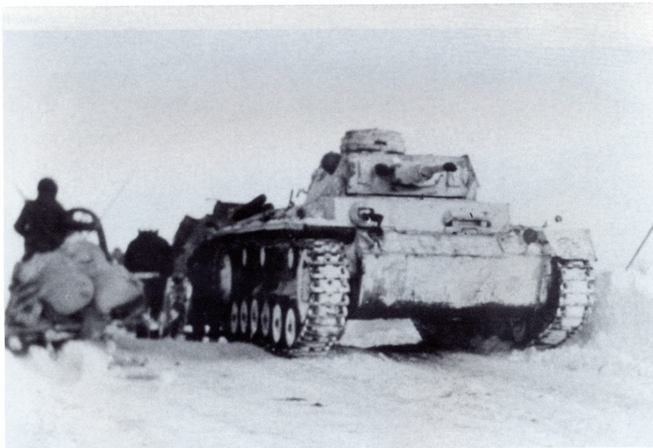
Während der schweren Abwehrkämpfe an der Ostfront, im Winter 1941/42 ist dieses Bild entstanden. Es zeigt den neuen Panzerkampfwagen III(5cm)(Sd.Kfz.141), Ausführung J mit der auf 50 mm verstärkten Grundpanzerung.
