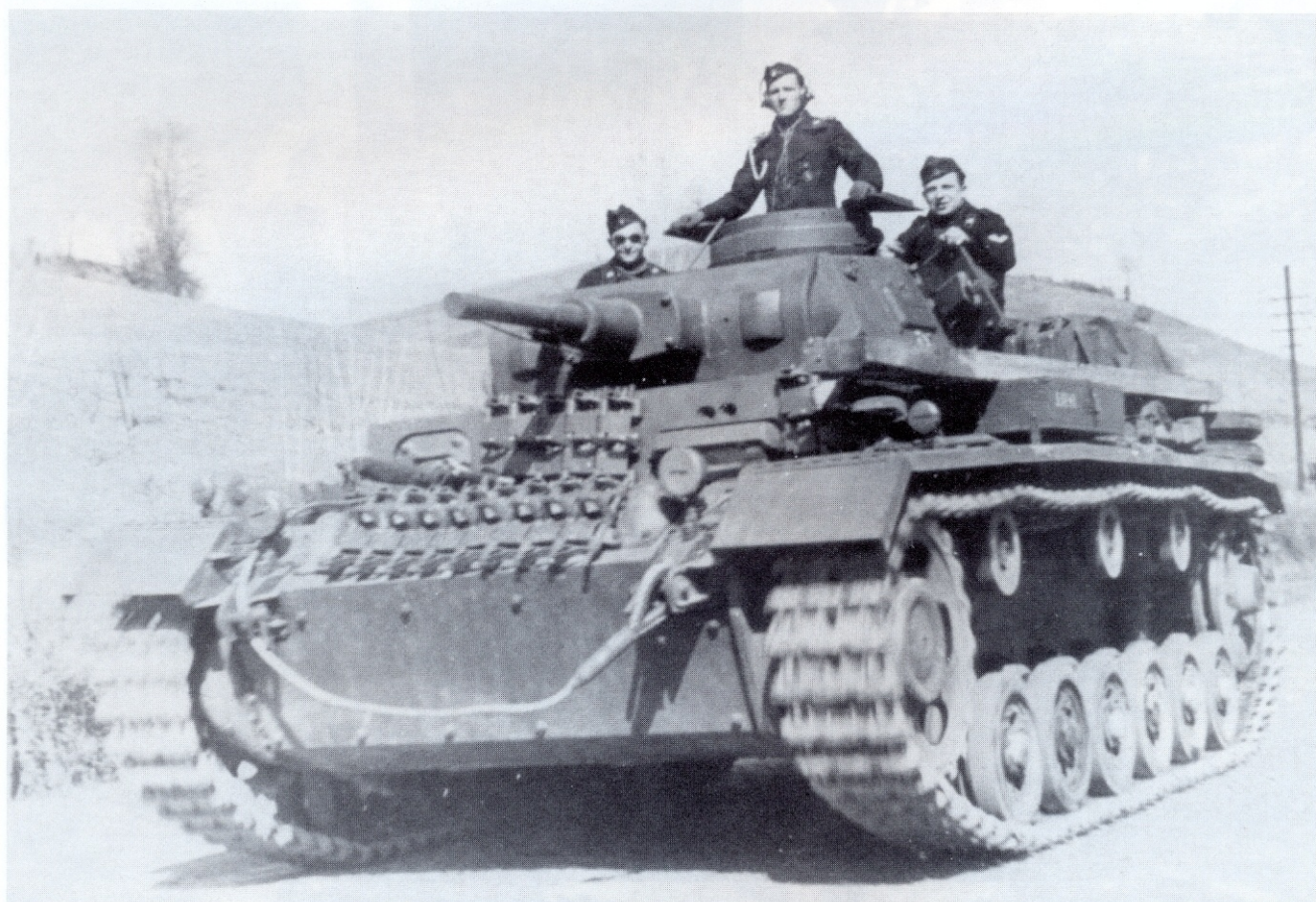
Ein Panzerkampfwagen III(5cm)(Sd.Kfz.141), Ausführung H mit 30 mm Zusatzpanzerung vor der Fahrerfront.
