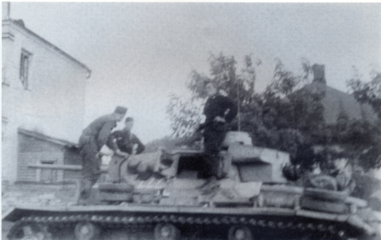
Panzerkampfwagen III(5cm)(Sd.Kfz.141/1) der Ausführung L gelangten noch im Spätsommer 1942 zur Ausstattung der Panzerabteilungen an die Ostfront. Charakteristisch ist der Vorpanzer an Wanne und Turm.
