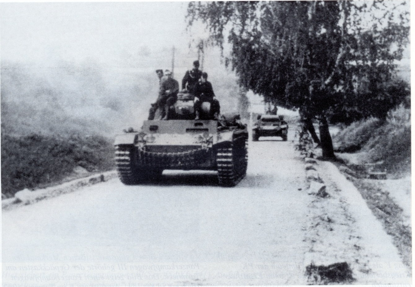
Gut erkennbar ist bei diesem Panzerkampfwagen III(5cm)(Sd.Kfz.141), Ausführung H die Zusatzpanzerung der Wanne.
