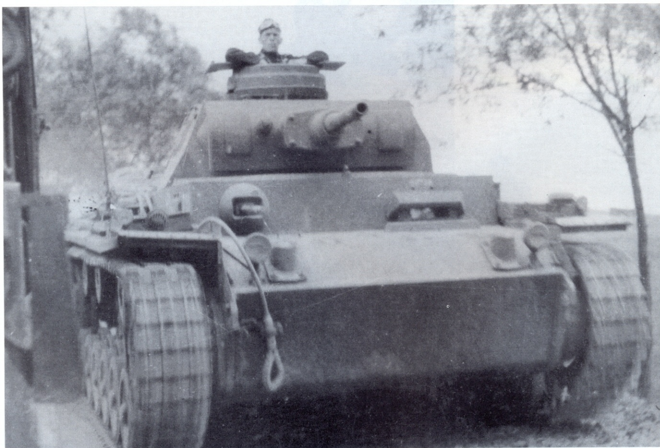
Frontansicht des Panzerkampfwagen III(5cm)(Sd.Kfz.141), Ausführung J. Die Bugpanzerung der Wannen- und Turmfront war nunmehr auf 50 mm verstärkt worden, ebenso das Heck der Wanne. Während der Serienfertigung wurde an der Stelle der 5-cm-Kampfwagenkanone L/42 die 5-cm-Kampfwagenkanone 39 L/60 eingeführt.
