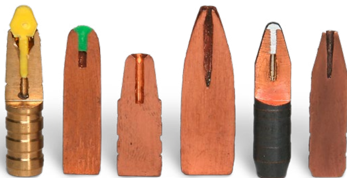
Homogene bleifreie Geschosse haben keinen weichen Kern, was zu anderen innenballistischen Verhältnissen führt
