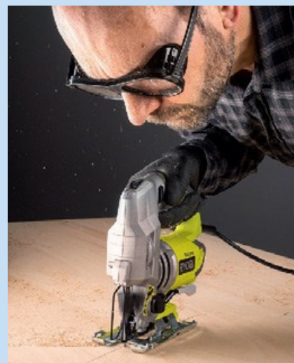
Schutzbrille hilft. Die Ryobi pustet dem Nutzer einen Luftstrom ins Gesicht.
