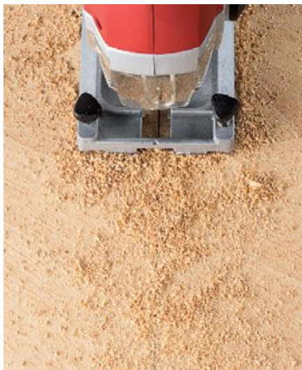
Ohne Puste. Bei der Einhell TE-JS 18 LI ist die angezeichnete Schnittlinie kaum erkennbar, da die Späneblasfunktion fehlt.
