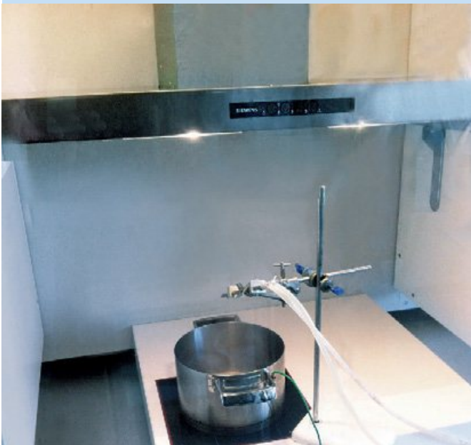
Fettig. Die Prüfer tropfen Öl und Wasser in einen heißen Topf und messen, wie viel Fett der Filter auffängt.
