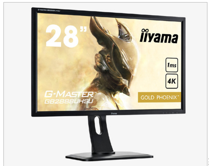
UHD-Displays mit Adaptive Sync, hier Iiyamas neuer Prolite GB2888UHSU-B1, werden langsam erschwinglich. Mit der Bandbreite von DP 1.2 ist aber bei 60 Hertz Schluss.
