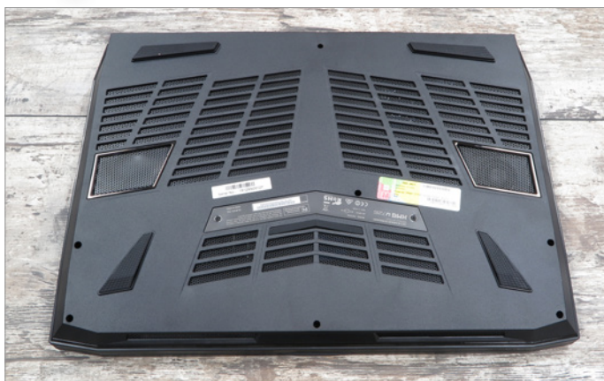
Bei Schenkers High-End-Notebook U726 sorgen große Luftauslässe im Boden dafür, dass der GTX 980 (ohne M) nebst Skylake-CPU nicht zu warm wird.
