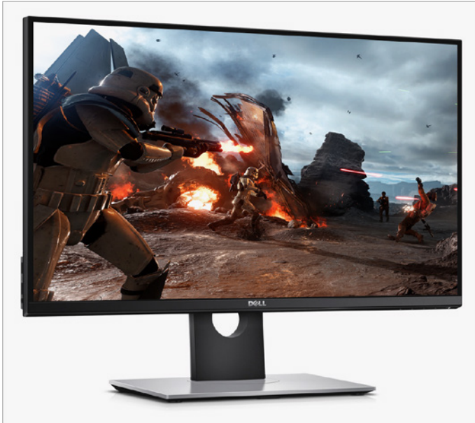
Das Testgerät für den Chefredakteur: Das Dell S2716DG kommt mit TN-Panel, bis zu 144 Hz unter WQHD und G-Sync im Handgepäck.
