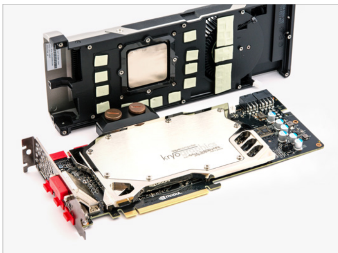
Bei der Referenzplatine ist die Auswahl an Kühlern deutlich größer. Wir montieren einen vernickelten Kühlblock aus dem Hause AquaComputer.
