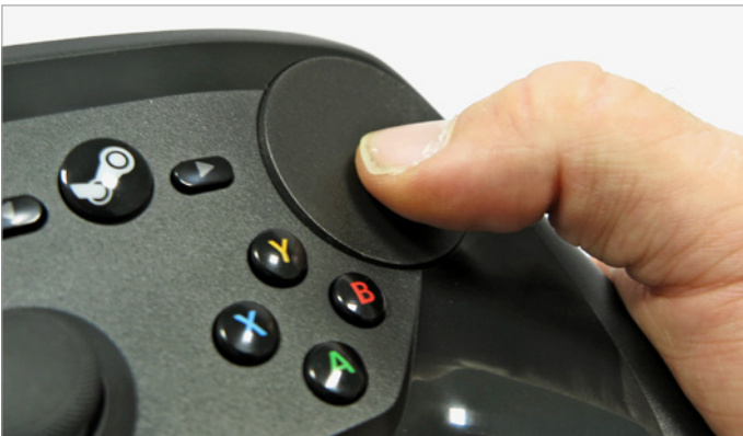
Force Feedback à la Valve: Anstatt typischer Vibrationen setzt der Steam Controller auf subtilere Pulseffekte, ermöglicht durch Linearmotoren unter den Trackpads.
