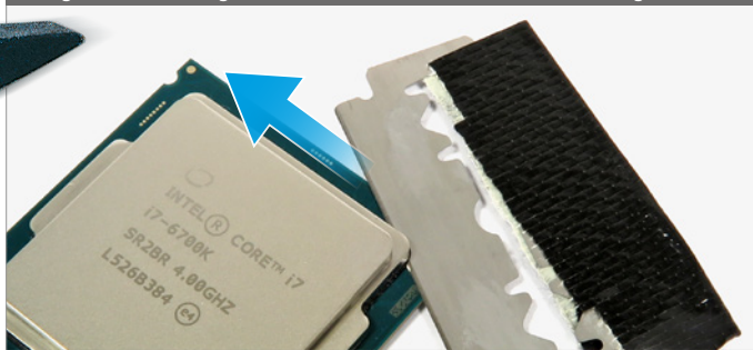
Geringe Krafteinwirkung aber Gefahr von Schnittfehlern: Die Rasierklingen-Methode
