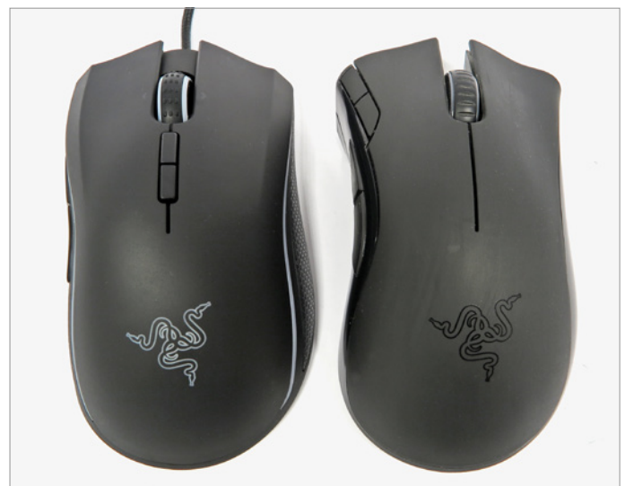
Neben der neuen Technik (RGB-Beleuchtung und 16.000-Dpi-Sensor) wertet Razer die Mamba TE mit großflächiger Gummierung und geänderten Tastenpositionen ergonomisch auf.
