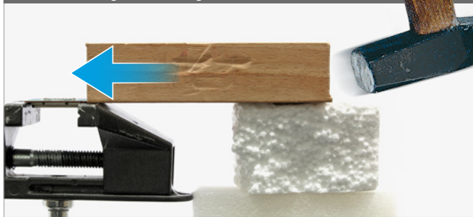
Ideale Kraftrichtung, aber schwierig zu dosieren: Die Hammer-Methode
