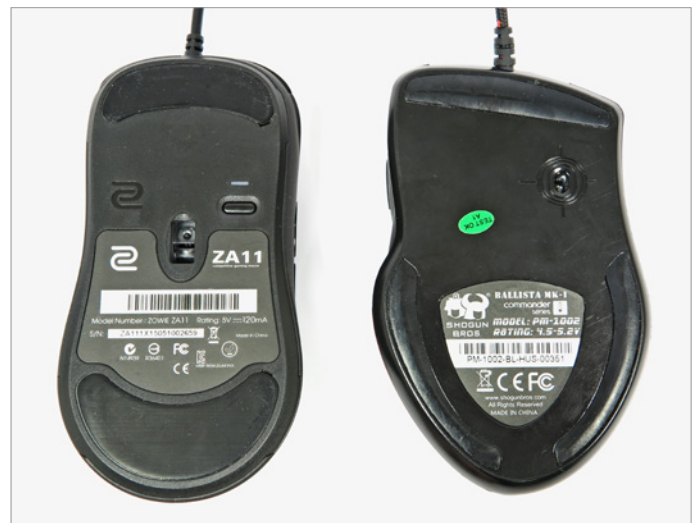
Ein Blick auf die Unterseite der Shogun Bros. Ballista MK-I zeigt die ungewöhnliche Sensorposition. Auch bei der ZA11 hält Zowie an der Dpi-Umschaltung am Mausboden fest.
