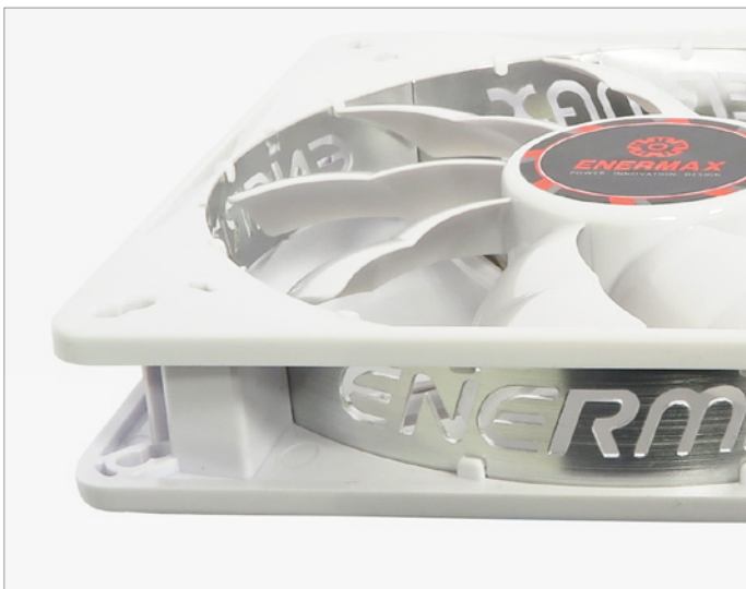
Auch durch die Rahmenöffnungen strömt Luft in den Cluster Advance. Bei saugender Montage hinter einem Radiator trägt dieser Nebenstrom nicht zur Kühlung bei.
