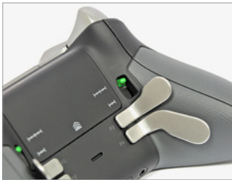
Die vier Pedaltasten (Unterseite) sind das nützliche Alleinstellungsmerkmal des Elite. Razers Wildcat bietet dagegen nur zwei Pedal- und ergonomisch platzierte Multifunktions-Trigger.
