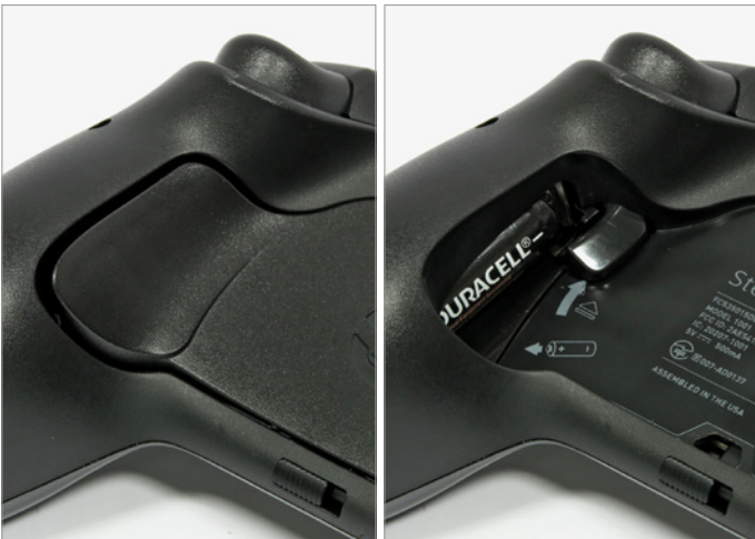
Der Steam Controller wird mit zwei AA-Batterien betrieben, die Abdeckung dient zugleich als rückseitige linke und rechte Griffaste.
