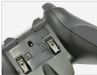
Die vier Pedaltasten (Unterseite) sind das nützliche Alleinstellungsmerkmal des Elite. Razers Wildcat bietet dagegen nur zwei Pedal- und ergonomisch platzierte Multifunktions-Trigger.
