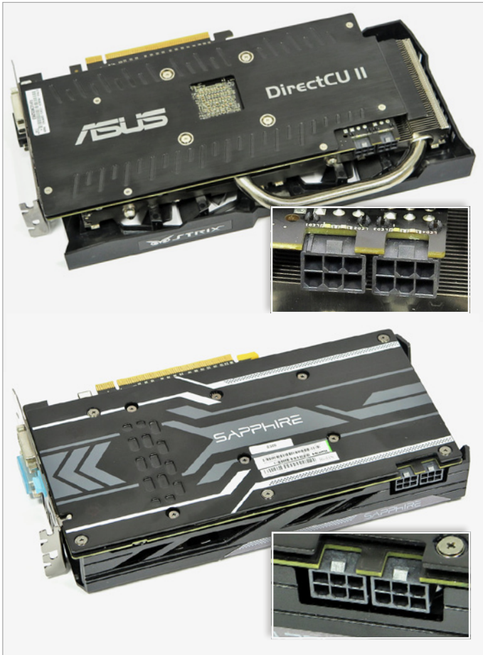
Zwei verschiedene Designs mit Gemeinsamkeiten: Neben einer Backplate tragen beide Karten zwei sechspolige, sinnvoll umgedrehte Strombuchsen.
