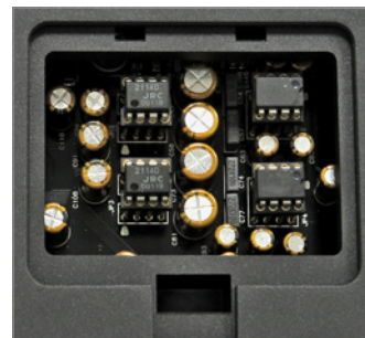
Die Op-Amps können auf Wunsch gewechselt werden. Die Standardkonfiguration klingt detailliert und natürlich.
