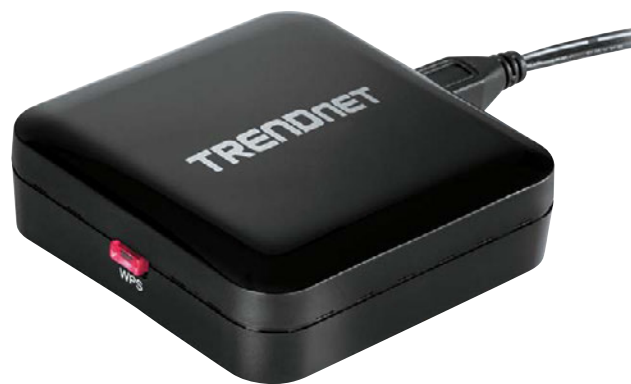
... aber: Der TEW-830AP hat nur eine Antenne und überträgt deshalb langsamer.
