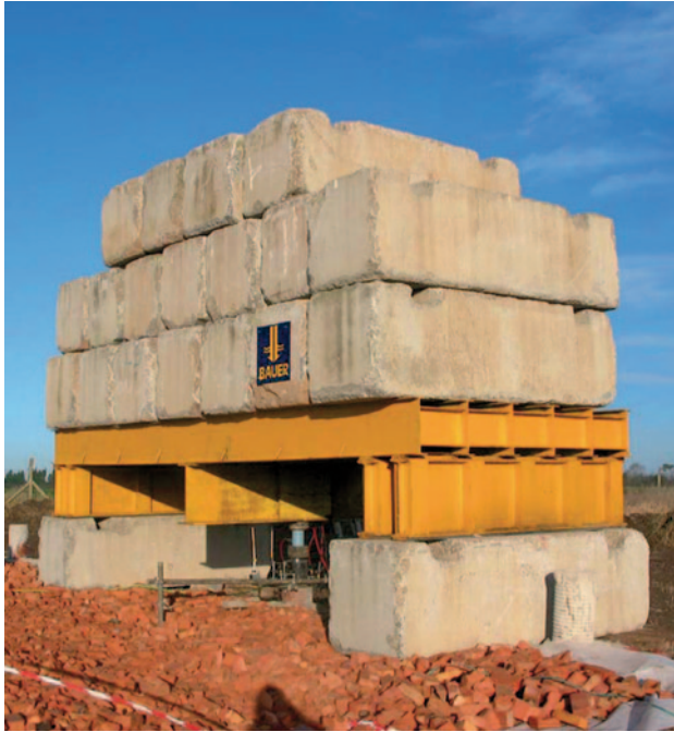
Abb. 3.2 Statischer Pfahltest. (Bild: Fa. Bauer)
